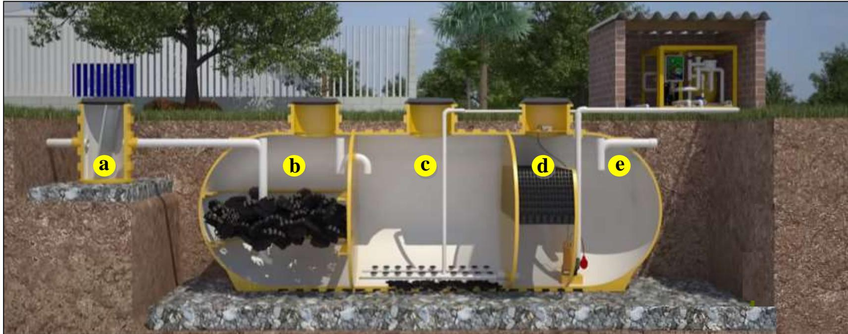
Figura N.º 20: Sistema de Planta de Tratamiento de Aguas Residuales (PTAR).
