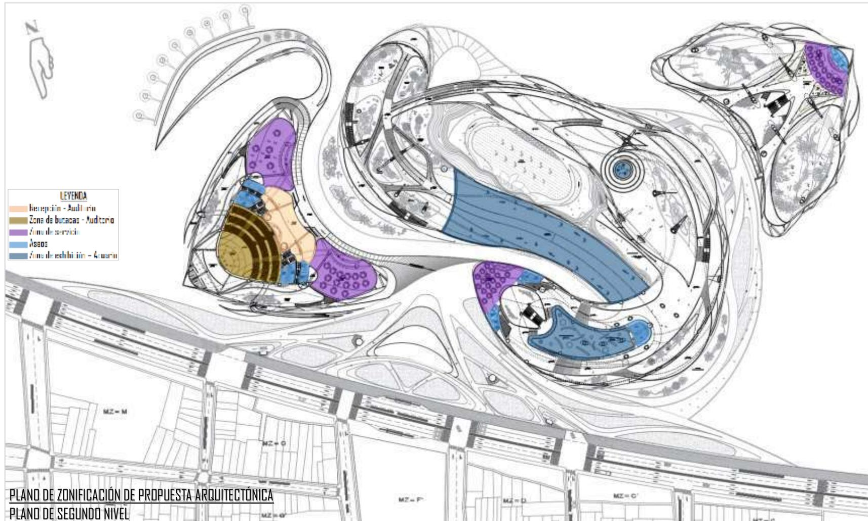
Figura N.º 103: Plano de zonificación del segundo nivel.
