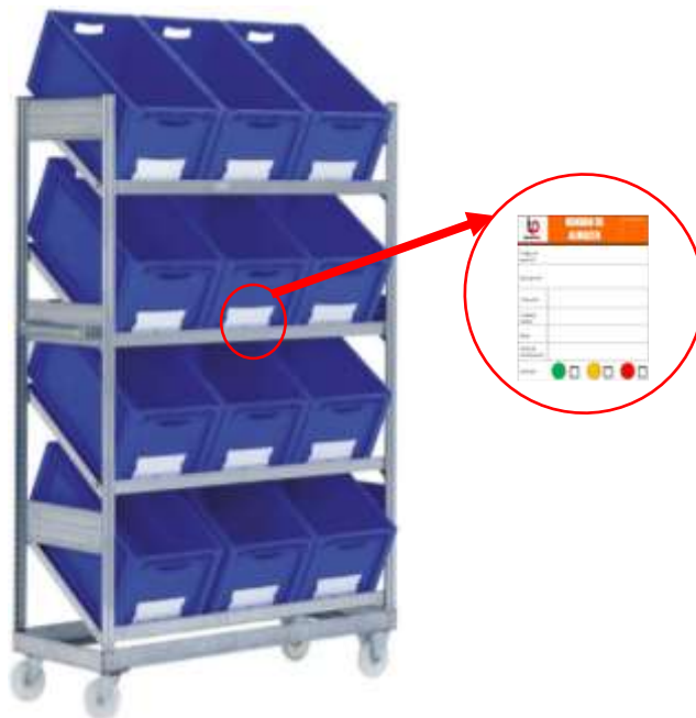
Figura 5. Tarjetas Kanban en estantes de almacén.
