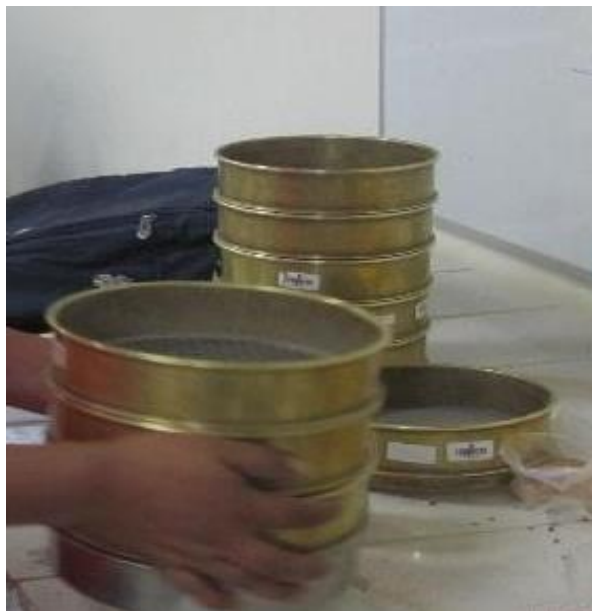
Figura 35. Tamices para realizar ensayo de granulometría.
