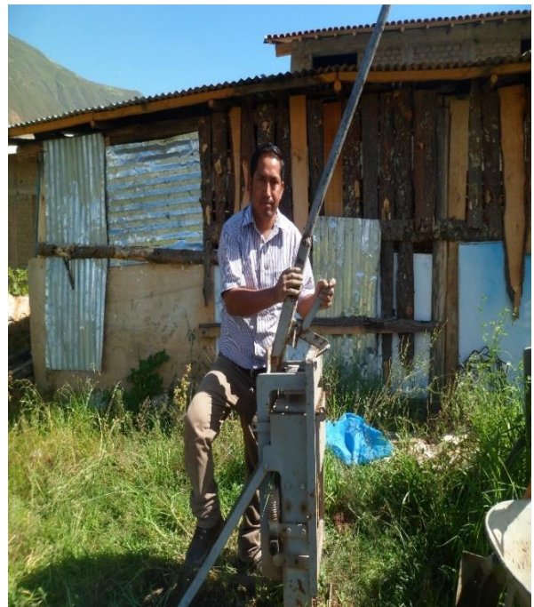
Figura 18. Maquina cinva ram para Compactación del adobe.
