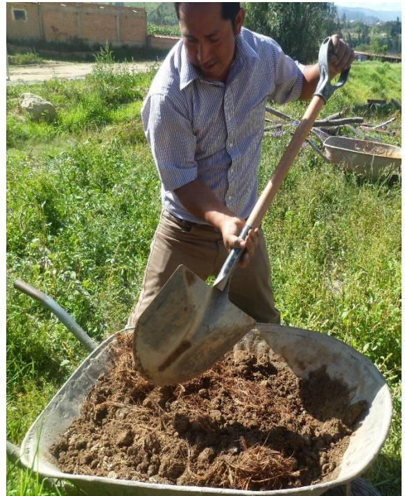
Figura 20. mesclado de suelo con la Fibra de maguey.
