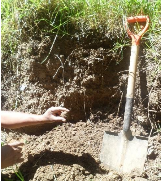
Figura 05. Asiendo las bolitas para La prueba de la resistencia.
