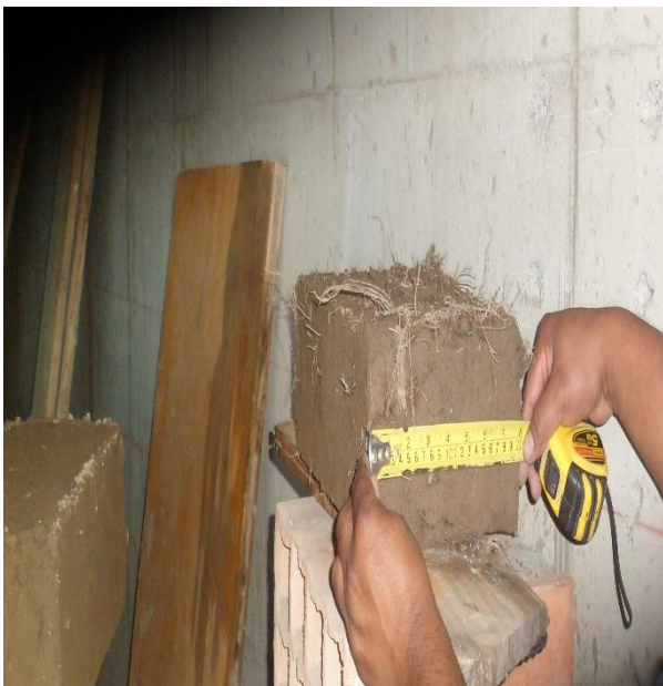
Figura 25. medición del adobe elaborado.
