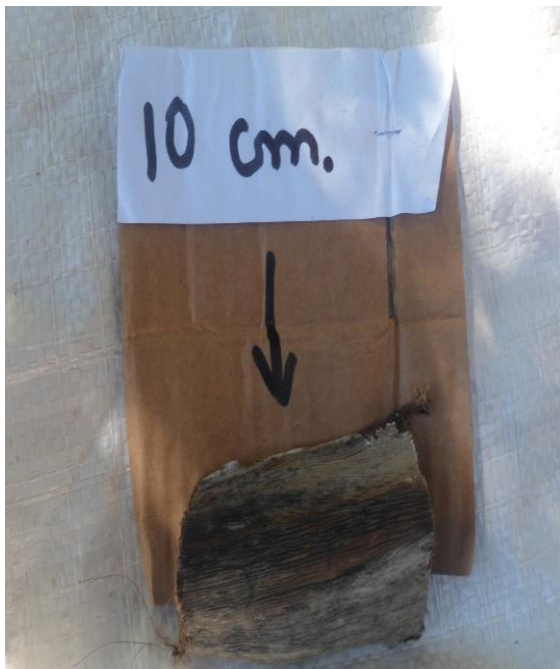
Figura 11. medida a utilizar en la Elaboración del adobe.
