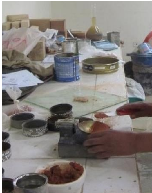
Figura 37. realizando límite de En la copa de casa grande.
