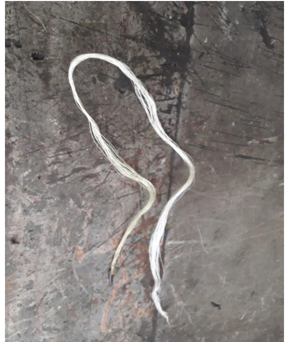
Figura 28. fibra de maguey para el Para el ensayo de tracción.
