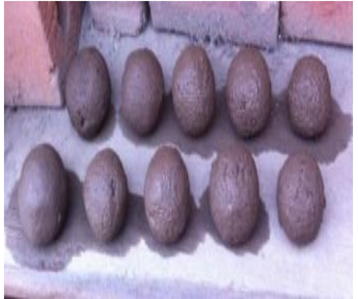
Figura 06. Las bolitas para la prueba de la De resistencia.
