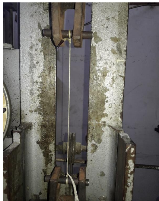
Figura 30. tracción de la fibra de maguey.
