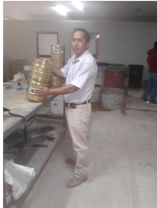
Figura 34. realizando ensayo de Granulometria por tamizado.
