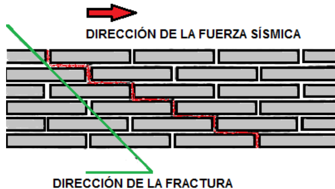
Figura 2 Grietas diagonales formados en sismos
