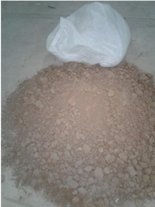
Figura 33. suelo para ensayo de Granulometria.
