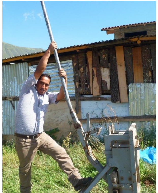
Figura 22. compactación con la Maquina cinva ram.
