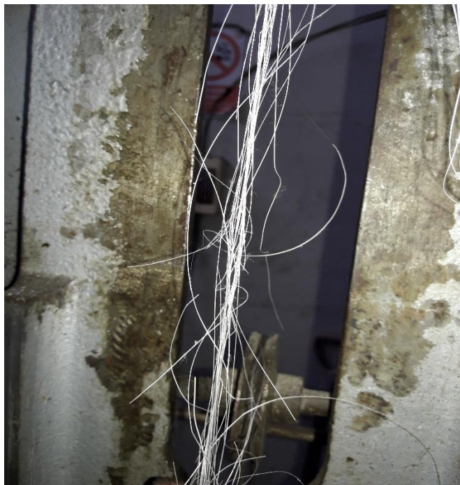
Figura 32. Rotura de la fibra de maguey.
