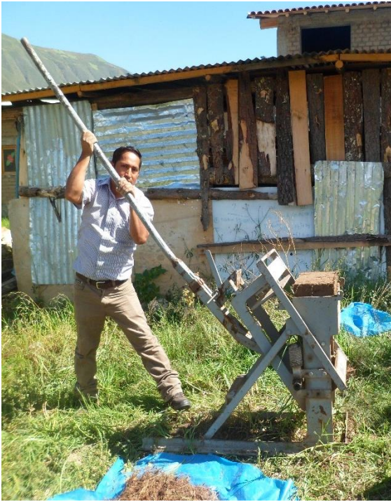
Figura 23. Extrayendo el adobe de la Maquina cinva ram.
