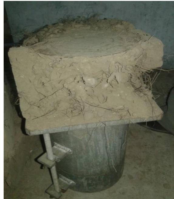
Figura 41. adobe despues del de compresion.
