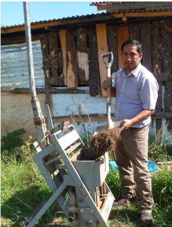
Figura 21. llenado de la mezcla a la Maquina cinva ram.
