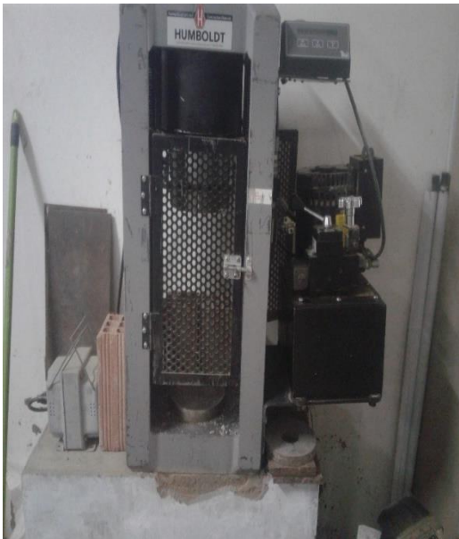
Figura 38. máquina de compresion De la usp.
