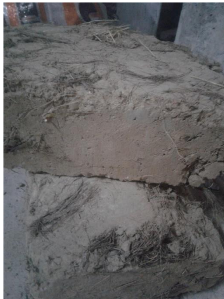
Figura 39. adobes secos para realizar Ensayo de compresion
