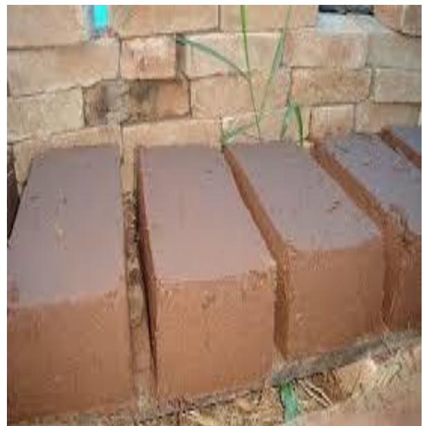
Figura 26. adobe en proceso de secado.
