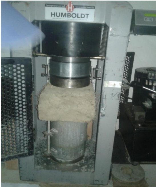
Figura 40. Realizando ensayo de compresion ensayo del adobe con fibra de maguey.
