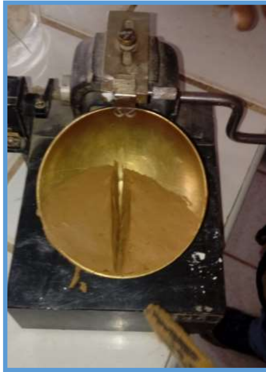
Figura 44. Realizando los límites líquido y plástico.
