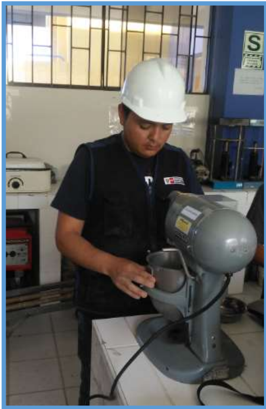
Figura 45. Preparación de la mezcla para el mortero Patrón y Experimental.
