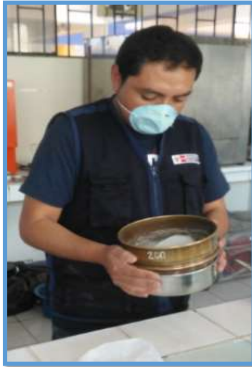
Figura 41. Pasado por de la malla N°200 las cenizas de concha de chanque y arcilla.
