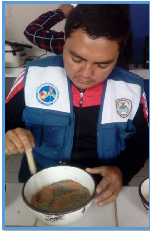
Figura 43. Combinación de la Cenizas de Concha de Chanque, Arcilla y Cemento
