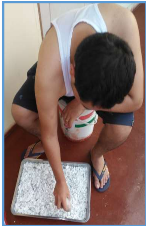
Figura 40. Trituración de la Concha de Chanque
