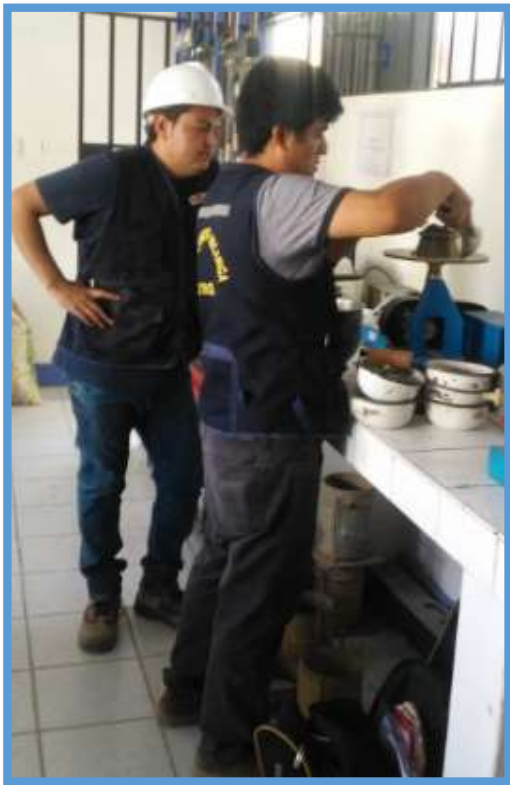
Figura 42: Fluidez del mortero patrón y experimental en el Fluidímetro electrónico.
