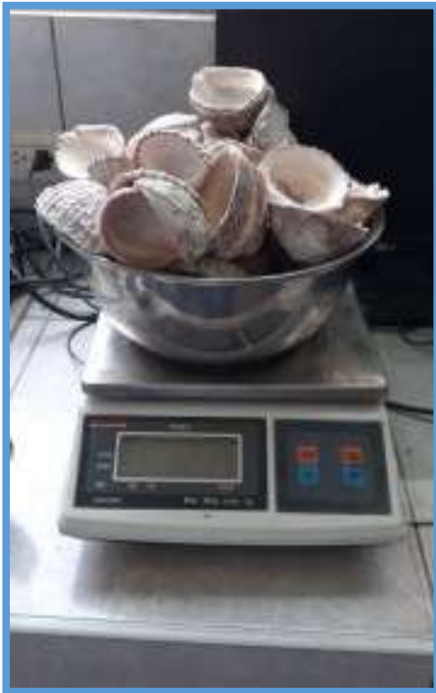
Figura 38. Pesado de la concha de chanque después del secado en el horno
