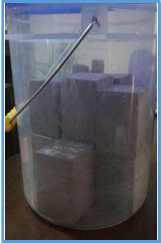
Figura 47. Curado de morteros patrones y experimentales
