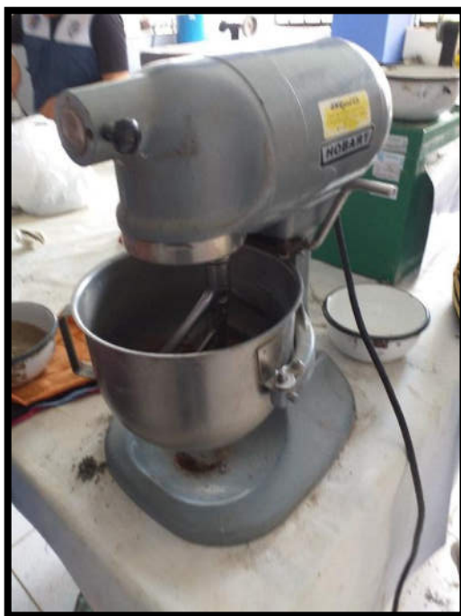
Imagen 10. Mezclado de arena fina, cemento y ceniza de molle
