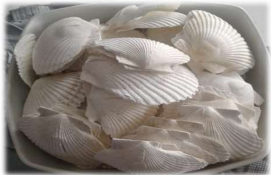
Foto 13: Se retira el material de la mufla ya activado térmicamente para luego machacarlo y se pueda volver polvo.
