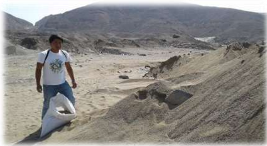
Foto 14: se recolecta la arena de la cantera besique lo necesario para poder gradar y realizar los especímenes de mortero.
