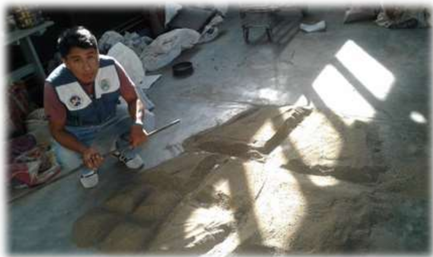
Foto 14: se recolecta la arena de la cantera besique lo necesario para poder gradar y realizar los especímenes de mortero.
