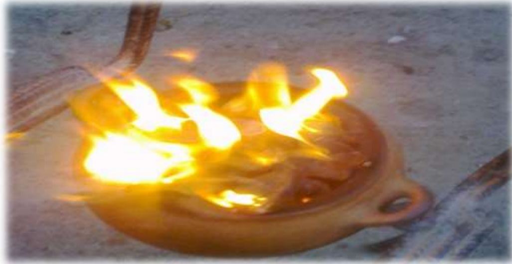
Foto 8: se realiza el pre calcinado de cáscara de arroz para luego ser activado térmicamente de acuerdo al análisis térmico diferencial.
