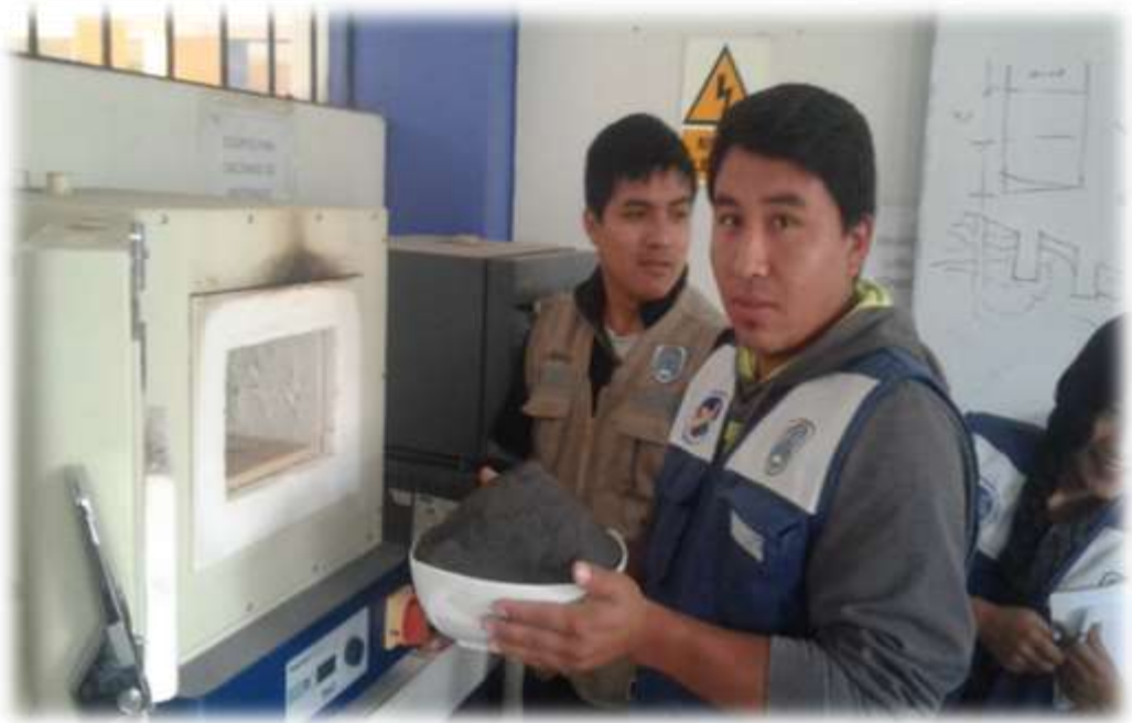
Foto 9: Se introduce la ceniza de cáscara de arroz pre calcinado para ser activado térmicamente
