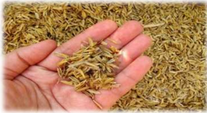
Foto 1: se muestra la cáscara de arroz luego de ser limpiado de la maleza para luego ser pre calcinado
