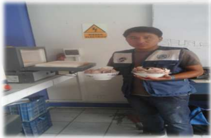
Foto 12: Luego se procede a colocara el material a ma mufla para ser activadpo térmicamente de acuerdo al ATD.
