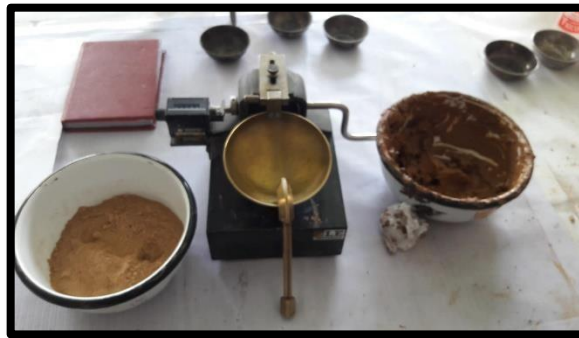
Figura 38 Límite líquido con la copa de Casagrande
