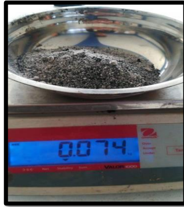
Figura 44 En esta imagen apreciamos el peso de la arcilla para realizar el ATD en la UNT y Fluorescencia en la UNMSM
