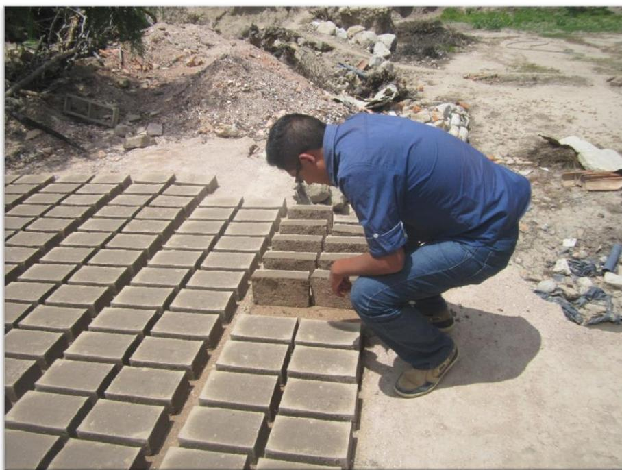
Foto N°07: Se muestra el proceso de secado y volteo de las unidades de albañilería para uniformizar el proceso.
