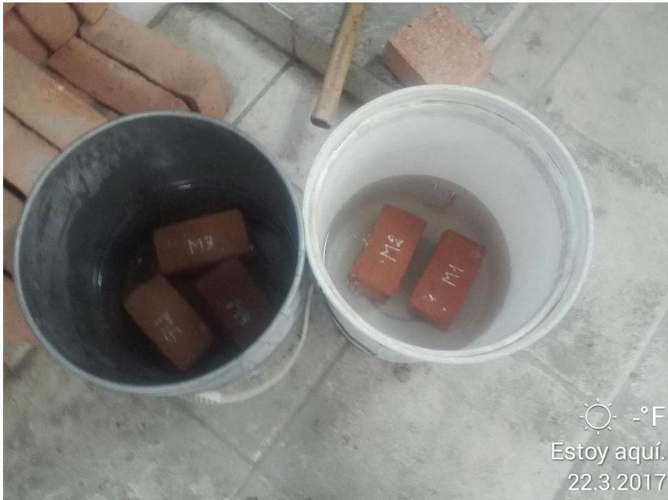
Foto N°17: En la imagen se muestra la saturación de las muestras, en el ensayo de absorción en agua fría.
