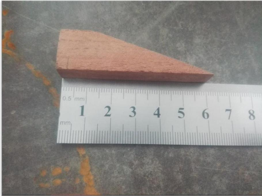
Foto N°13: En la imagen se muestra el modelo de la cuña de madera para los ensayos de alabeo
