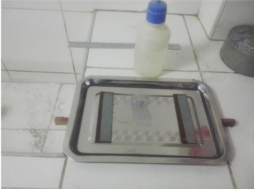
Foto N°19: En la imagen se muestra el recipiente de metal con agua, bases de aluminio para los ensayos de succión.
