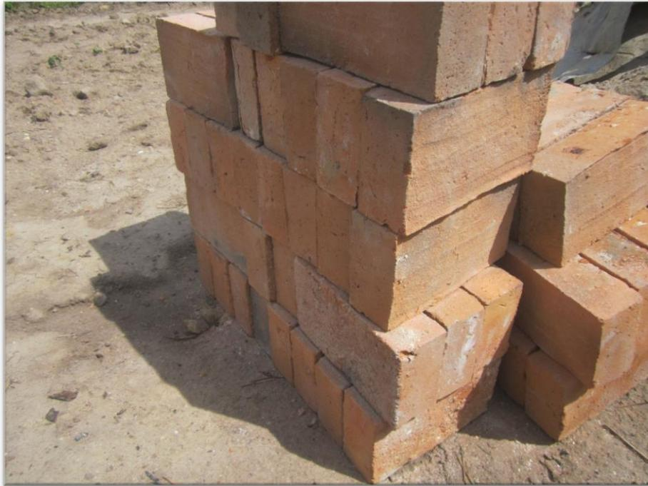
Foto N°11: Se muestra las unidades de albañilería luego de su cocción en el horno, listo para su transporte al laboratorio.
