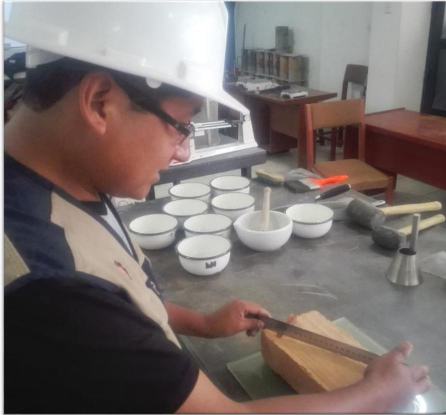
Foto N°15: En la imagen se muestra la toma de medidas de la concavidad del ladrillo en el ensayo de alabeo.
