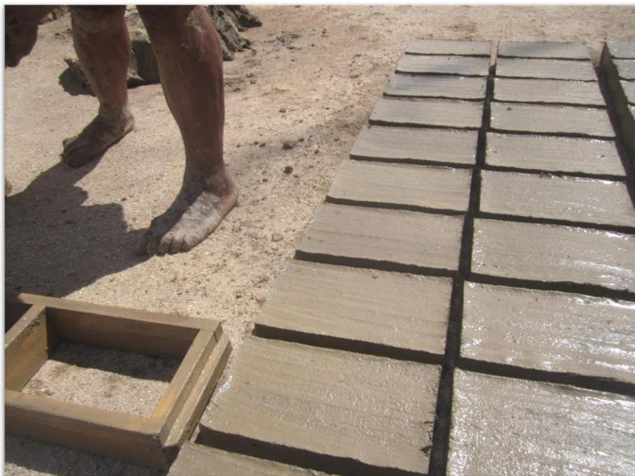
Foto N°06: Se muestra el proceso de moldeado de las unidades de albañilería con un molde de madera, de manera artesanal.
