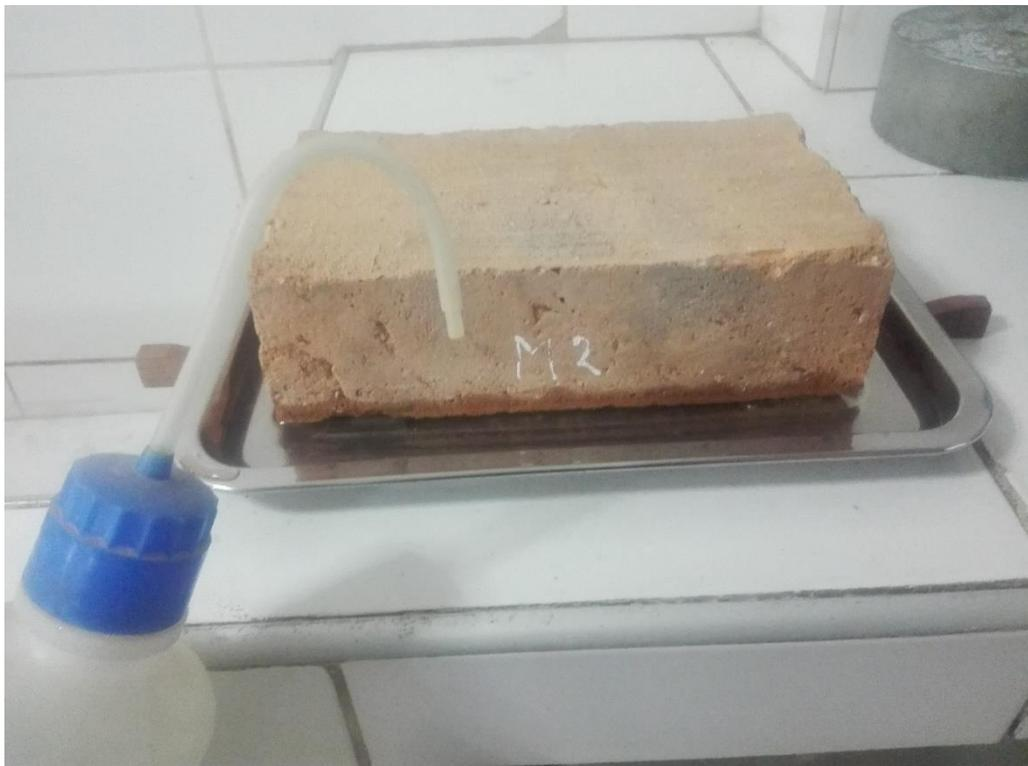
Foto N°20: En la imagen se muestra la realización de la prueba de succión del ladrillo al entrar en contacto con el agua.
