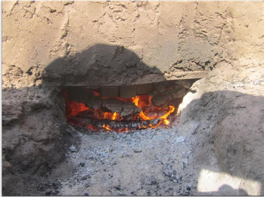
Foto N°09: Se muestra el proceso de cocción de 50 unidades de ladrillo en un horno artesanal.
