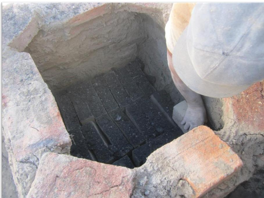
Foto N°08: Se muestra el proceso de apilamiento de 50 unidades de albañilería en el horno artesanal para su cocción.
