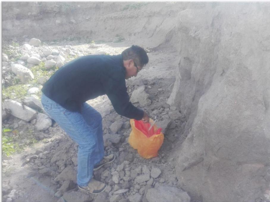
Foto N°04: Toma de muestras del material de la cantera de Yuracoto para ensayos de laboratorio.
