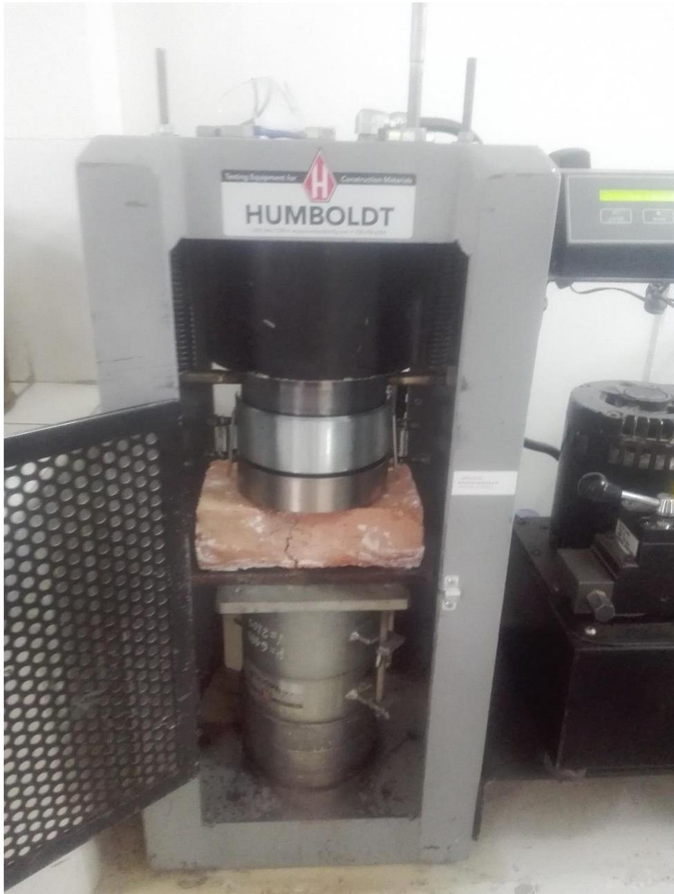
Foto N°22: En la imagen se muestra el ladrillo sometido al esfuerzo de flexión, con una capa de yeso tipo cinta en su base según la norma.
