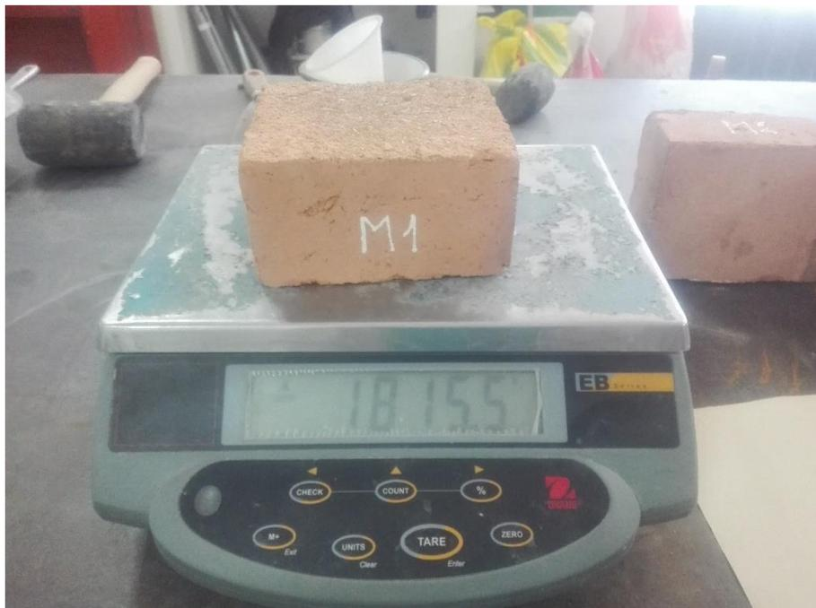
Foto N°16: En la imagen se muestra el peso de una media mitad del ladrillo.
