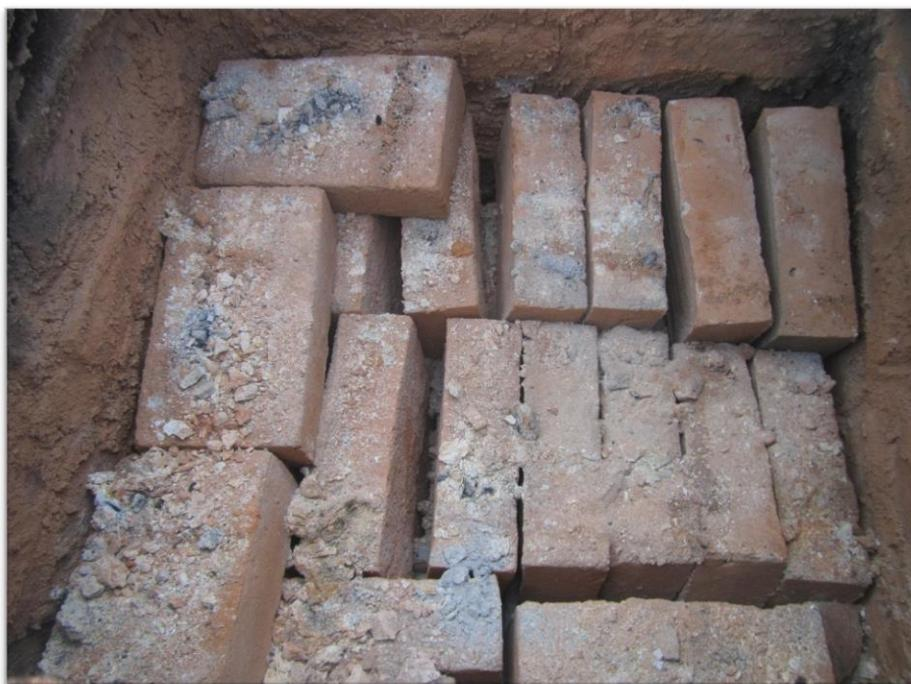
Foto N°10: Se muestra las unidades de albañilería luego de su cocción, en el proceso de enfriamiento para ser retirados del horno.
