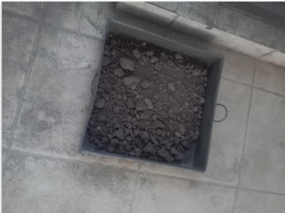
Foto N°12: Se muestra el material extraído de la cantera de Yuracoto, para realizar ensayo de granulometría y límites de consistencia.
