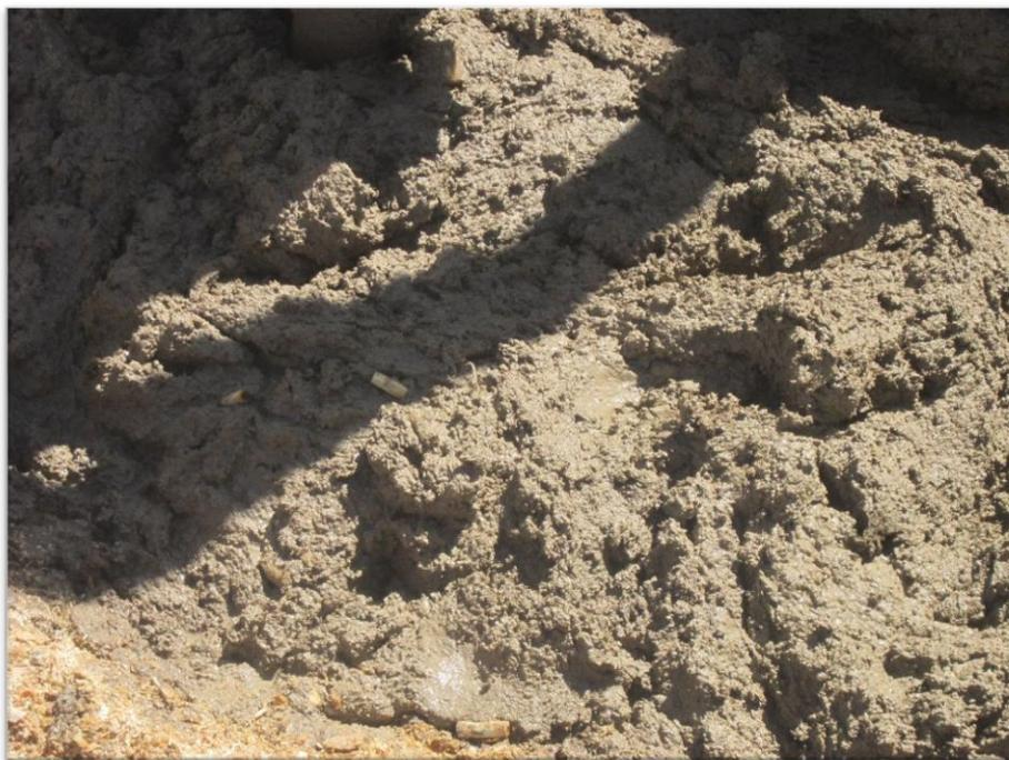
Foto N°05: Se muestra el proceso de amasado con la incorporación de los filtros de cigarro a la mezcla.
