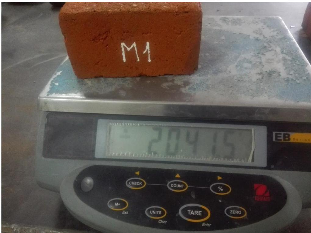
Foto N°18: En la imagen se muestra el peso de la muestra saturada, previamente secada con un trapo superficialmente.
