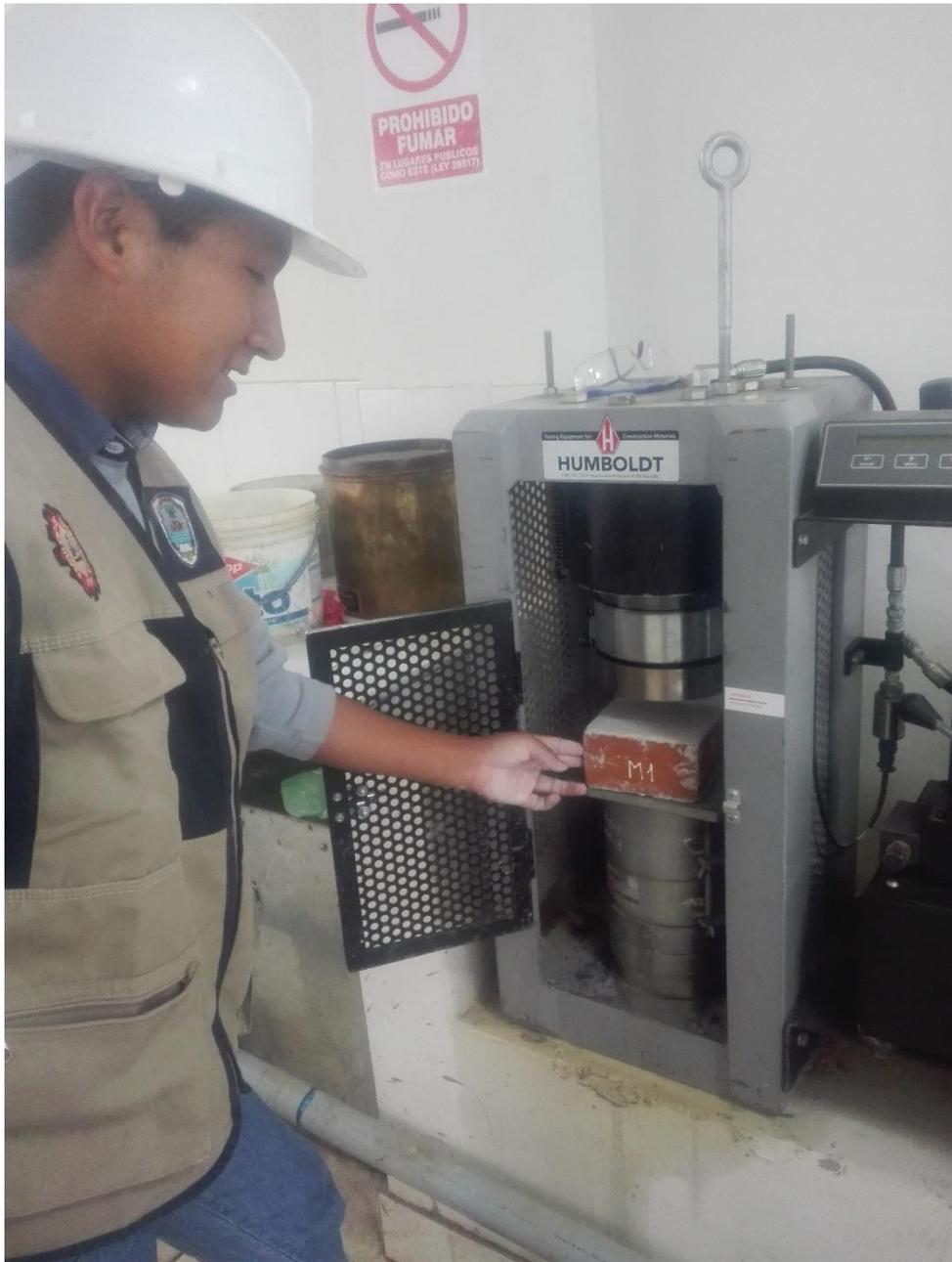
Foto N°21: En la imagen se muestra la media mitad del ladrillo en la máquina de compresión, previa aplicación de una capa de yeso según norma.
