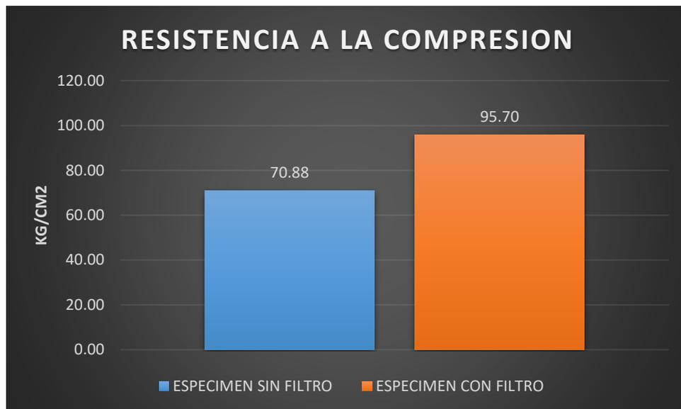
Figura 13: Valores promedio de resistencia a la compresión.
