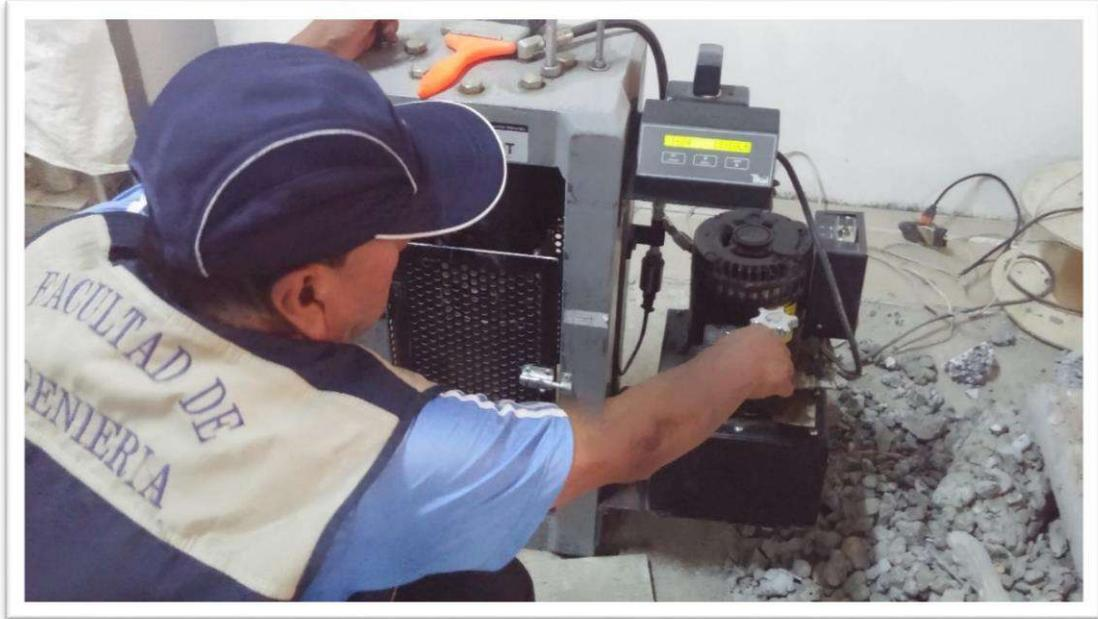
*Figura N° 70: Ensayo de compresión realizado en el laboratorio de mecánica de suelos de la universidad san pedro*
