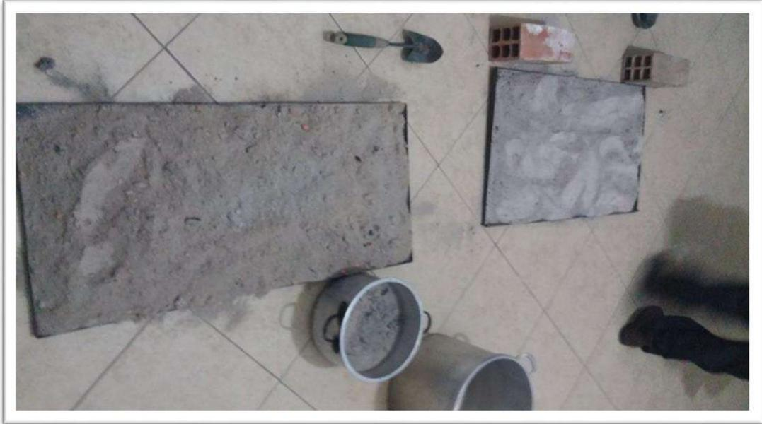
**Figura N° 62:** ceniza de retama previamente quemada en el horno, se puso en fuentes de aluminio para su enfriamiento.
