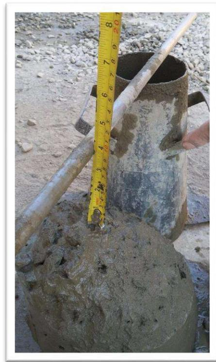
*Figura N° 67: Fabricación de las probetas con su respectivo Slump para comprobar sobre todo la relación de agua cemento del diseño*
