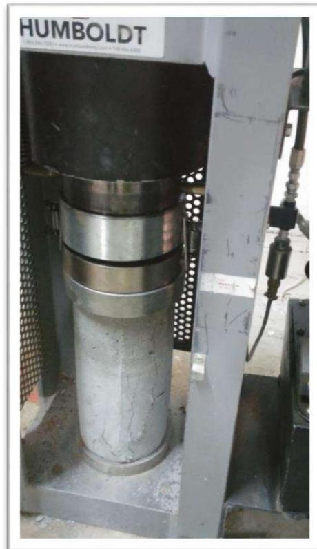
*Figura N° 71: Momento donde se produce la ruptura de la probeta ensayada*
