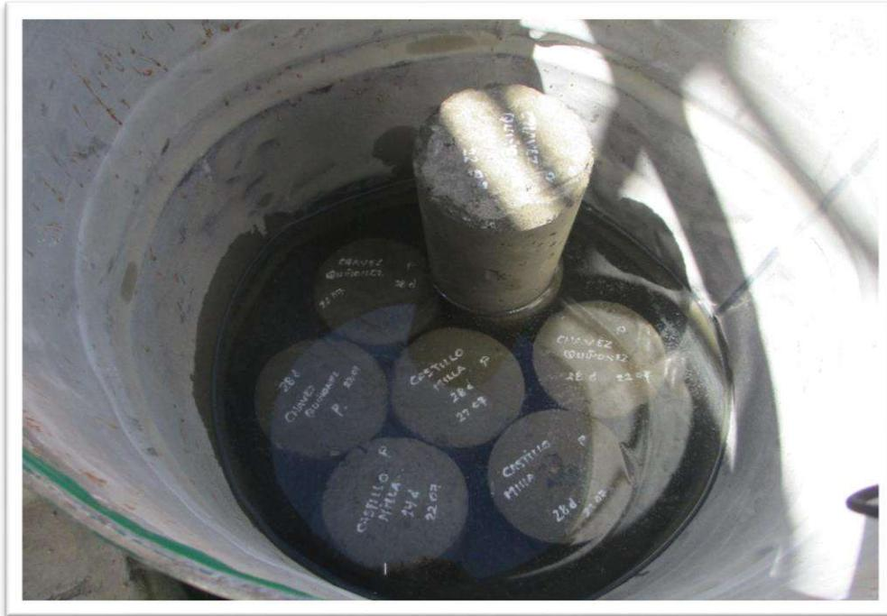
*Figura N° 68: Curado de especímenes de concreto*
