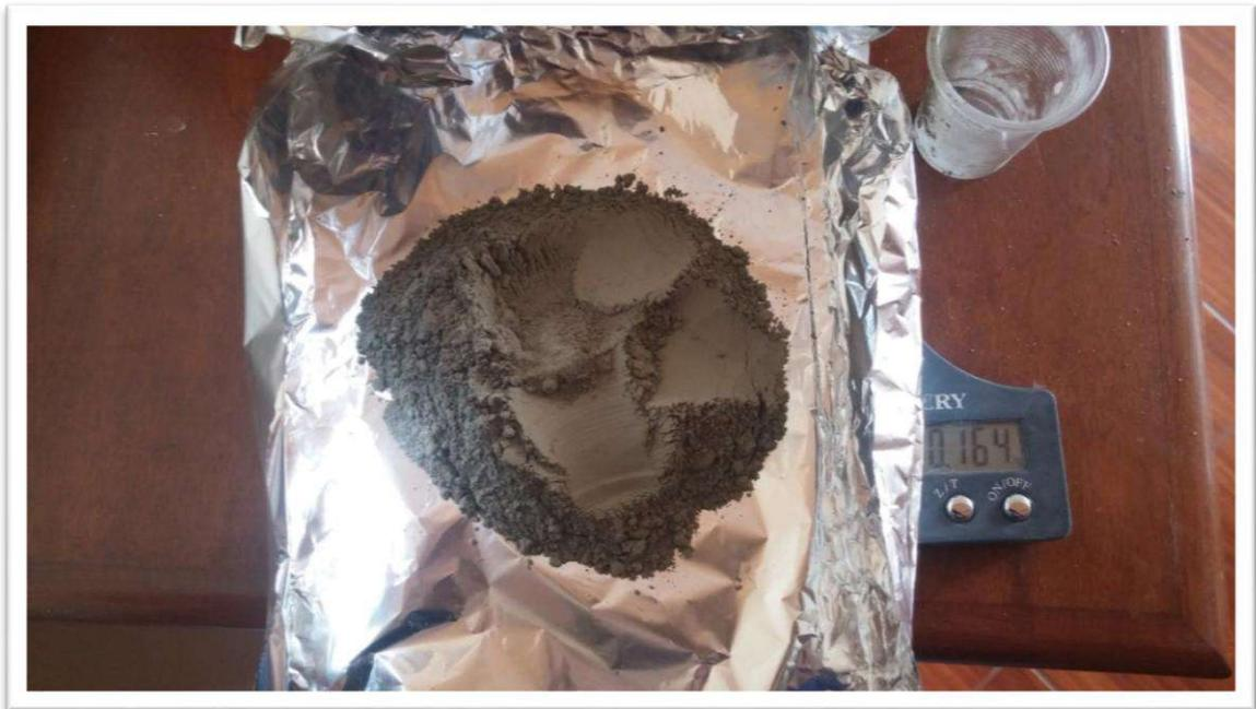
*Figura N° 64: Ceniza de retama empacada y pesada en papel de aluminio para el ensayo de pH, muestra de ceniza, cemento más cenizo al 8% y cemento más cenizo al 16% ensayo realizado en el laboratorio de calidad ambiental de la UNASAM*
