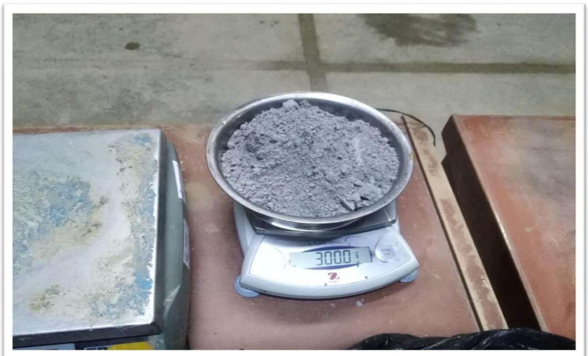
*Figura N° 65: Ceniza de retama calcinada a 400 °C por 2 Horas pesado para halla el peso específico- Laboratorio de mecánica de suelos- USP-Huaraz*
