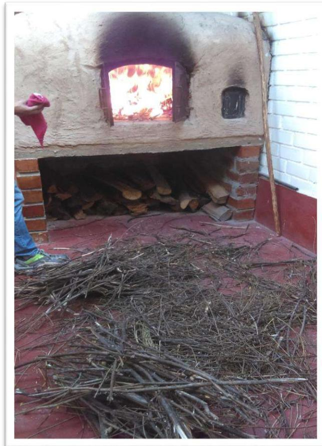
*Figura N° 61: Horno limpio con base cerámica donde se dio el prequemado.*
