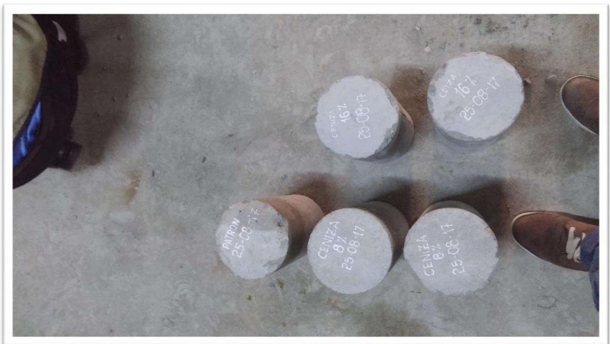
*Figura N° 69: Muestras llevadas al laboratorio de mecánica de suelos de la Universidad San Pedro para su ruptura a compresión*
