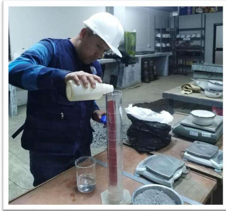
*Figura N° 66: Preparación para ver el desplazamiento de la muestra de ceniza para encontrar el peso específico por desplazamiento.*
