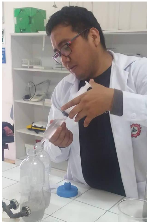
Figura 47: Extrayendo el agua después del ensayo de jarras para llevar al
