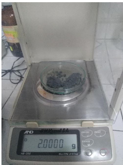
Figura 39: Pesando 2,0 gr de ceniza de paja de trigo para la prueba de jarras
