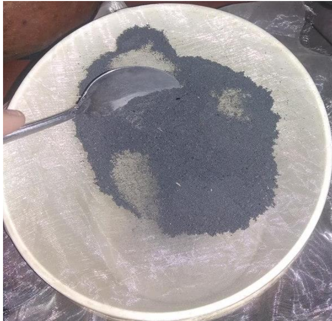
Figura 20: Pasando la ceniza molida de paja de trigo por la organza
