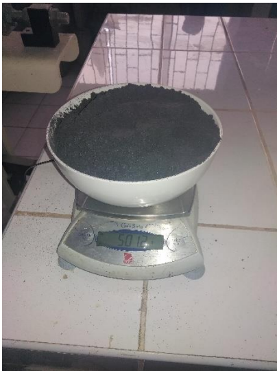
Figura 21: Pesando antes de la activación
