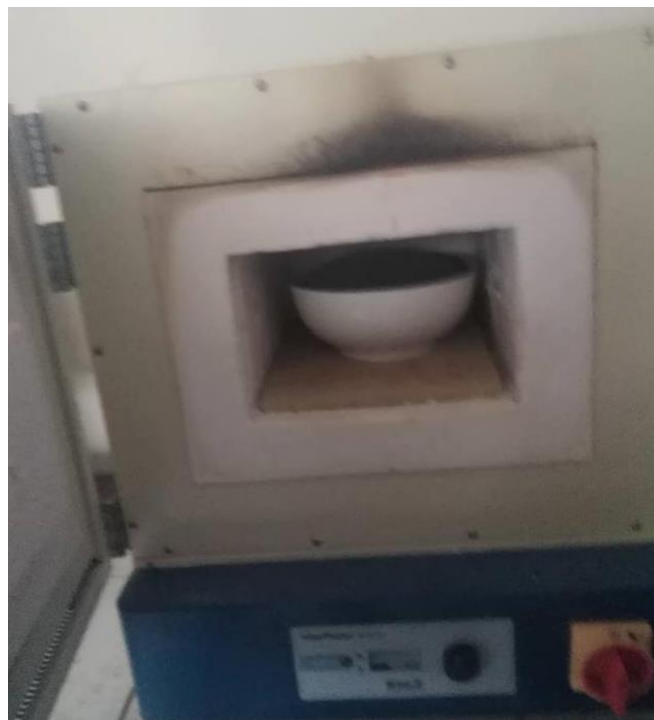
Figura 8: Cenizas de paja de trigo activadas a 600° por 45 minutos Fuente: Universidad San Pedro
