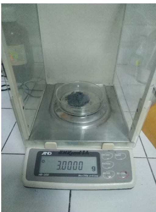
Figura 41: Pesando 3,0 gr de ceniza de paja de trigo para la prueba de jarras
