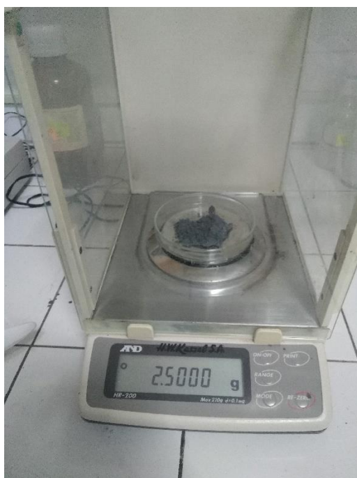
Figura 40: Pesando 2,5 gr de ceniza de paja de trigo para la prueba de jarras
