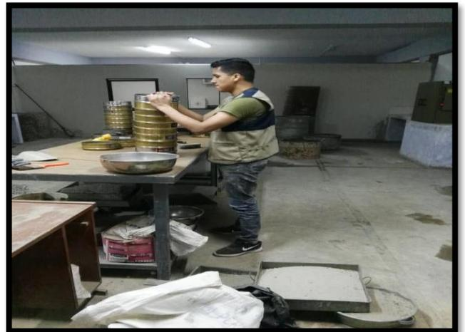
FOTO N° 13: Seleccionando las mallas para realizar la granulometría.
