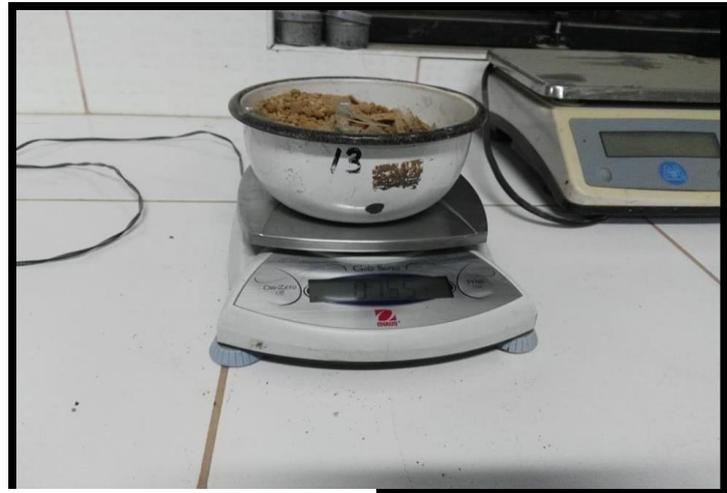
FOTO N°52: Peso del molde + la muestra húmeda compactada.
