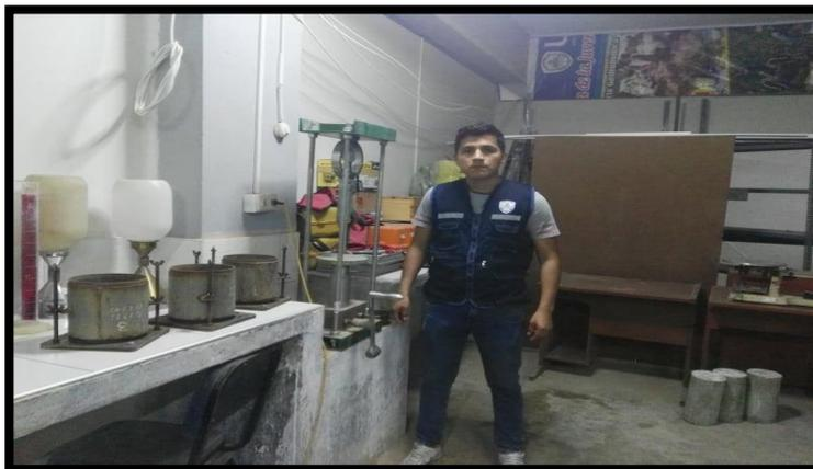
FOTO N°64: Realizando las lecturas de la expansión de los moldes CBR
