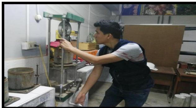
(Realizando el ensayo de CBR de la muestra de suelo experimental)
