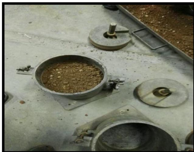
FOTO N°38: Muestra mezclada con un porcentaje de agua determinado
