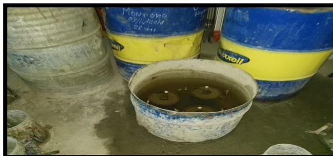
FOTO N°62: Colocación de los moldes CBR experimentales al agua, durante 96 horas.
