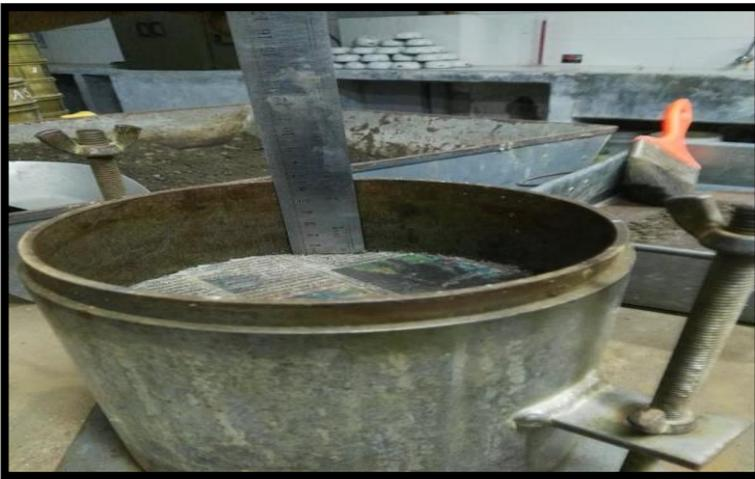
FOTO N°61: Peso y enrasado de la parte superior de la mezcla de suelo adicionado
