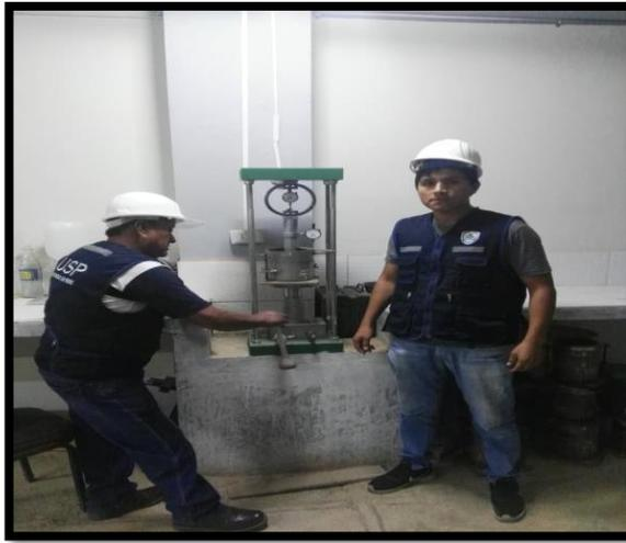
**(Realizando el ensayo de CBR de la muestra de suelo patrón)**
