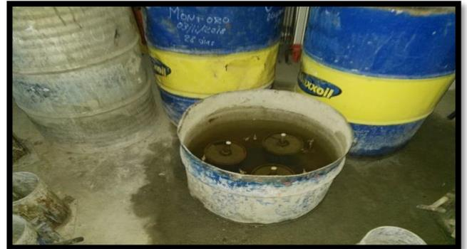
(Colocación de los moldes CBR experimentales al agua, durante 96 horas.
