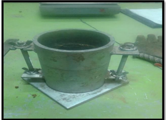
FOTO N°31: Mezclando la muestra con un porcentaje de agua determinado y vaciar al molde de Proctor.
