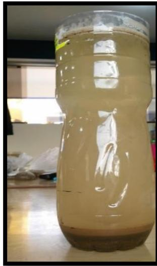
**(Botella de agua después de reposar 24 horas, donde se observa las 3 capas)**
