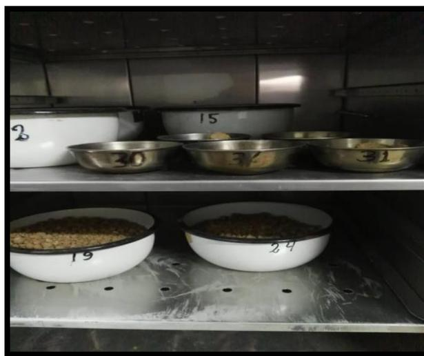
FOTO N°24: Colocando las muestras de suelo en el horno para secado
