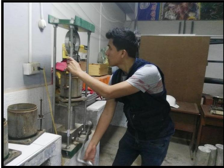
FOTO N°66: Realizando el ensayo de CBR de la muestra de suelo experimental
