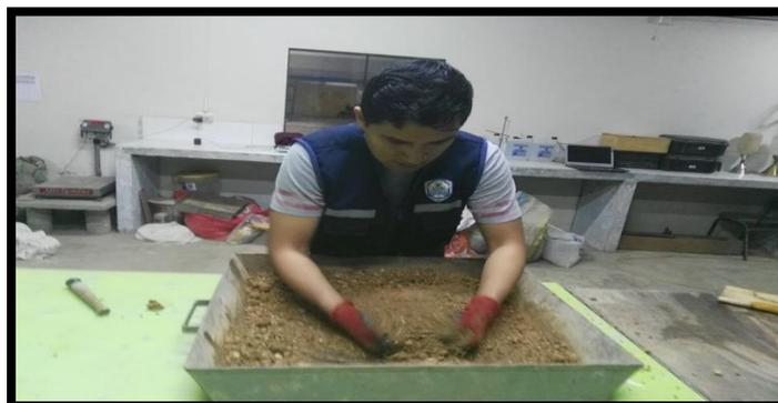
FOTO N°58: Mezclando una muestra con la adición del 3% de Polietileno Tereftalato.
