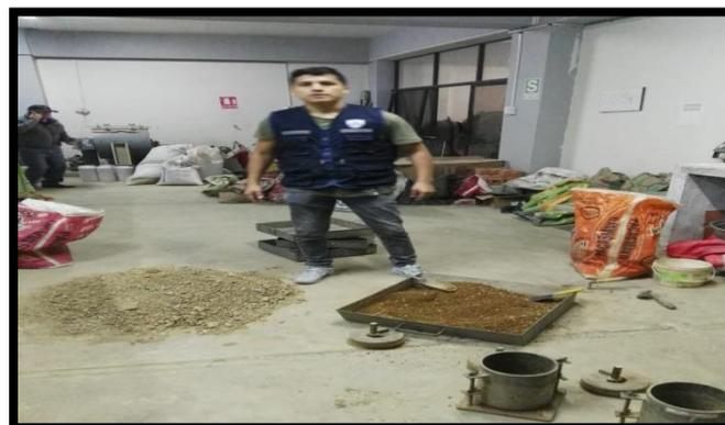
FOTO N°37: Mezclando la muestra con un porcentaje de agua determinado
