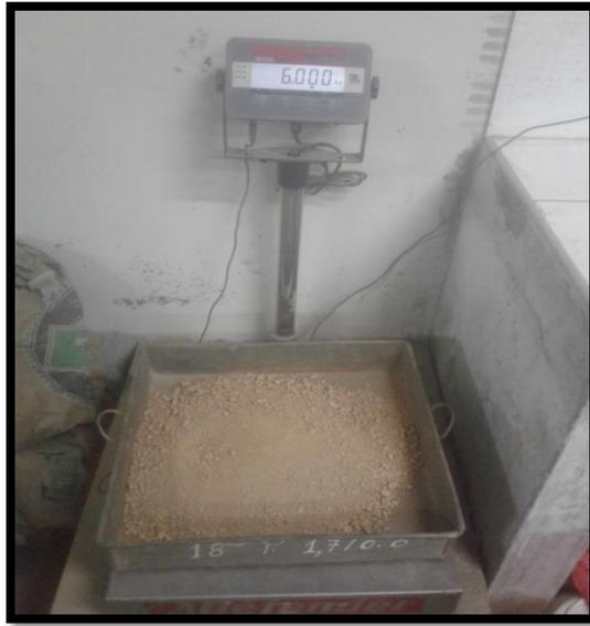
(Peso de la muestra 6kg para el ensayo de CBR)
