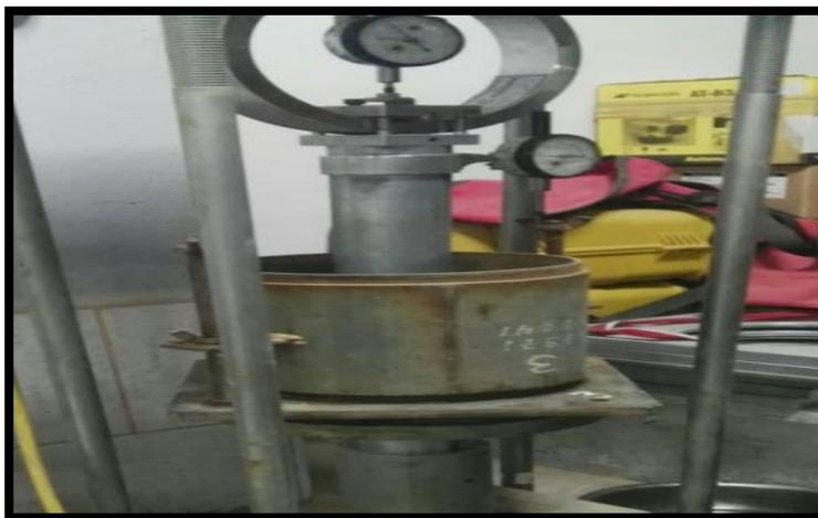
FOTO N°65: Vista del Trípode con el dial de deformación.
