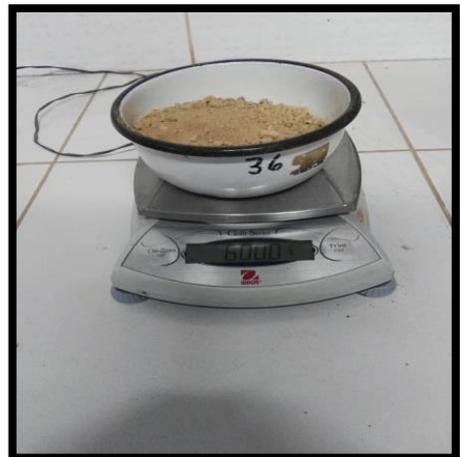
FOTO N° 07: Pesando la muestra de suelo húmedo.
