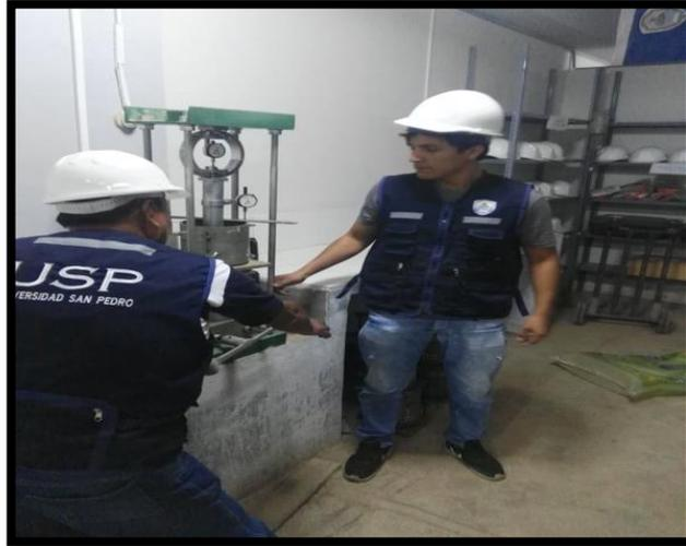
FOTO N°44: Leyendo las lecturas diales en la máquina de penetración de CBR
