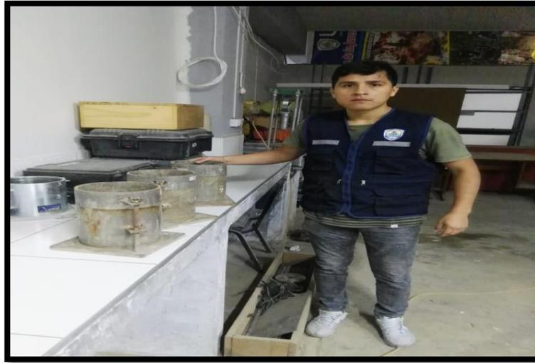
FOTO N°35: Moldes para ensayo de CBR
