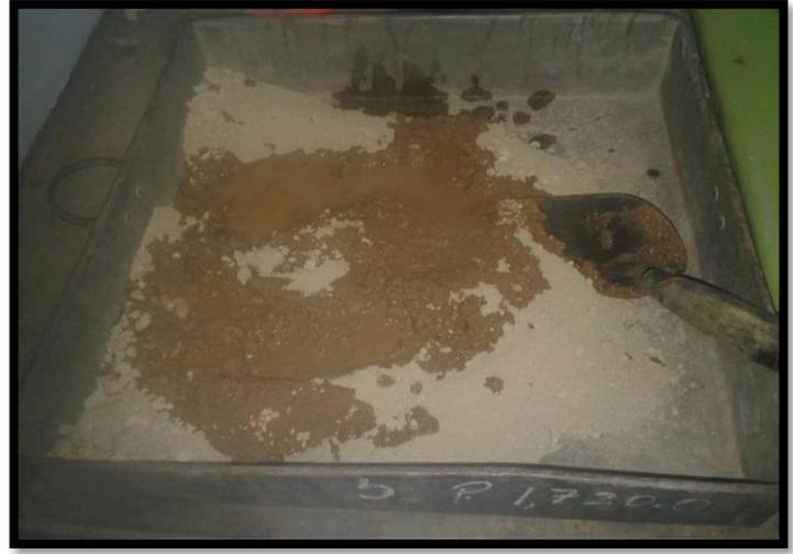
FOTO N°30: Agregando agua a la muestra de suelo y repartiéndolo en 5
