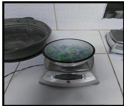
FOTO N°48: Peso de la adición en un 3% de Polietileno Tereftalato para las cuatro muestras de suelo de 3.090 Kg.
