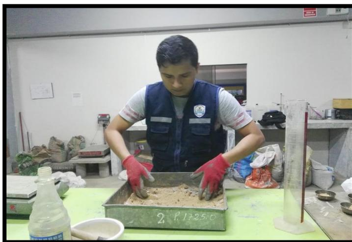
FOTO N°50: Mezclando la adición de un 3% de Polietileno Tereftalato con una muestra.
