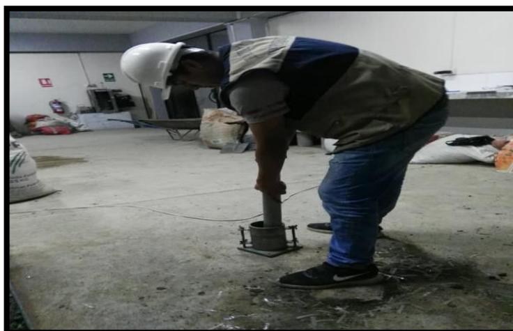
FOTO N°51: Compactando la mezcla de suelo con el pisón, 25 golpes por cada capa.
