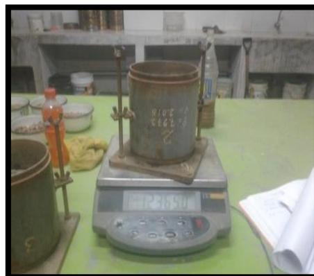
**(Muestra pesada después de la saturación)**
