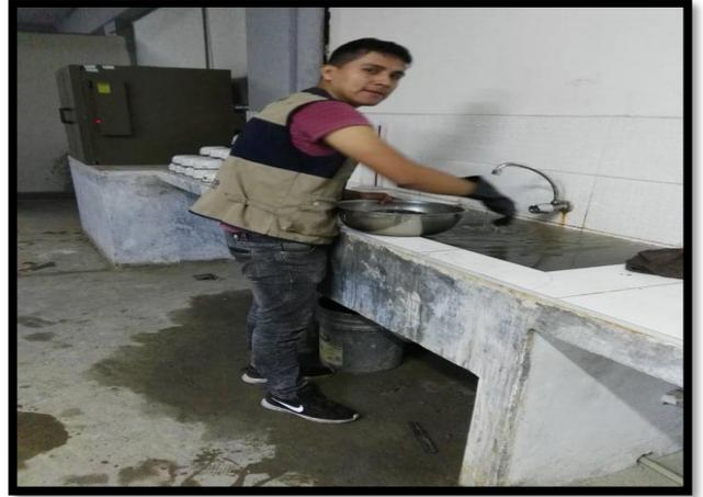
FOTO: N° 11: Realizado el lavado de la muestra, utilizando la mala N° 200.
