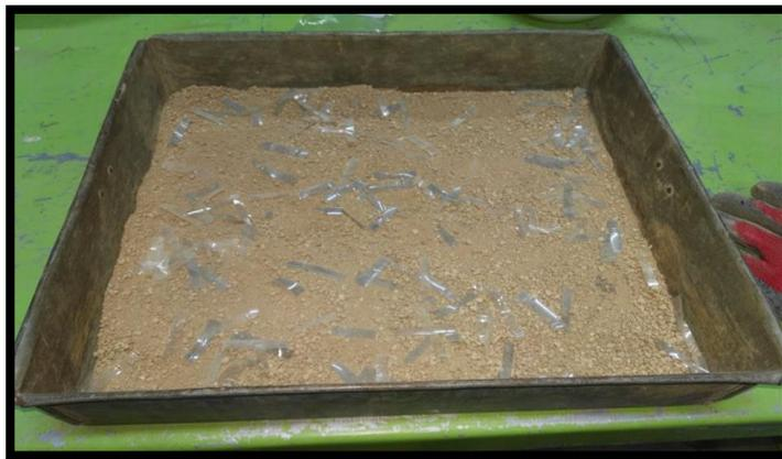
FOTO N°49: Vista de la adición de un 3% de polietileno Tereftalato sobre una muestra
