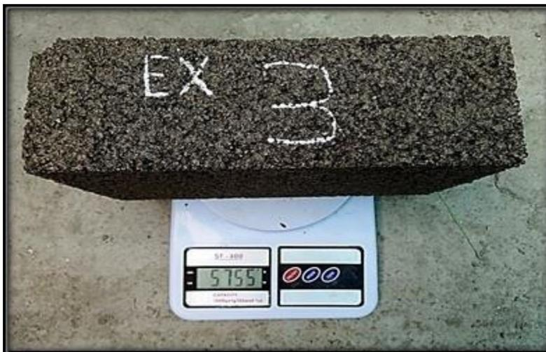
**Figura 26:** Control de peso después del curado
