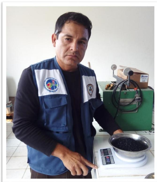
**Figura 13:** Peso del caucho triturado seco
