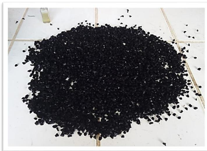
**Figura 11:** secado superficial del caucho triturado
