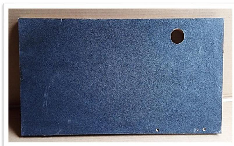
**Figura 18:** Base sin deformaciones ni abultamientos
