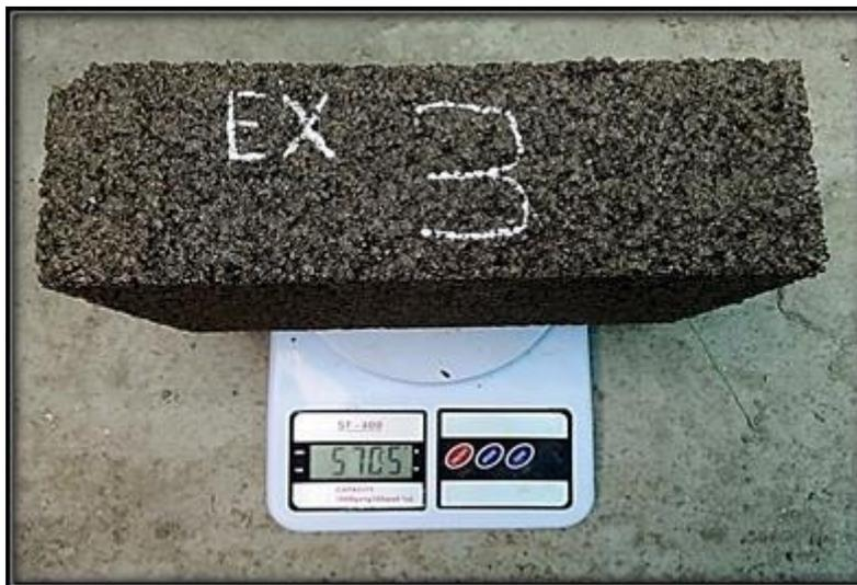
**Figura 24:** Control de peso antes del curado
