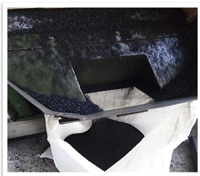
**Figura 8:** Proceso de envasado del caucho triturado
