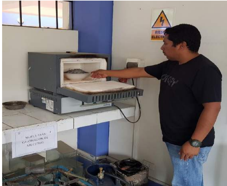
Foto N° 07: colocación de la ceniza pre quemada de cardón para ser calcinada en la mufla a una temperatura de 750° por 90 minutos
