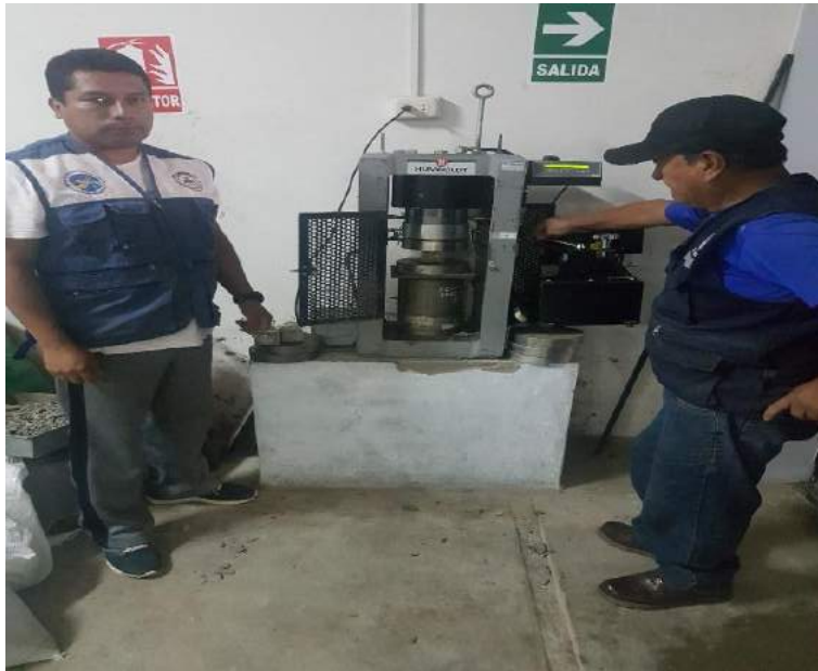
Foto N° 16: vista panorámica del ensayo de compresión de los cubos de mortero
