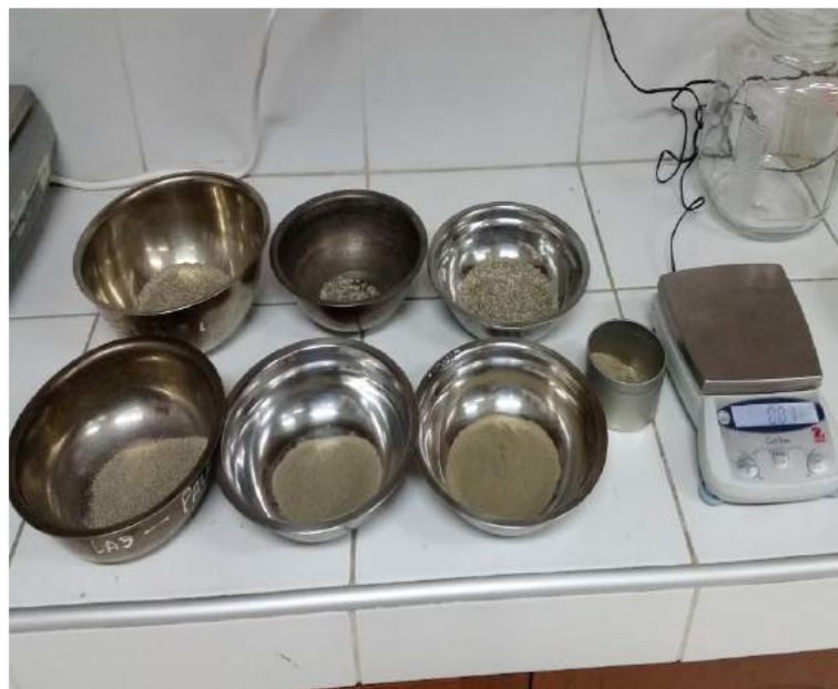
Foto N° 12: peso de la arena gradada y demás materiales utilizados para la elaboración del mortero
