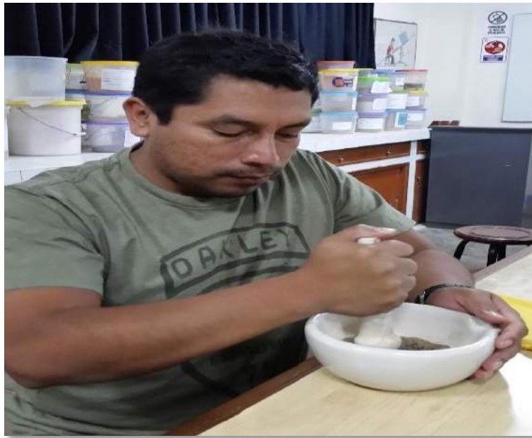
Foto N° 04: trituración de la ceniza de cardón con un mortero de porcelana
