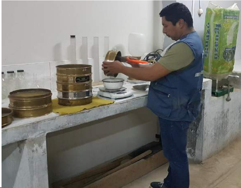
Foto N° 09: realización del ensayo de análisis granulométrico por tamizado y gradación del material
