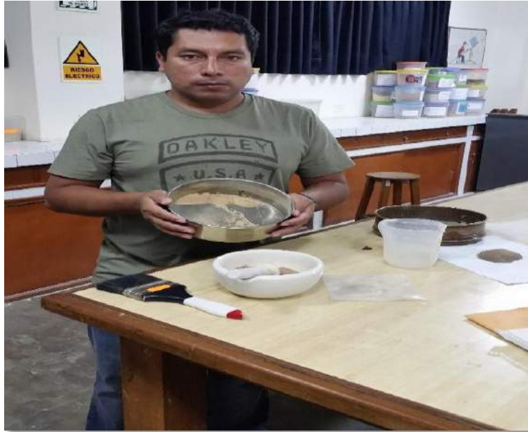
Foto N° 05: tamizado de la ceniza de cardón para poder hacer el ensayo de ATD
