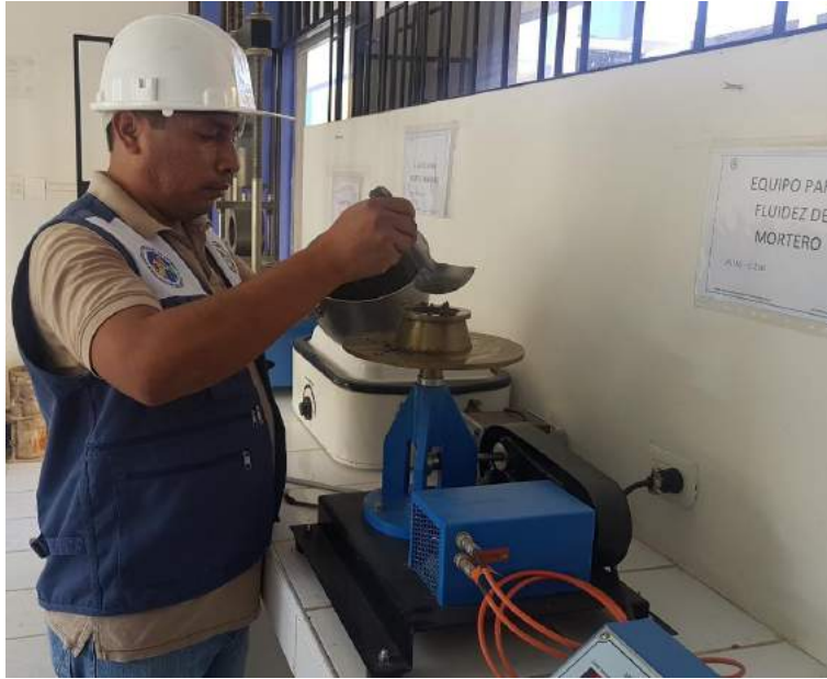
Foto N° 15: realización del ensayo de fluidez con el equipo llamado mesa de flujo
