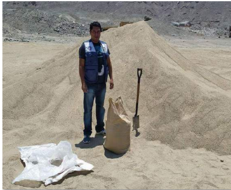
Foto N° 02: muestreo del agregado fino en la cantera "Besique"
