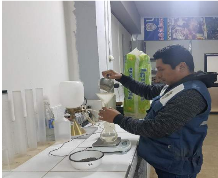
Foto N° 11: elaboración del ensayo de peso específico y absorción del agregado fino
