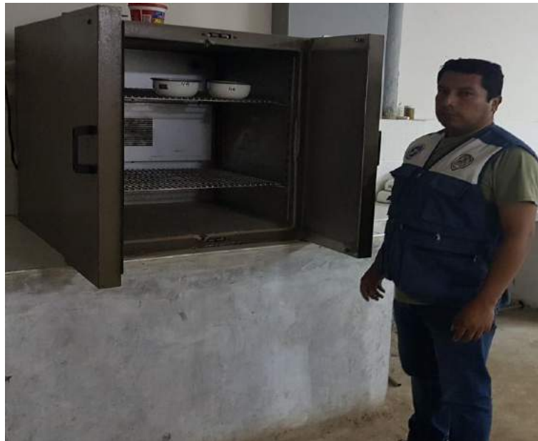
Foto N° 10: colocación de muestras de agregado fino en el horno para determinar su humedad natural
