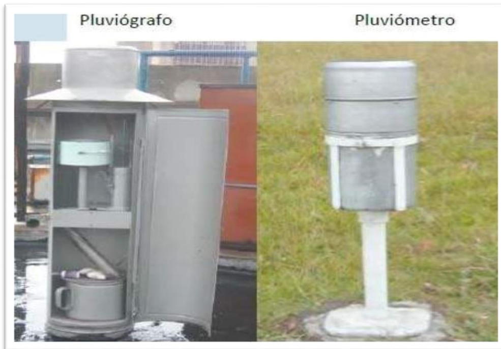
Figura 8. Aparatos climatológicos de medición de lluvia.
