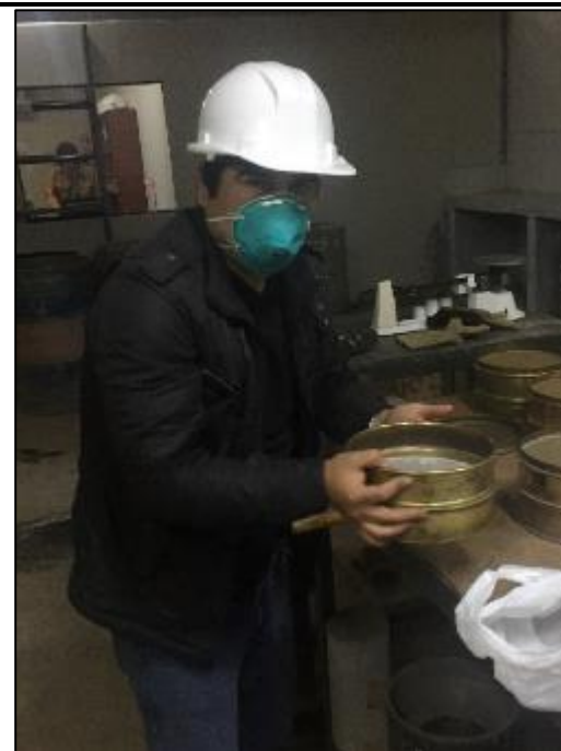
Foto N°33: Como se muestra en la imagen se inició con el tamizado del vidrio molido y las cenizas de las conchas de abanico, en el Laboratorio de suelos de la Universidad San Pedro.
