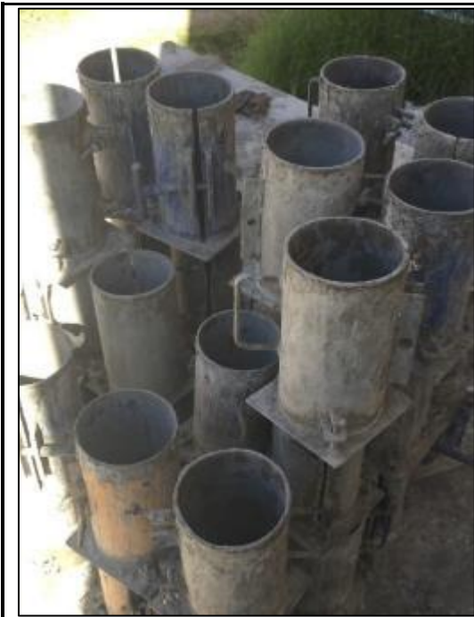
Foto N°38: Se observan los encofrados metálicos de 15 de diámetro y 30 de alto para la fabricación de 27 probetas de concreto permeable.
