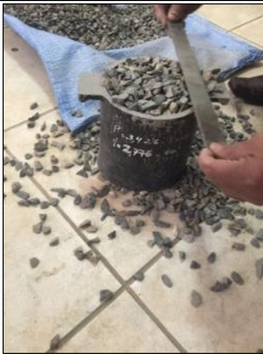
Foto N°22: Peso unitario compactado: Una vez lleno el recipiente se procede a reglar y nivelar con la regla metálica.
