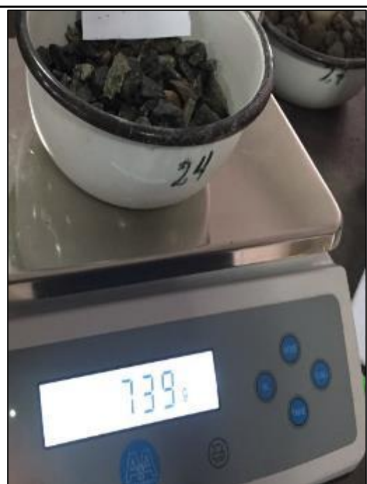
Foto N°7: Ensayo Contenido de humedad: Se obtuvieron como datos iniciales los pesos de las tres muestras que vendría a ser el peso del recipiente más peso de la muestra.
