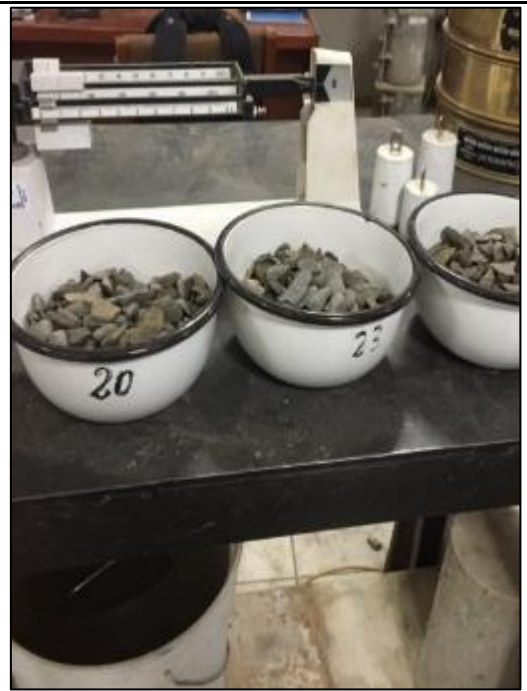
Foto N°11: Ensayo de peso específico y absorción: Las tres muestras ya pesadas en sus respectivos recipientes.
