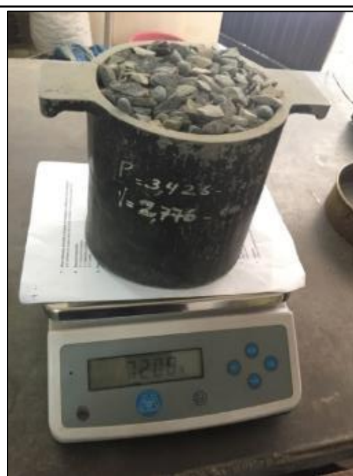
Foto N°19: Ensayo de peso unitario suelto: Se procedió a pesar el recipiente y el material.
