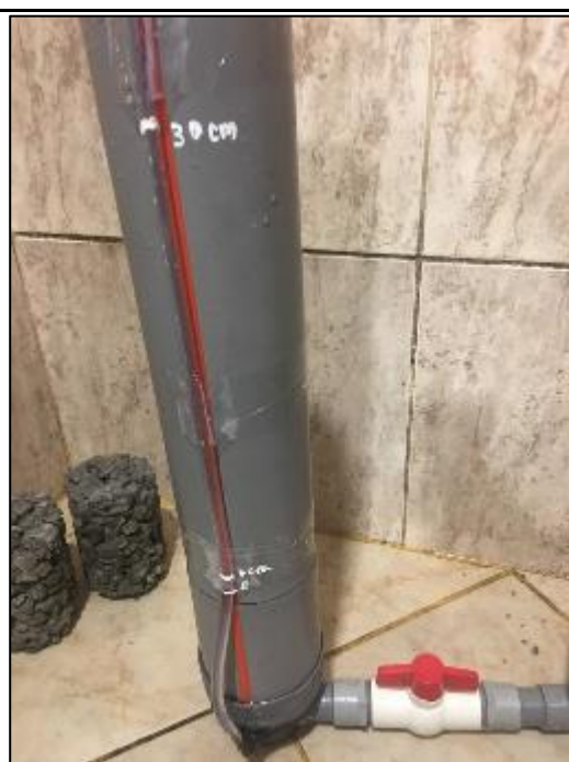
Foto N°55: Permeabilidad: Se controlo en tiempo que demora en pasar de H1 (30cm) a H2, para poder determinar el coeficiente de permeabilidad.
