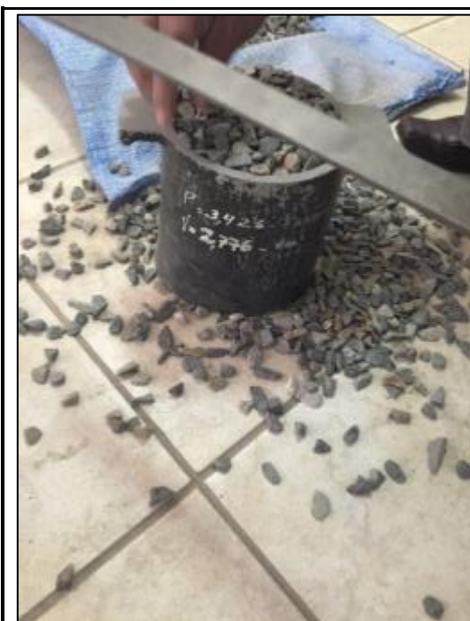
Foto N°18: Ensayo de peso unitario suelto: Una vez que se tenga lleno el recipiente se procede a regular el borde para que todo se encuentre dentro del recipiente.
