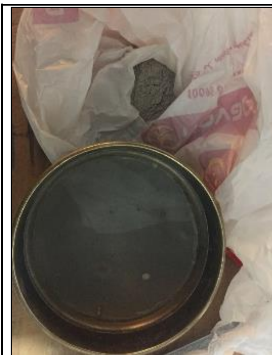
Foto N°34: Para obtener un material idóneo para sustituir al cemento en 20 y 40%, las muestras de vidrio molido y las cenizas de conchas de abanico, se tamizaron con la malla N°200, en el laboratorio de suelos de la Universidad San Pedro.
