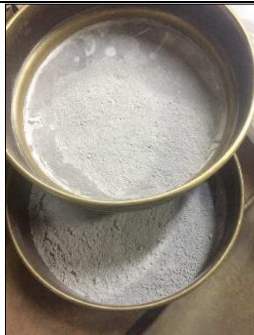
Foto N°36: Se tamizo la muestra de las cenizas de conchas de abanico y se envió a la UNMSM donde se realizó el ensayo de Florescencia de Rayos X.
