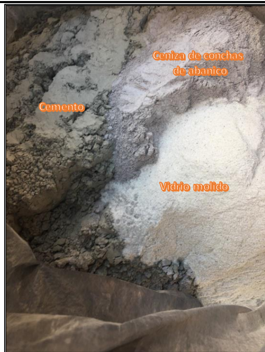
Foto N°37: En la imagen se muestra los contrastes del cemento, vidrio molido y de las cenizas de conchas de abanico, mezcla que se usó para la fabricación de los especímenes de concreto permeable experimental.
