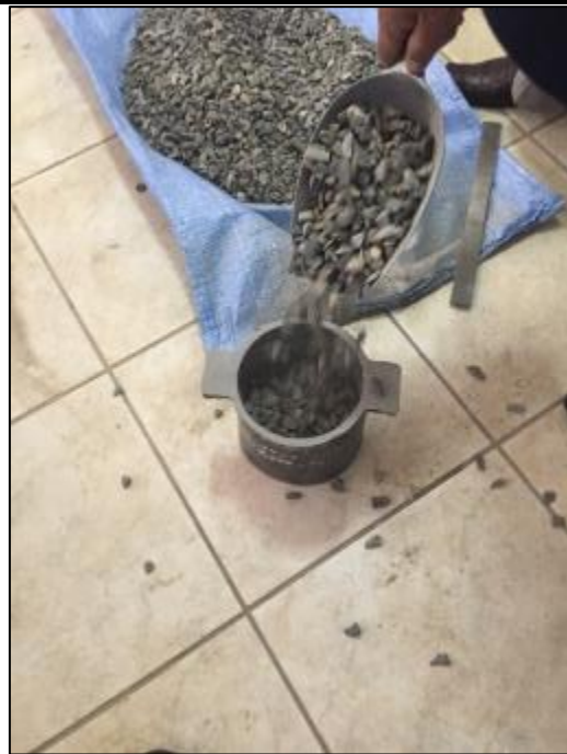
Foto N°17: Ensayo de peso unitario suelto: Se llenó el recipiente desde una distancia de 25 centímetros por encima del recipiente con una cuchara pala.
