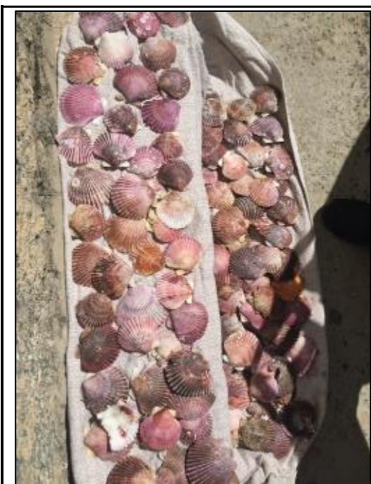
Foto N°26: Al encontrarse sucias las conchas de abanico se limpiaron con agua y cepillo de acero, para remover elementos que podrían ser perjudiciales para la investigación, se esparcieron sobre un saco de polipropileno para ser secados por el sol.
