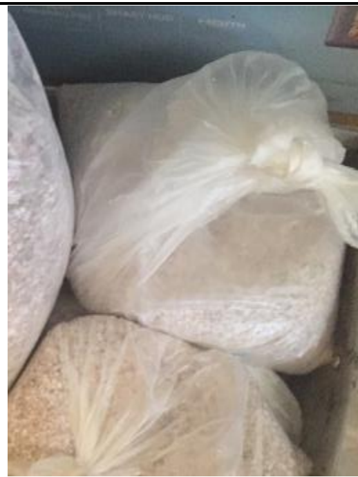
Foto N°29: Según se observa, se llenaron en bolsas los granos de conchas de abanico, para ser llevadas a la UNASAM y sean quemadas con la mufla.
