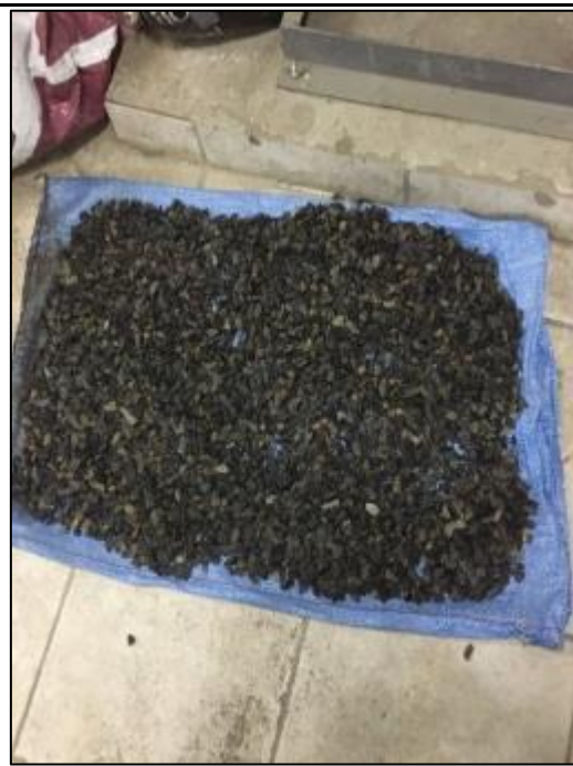
Foto N°15: Ensayo de peso unitario: Para secar el agregado grueso se tuvo que esparcir sobre un costal de polipropileno, y se dejó a temperatura ambiente por 24 horas.
