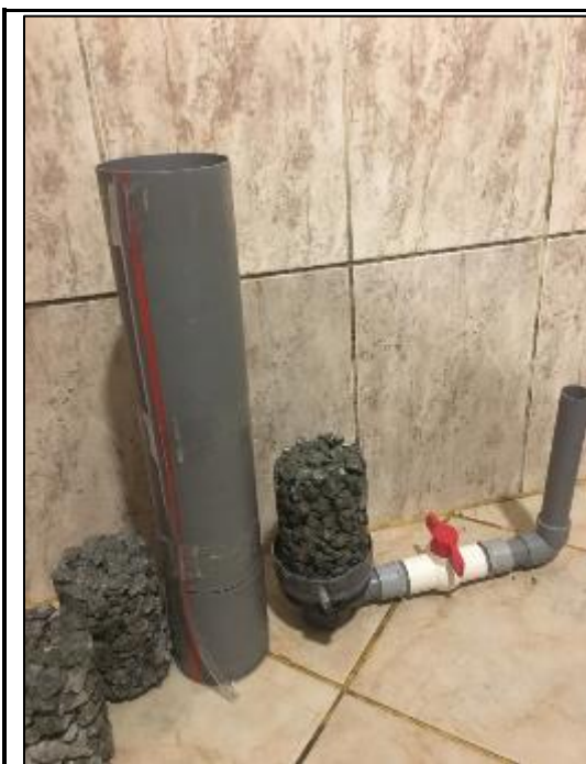
Foto N°50: Permeabilidad: Se realizó el ensayo de permeabilidad, con el prototipo de Permeámetro de carga variable elaborado según criterios del ACI 522R-10.
