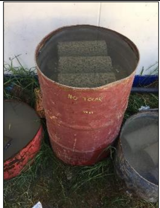
Foto N°41: Se dejó que fragüe el concreto permeable por 24 horas, luego se introdujeron las probetas a un cilindro lleno con agua para que se curen previos a los ensayos a los que serán sometidos a los 7, 14 y 28 días.
