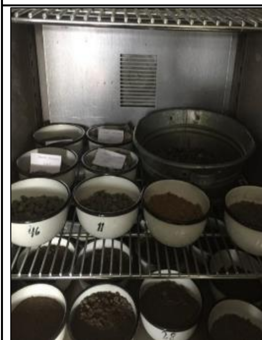
Foto N°8: Ensayo Contenido de humedad: Se observa que la muestra es colocada en el horno, se mantuvo ahí por 24 horas para obtener el peso del recipiente más el peso del material seco.
