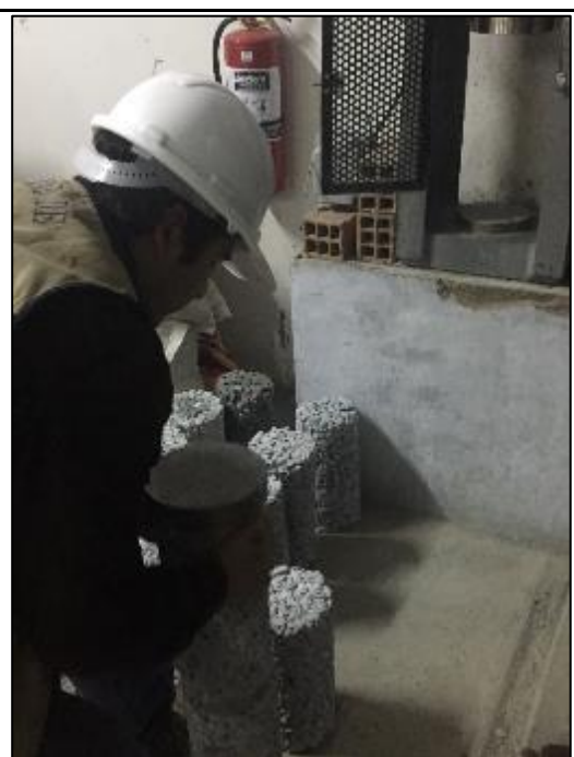
Foto N°43: Resistencia a la compresión: Se observa la colocación de los platos de retención a la probeta.
