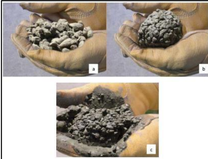
Figura 11. Muestras de concreto permeable con diferentes cantidades de agua: (a) con poca agua, (b) adecuada cantidad de agua, (e) con demasiada agua.
