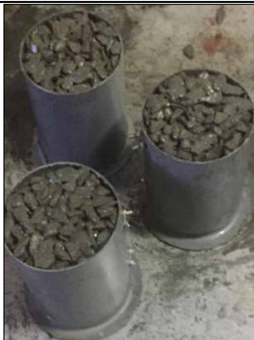
Foto N°48: Permeabilidad: Se fabricaron 9 probetas de concreto permeable, de diámetro 10cm y altura de 15cm.
