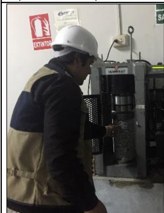
Foto N°44: Resistencia a la compresión: Se observa la colocación de la probeta en la prensa hidráulica, teniendo en cuenta que el espécimen debe de estar centrado.
