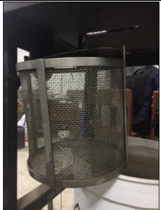
Foto N°13: Ensayo de peso específico y absorción: Se utilizó la canastilla para obtener el peso sumergido de la canastilla y de las muestras, finalmente se resta el peso de la canastilla a la muestra para obtener el peso del material saturado superficie seca en agua
