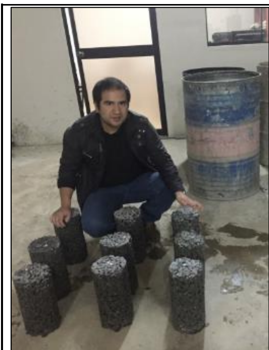
Foto N°42: Resistencia a la compresión: Las probetas son sacadas del cilindro con agua a los 7, 14 y 28 días de curado, medio día antes del inicio del ensayo de resistencia a la compresión.
