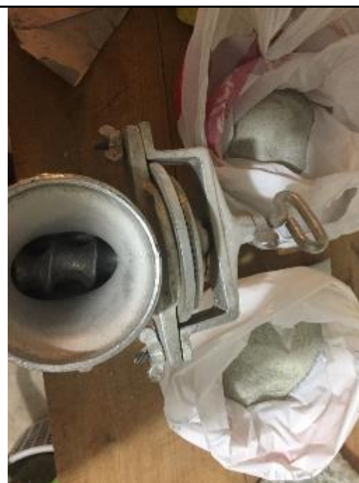
Foto N°31: Para la obtención de granos más pequeños de vidrio, se utilizó un molino de granos, se realizaron varias pasadas hasta obtener un material adecuado.
