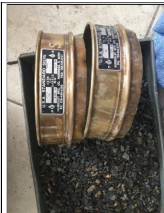
Foto 6: Se utilizó tamices de 3/4" y de 1/2" para la obtención del agregado grueso (piedra chancada) de TMN de 1/2".
