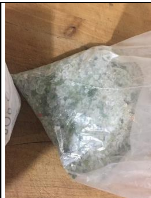
Foto N°30: Después de haberse limpiado los envases de vidrio, se inició con la rotura del mismo hasta obtener granos pequeños.
