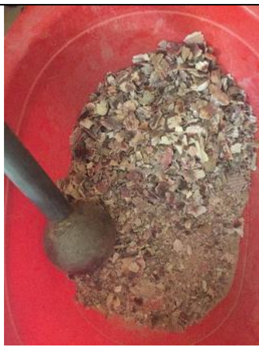
Foto N°27: Según se ve en la imagen se procedió a fracturar las conchas de abanico con la ayuda de un mazo de acero, para conseguir granos pequeños.
