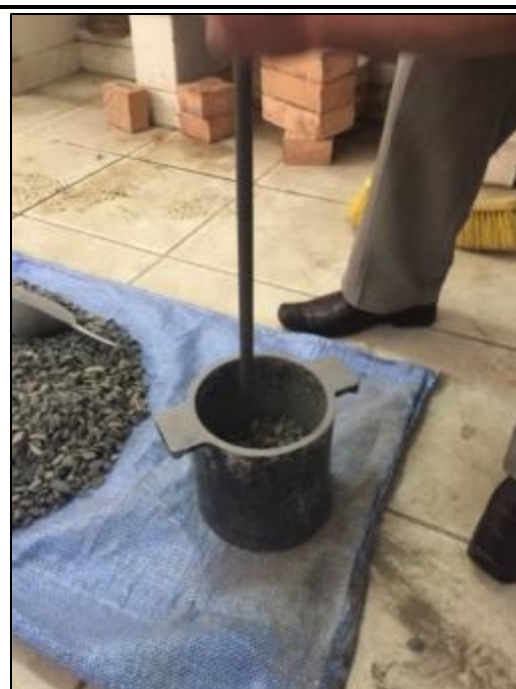
Foto N°21: Ensayo de peso unitario compactado: Se compacta con una varilla cada tres capas, en cada capa se dio 25 golpes.
