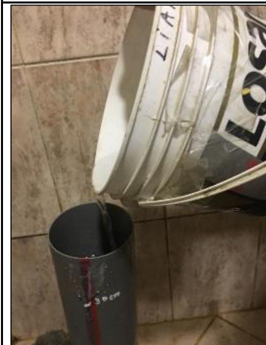
Foto N°52: Permeabilidad: Se llenó de agua el cilindro hasta una altura de 30cm por encima de la muestra cilíndrica de concreto permeable..
