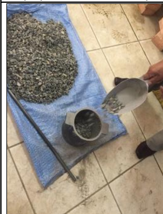
Foto N°20: Ensayo de peso unitario compactado: Se llena el recipiente desde una distancia de 25 centímetros por encima del recipiente con una cuchara de pala.
