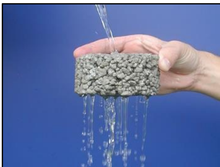
Figura 1: La estructura vacía del concreto permeable permite el paso fácil de agua de lluvia. Fuente: (Pérez 2009).
