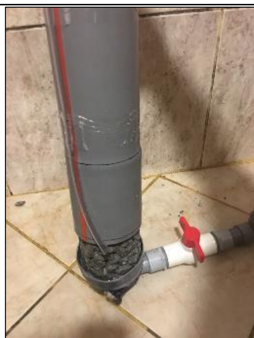
Foto N°51: Permeabilidad: Como se ve en la imagen se colocó la probeta de concreto permeable sobre la base del permeámetro, y se prosiguió al sellado para que no pueda haber fuga de agua.
