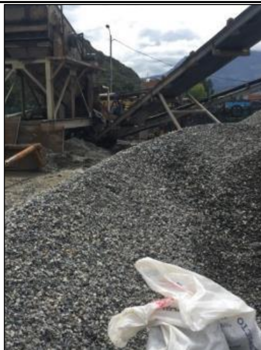
Foto N°4: Cantera Taclán: Se observa la planta chancadora de piedra, del material acumulado en la cantera, se escogió el tamaño adecuado del agregado para la investigación, el mismo que fue llenado en costales de polipropileno.
