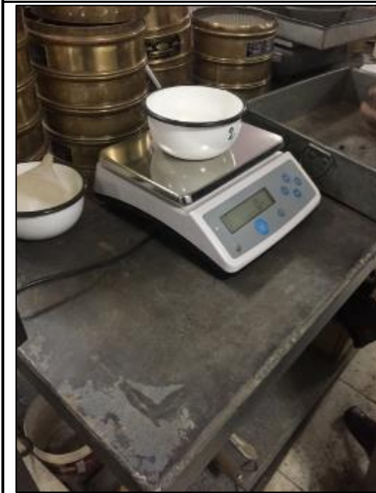
Foto N°10: Ensayo de peso específico y absorción: Una vez seca la superficie del material se taran los recipientes y se pesa la muestra.
