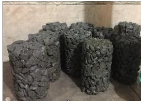
Foto N°49: Permeabilidad: Se procedió a desencofrar los especímenes de concreto permeable.
