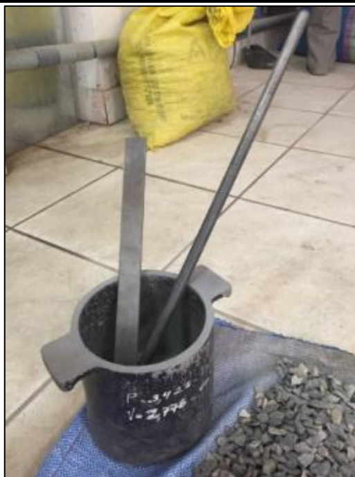
Foto N°16: Ensayo de peso unitario: Se utilizó un recipiente de volumen 2,776\text{cm}^3 , regla de metal y una varilla de acero.
