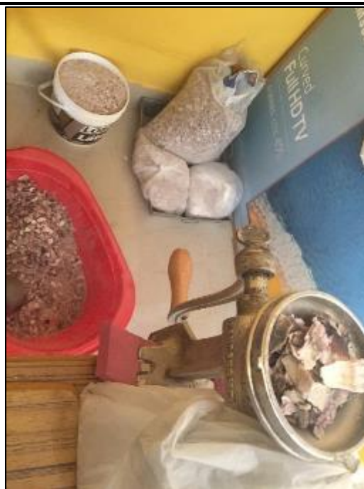
Foto N°28: Una vez ya habiendo obtenido las conchas trituradas, se procedió a utilizar un molino de granos, para conseguir partículas más pequeñas.
