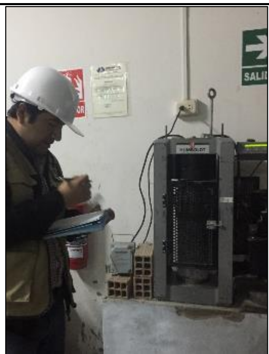
Foto N°45: Resistencia a la compresión: Se tomaron las anotaciones respectivas, de los resultados de resistencia a la compresión de las 9 probetas, a cada 7, 14 y 28 días de curado.
