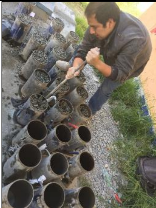
Foto N°40: Se observa el llenado y moldeado de las probetas de concreto permeable patrón y experimental.
