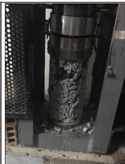
Foto N°46: Resistencia a la compresión: Tipo de falla o fractura que se genera al someterle presión al concreto con la prensa hidráulica, como se observa la falla es de Tipo corte.
