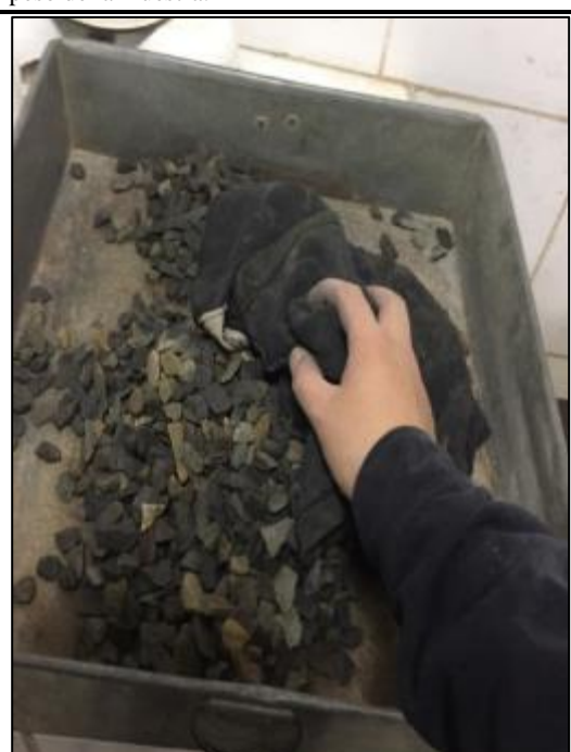
Foto N°9: Ensayo de peso específico y absorción: Después de haber saturado la muestra por 30 minutos, la superficie del material es secado por medio de un trapo
