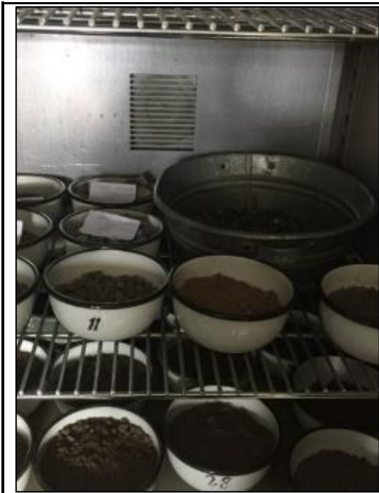
Foto N°14: Ensayo de peso específico y absorción: Las tres muestras son secadas al horno por 24 horas para luego ser pesadas y proceder con los cálculos finales.
