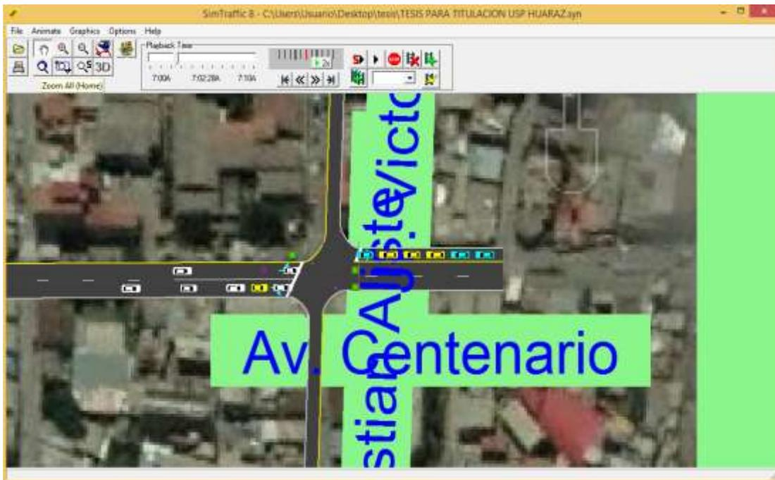
Figura N°413. Micro simulación de la intersección 4
