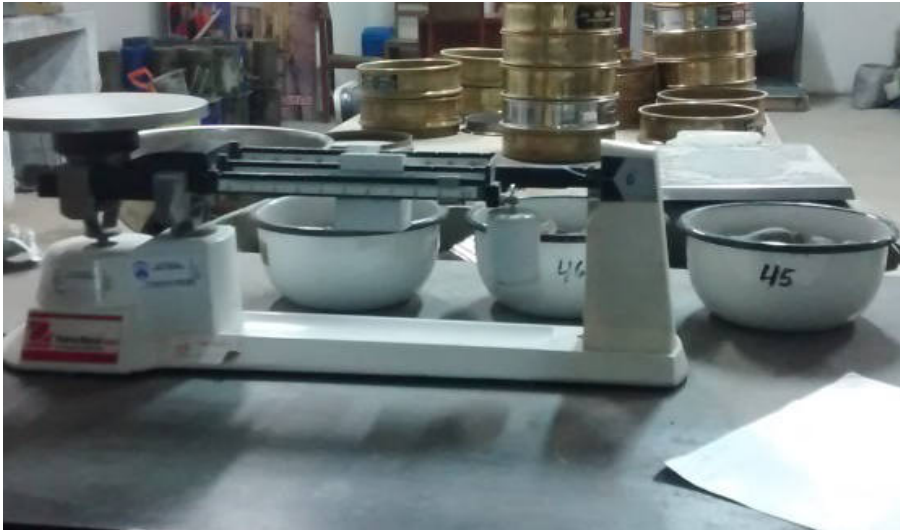
Fotografía N° 9: Ensayo gravedad específica y absorción agregado grueso
