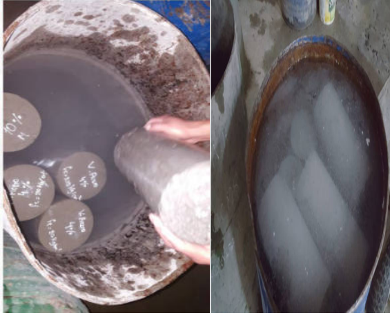
Figura N° 20: Curado de probetas
