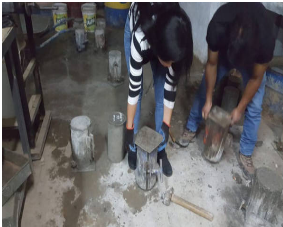
Figura N° 19: Desencofrado de probetas
