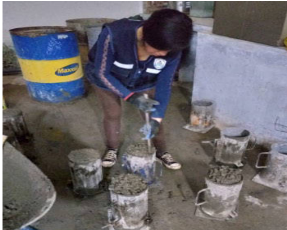
Figura N° 18: Llenado y enrasado de las probetas
