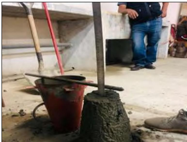
**Figura N° 8:** *Asentamiento de una mezcla con 10% de caucho reciclado*
