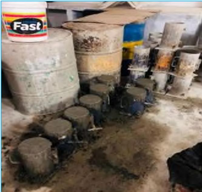
**FOTO 3:** Vaciado de probetas de concreto en el laboratorio de la San Pedro.
