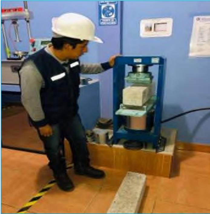
**FOTO 5:** Rotura del concreto a flexión en el laboratorio.
