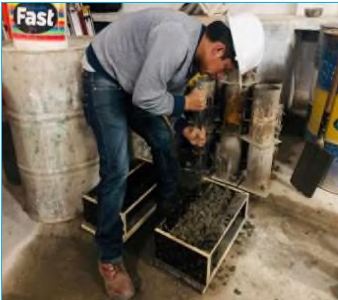
**FOTO 6:** Golpes realizados con la varilla de acero al vaciado de concreto en vigas
