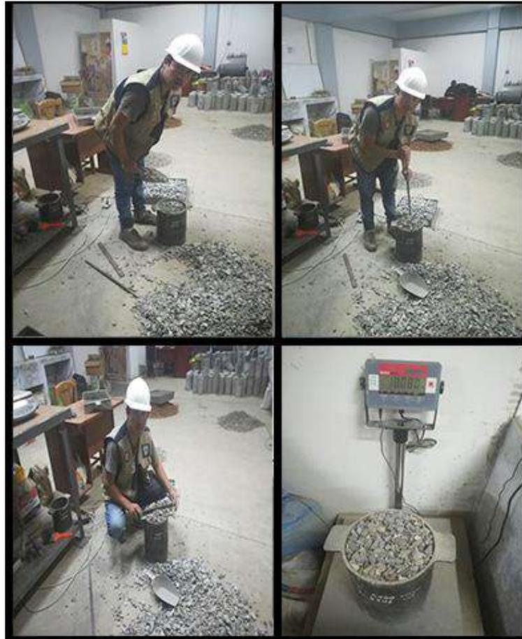
**Figura10.** Peso unitario y porcentaje de vacíos de agregado grueso.
