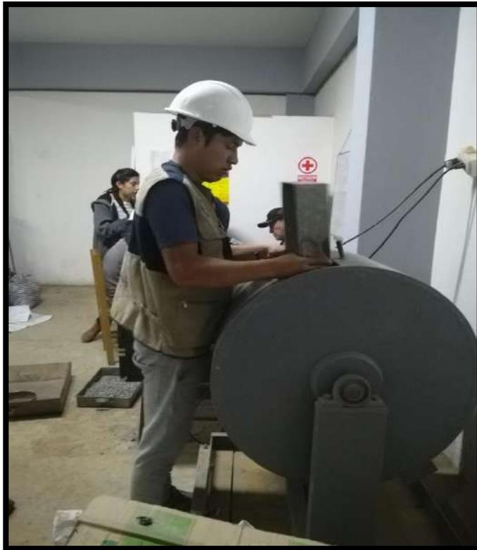
**FOTO N° 13:** Muestra para Resistencia a Abrasión del agregado grueso.
