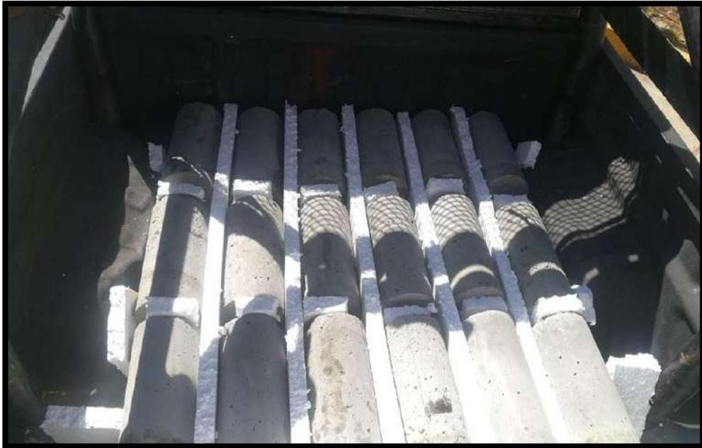
**FOTO N° 19:** traslado y curado de probetas.
