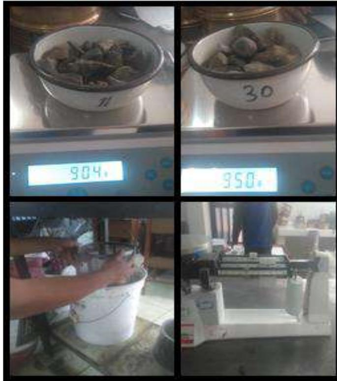
**Figura 8.** Gravedad específica y absorción del agregado grueso
