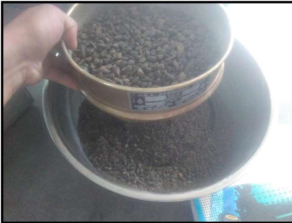
**FOTO N° 07:** Análisis Granulométrico del agregado fino.
