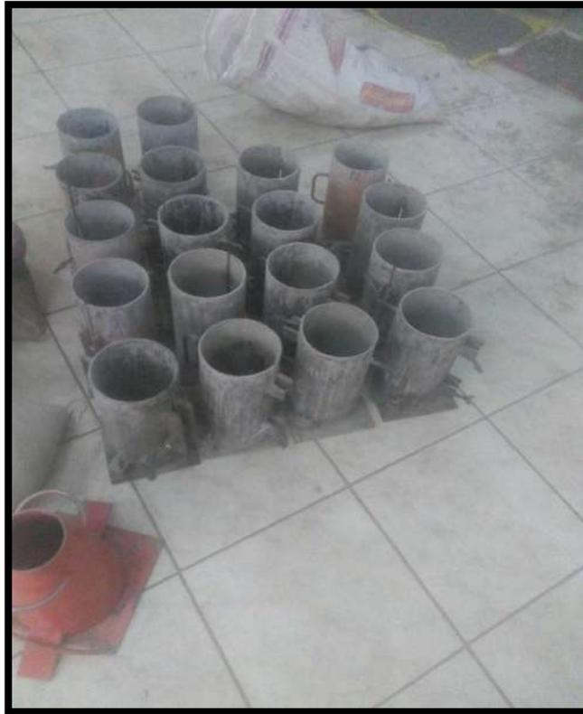
**FOTO N° 14:** Preparación de moldes para el llenado de concreto.
