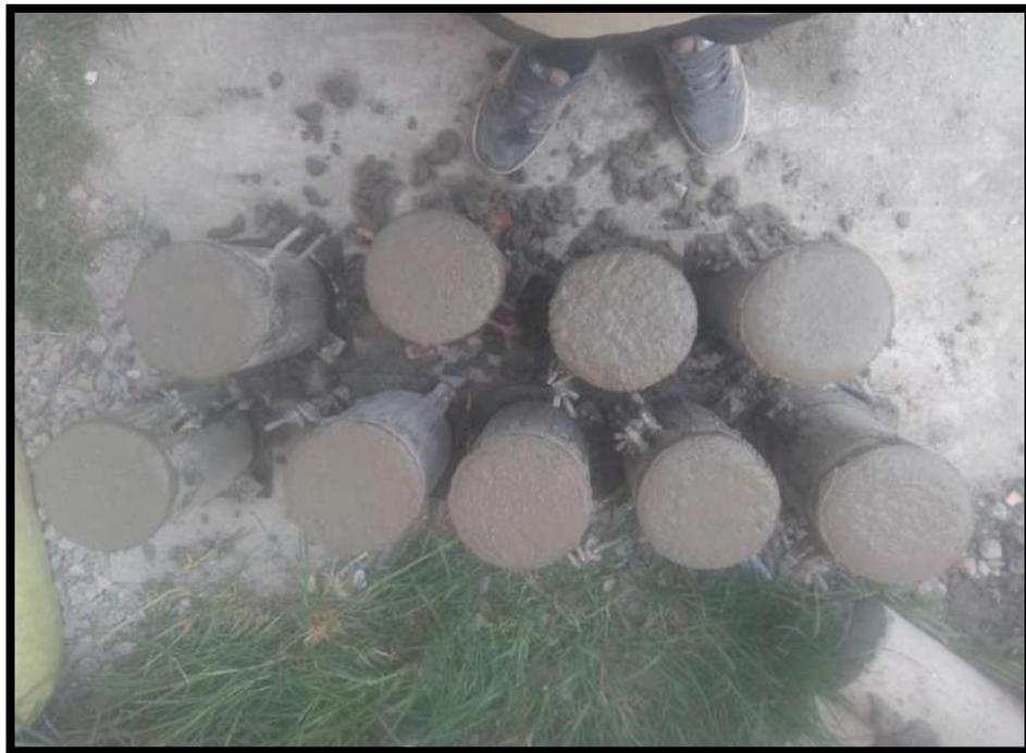
**FOTO N° 16:** Llenado de concreto a los moldes.
