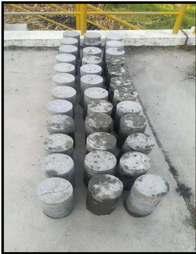
**FOTO N° 18:** Probetas desencofradas.
