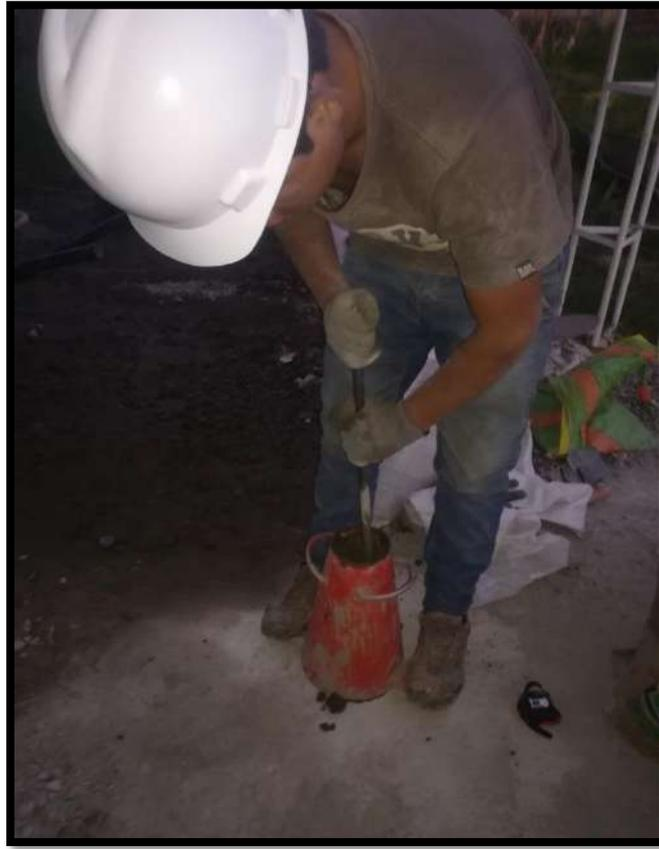
**FOTO N° 16:** Medición del Slump.
