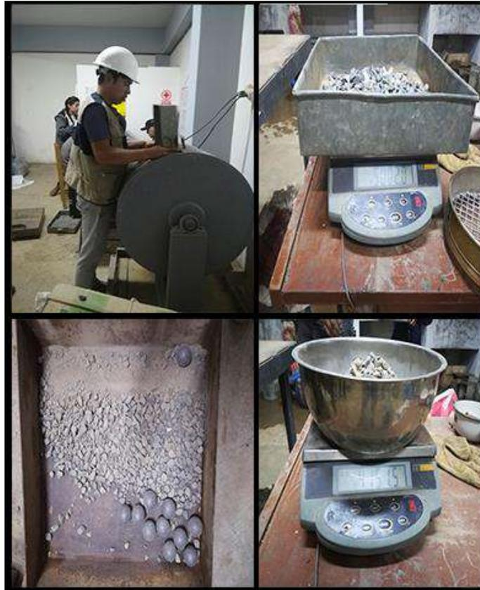
**Figura11.** Resistencia a la Abrasión de los agregados gruesos
