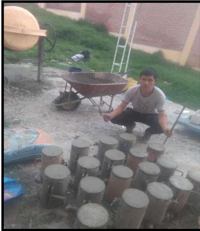
**FOTO N° 17:** Probetas listas a espera de su fraguado.
