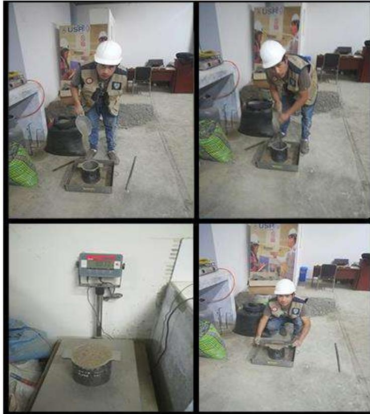
**Figura9.** Peso unitario y porcentaje de vacíos de agregado fino.
