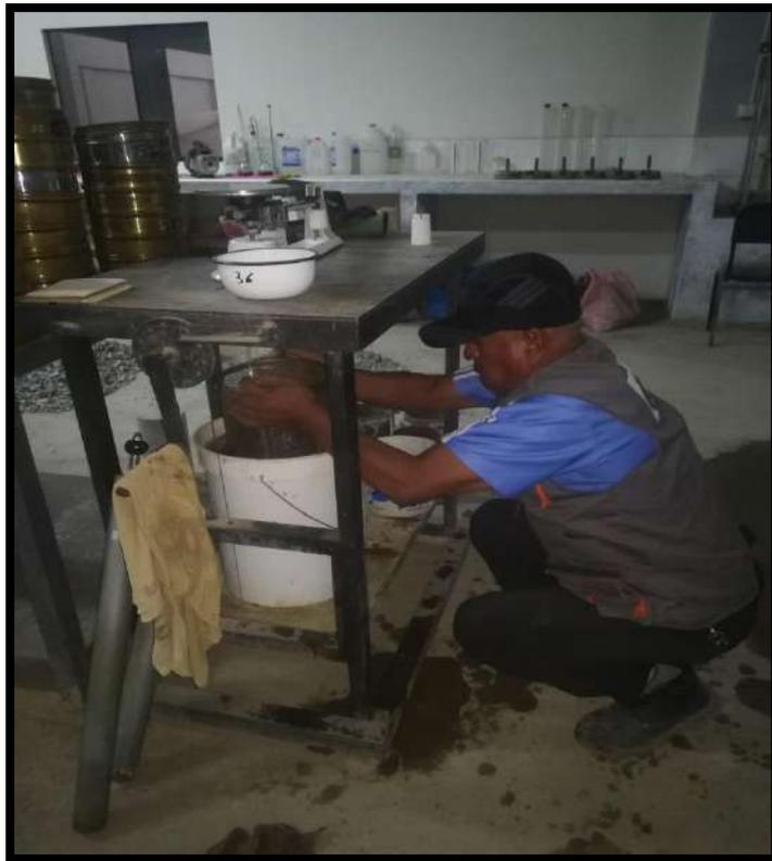
**FOTO N° 11:** Muestra de agregados para la gravedad específica y absorción.
