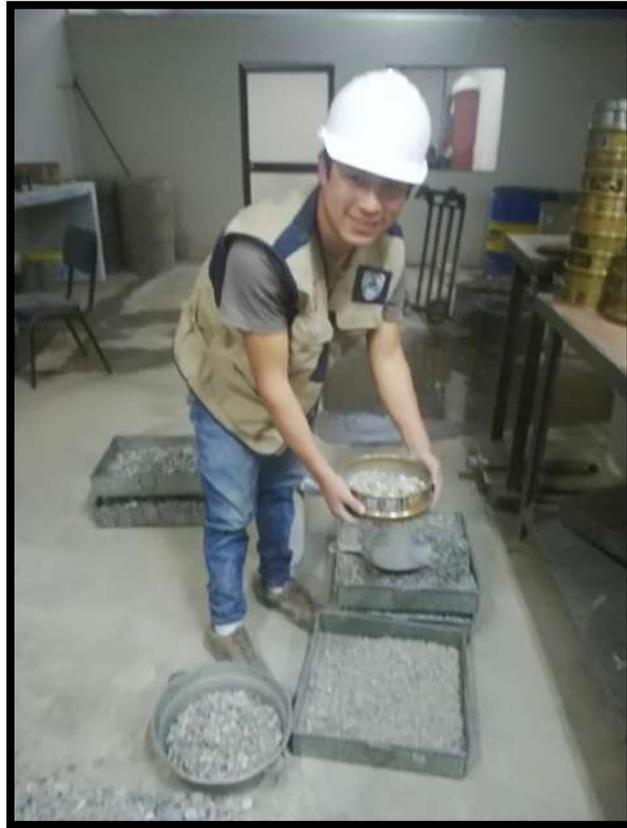
**FOTO N° 04:** Tamizado de los agregados para retirar impurezas
