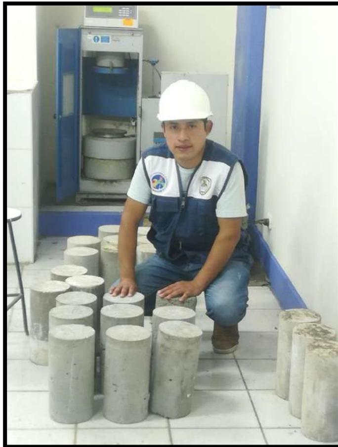
**FOTO N° 20:** probetas listas para el ensayo a la compresión.
