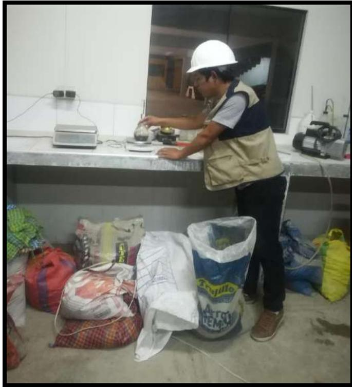
**FOTO N° 12:** Muestra de agregados para la gravedad específica y absorción.
