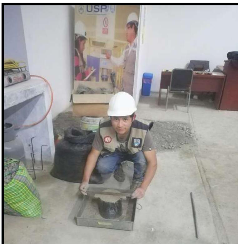
**FOTO N° 09:** Muestra de agregados para la gravedad el peso unitario suelto y compactado.
