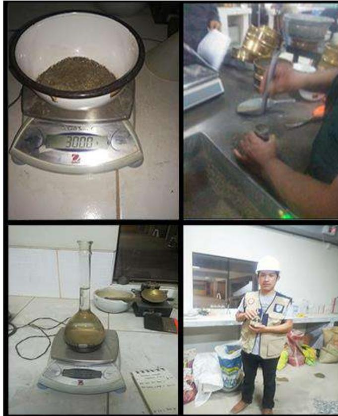
**Figura 7.** Gravedad específica y absorción del agregado fino
