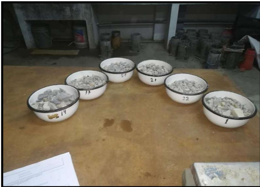
**FOTO N° 05:** Contenido de humedad de los agregados.
