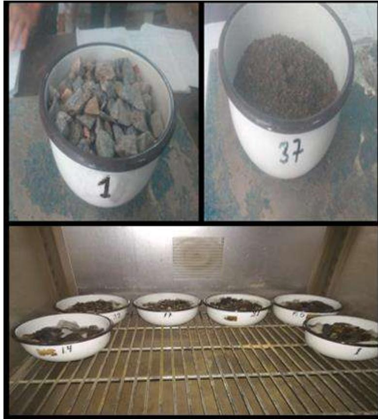
**Figura 5.** Contenido de humedad agregado fino y grueso
