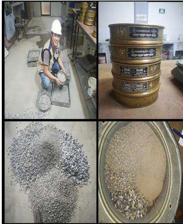
**Figura 6.** Análisis granulométrico del agregado fino y grueso.
