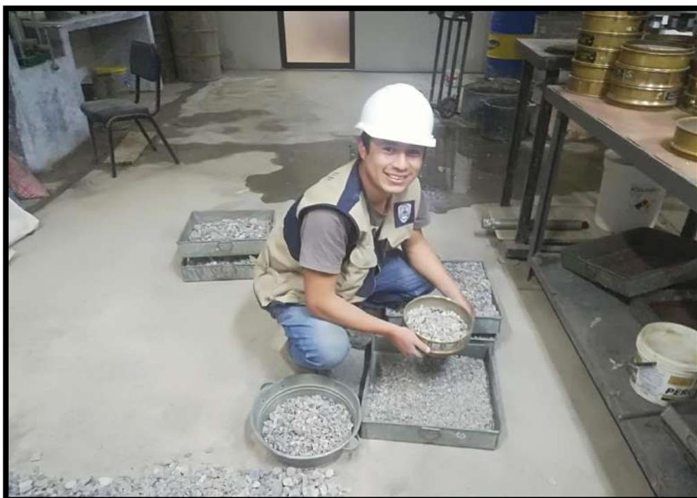
**FOTO N° 08:** Análisis Granulométrico del Agregado Grueso.
