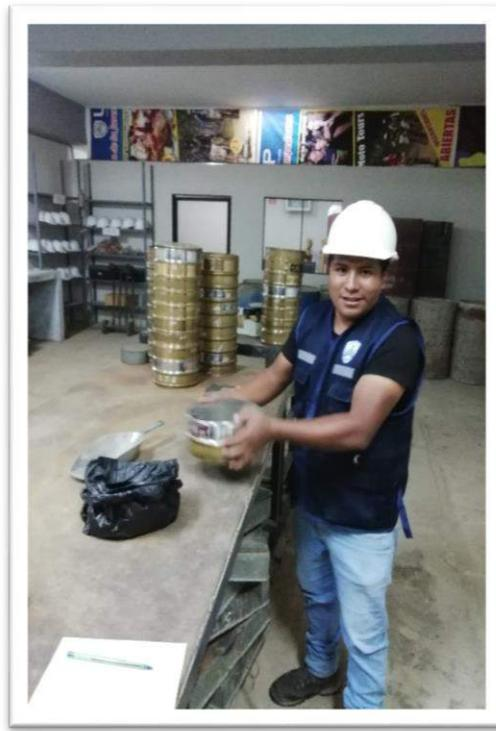
**Figura 46** pasando la malla al agregado fino
