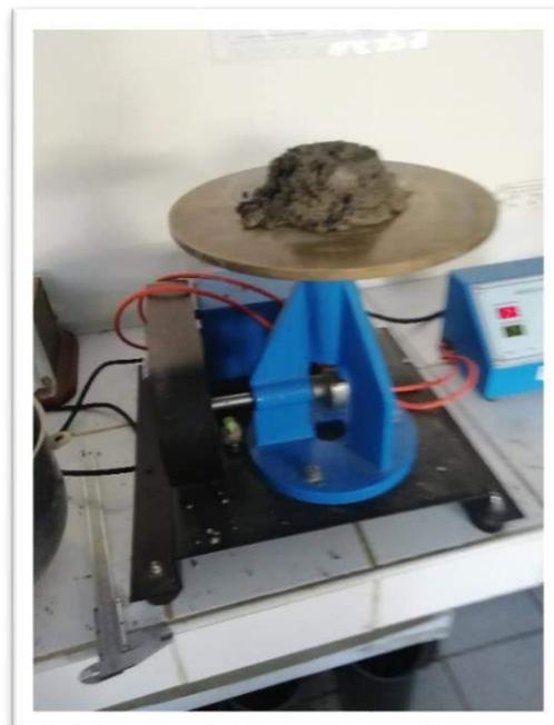
**Figura 46** Ensayo por método de fluidez
