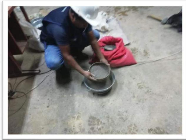
**Figura 43** realizando al Gradación
