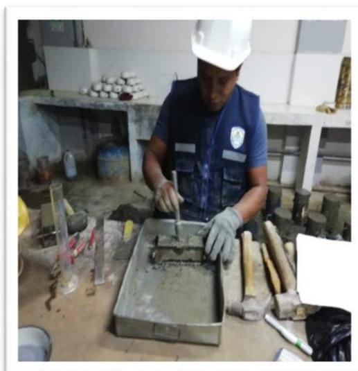
**Figura 30.** Mezclado de los especímenes
