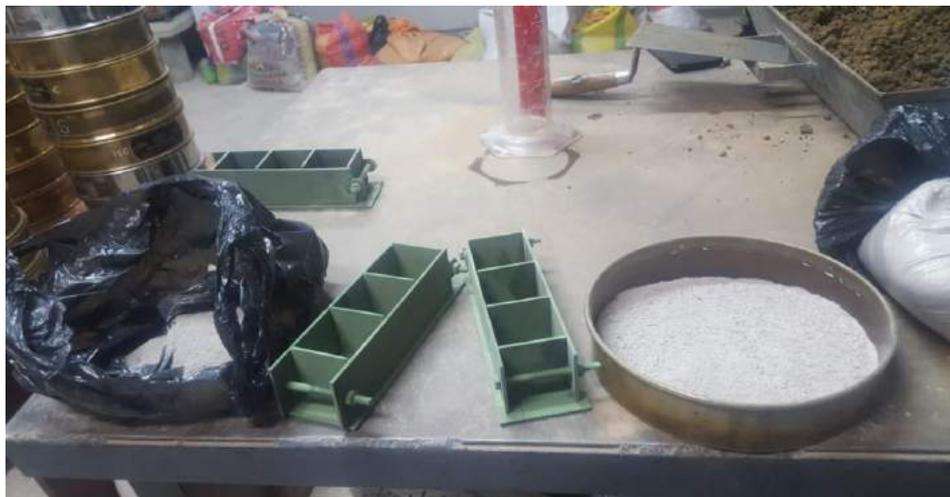
**Figura 23** Molde de metal de 5x5cm para el mortero
