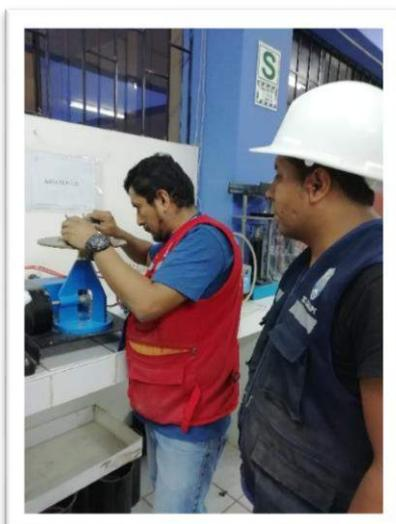
**Figura 36** prueba de ensayo de fluidez
