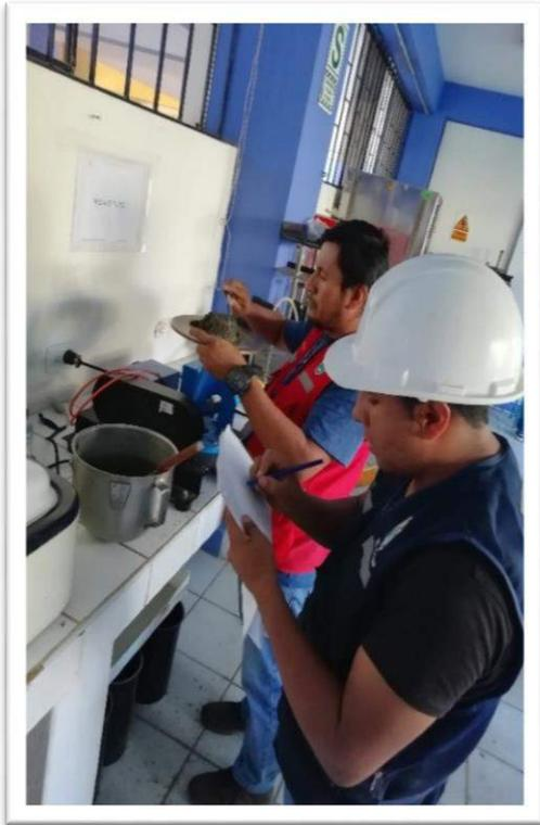
**Figura 45** calculando el resultado de la fluidez
