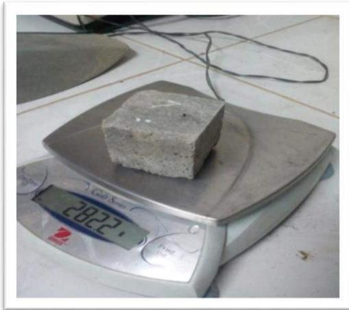
**Figura 34** Peso del Cubo para comprimir
