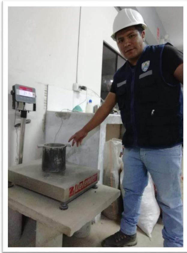
**Figura 19.** *Ensayo del peso unitario*
