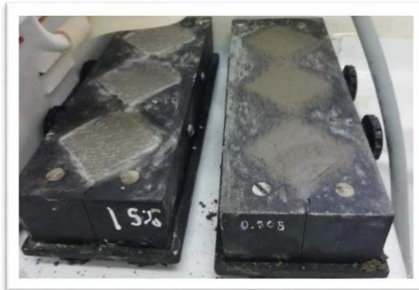
**Figura 44** espécimen moldeado para curado
