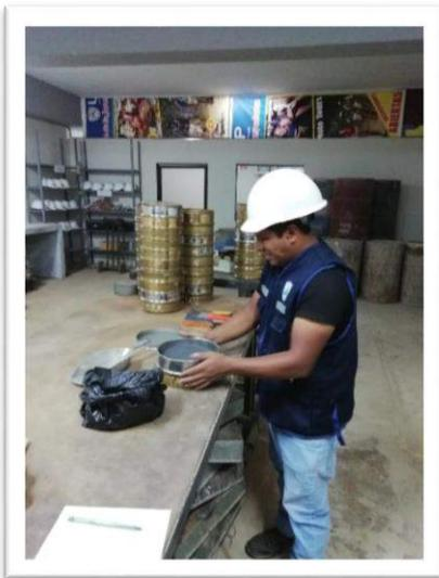
**Figura 26** Pasando la malla N° 200 cenizas
