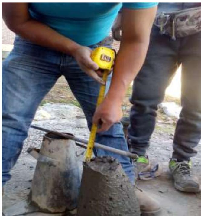
**Figura 49:** Ensayo de asentamiento del concreto “Slump”
