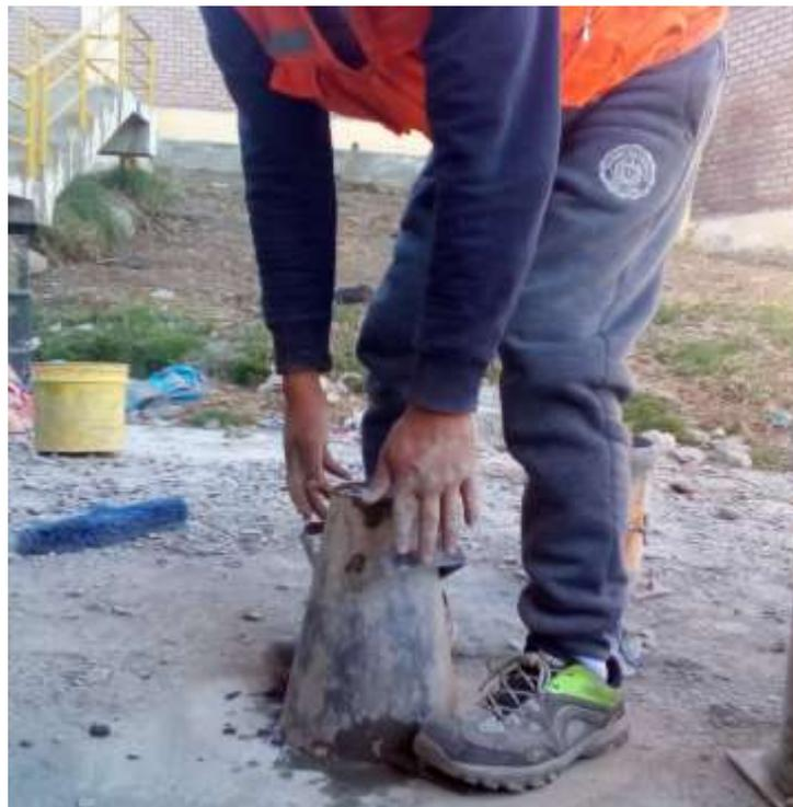
**Figura 48:** Ensayo de asentamiento del concreto “Slump”
