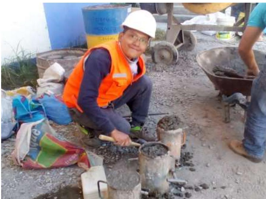
**Figura 50:** Elaboración de las probetas de concreto
