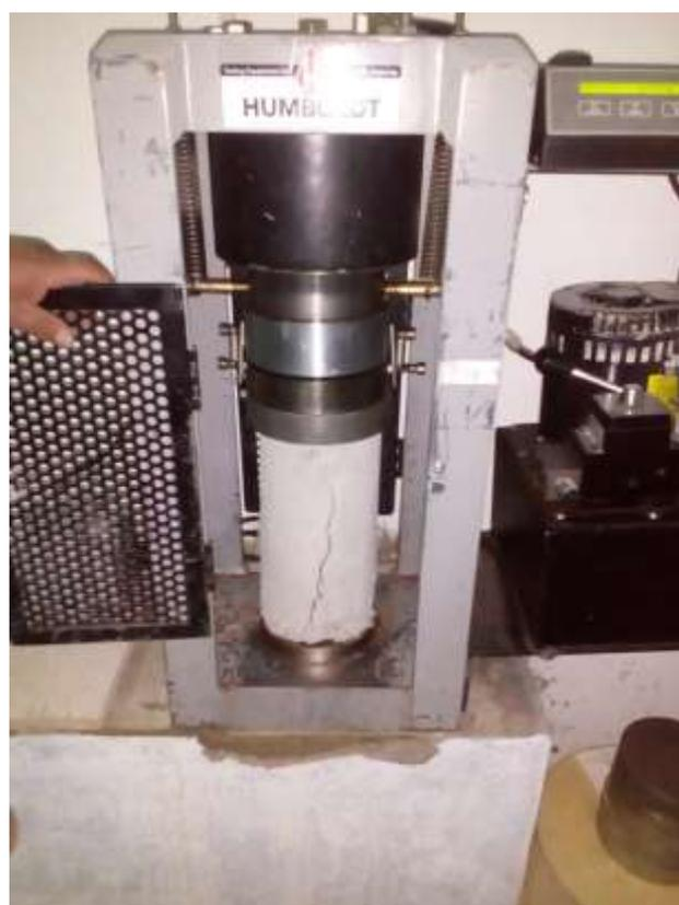
**Figura 52:** Realización de ensayo de resistencia a la compresión del espécimen experimental - Laboratorio de la USP – Huaraz
