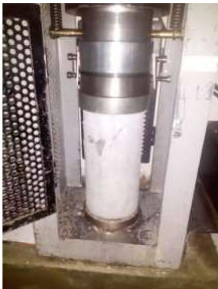
**Figura 51:** Realización de ensayo de resistencia a la compresión espécimen patrón - Laboratorio de la USP – Huaraz
