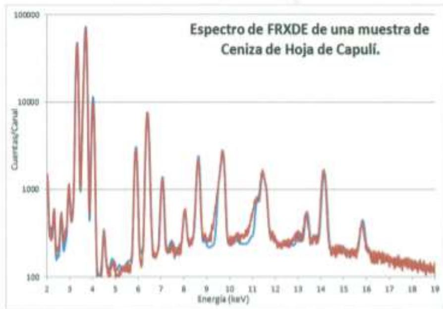
Figura 1. Espectro de FRXDE de una muestra de ceniza de hoja de capulí en escala semi logarítmica. Incluye el pico de Ar del aire y los picos de rayos-X de Au dispersados por la muestra. La curva en azul muestra el espectro simulado
