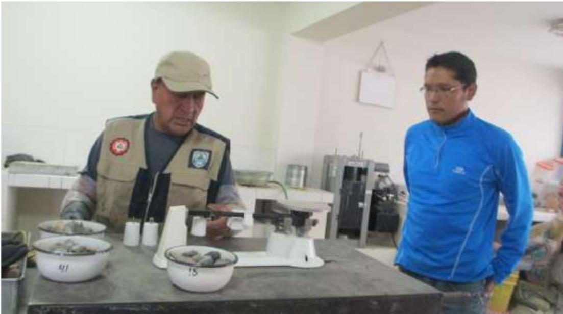
**Figura 46:** Ensayo de Absorción y peso específico de los agregados
