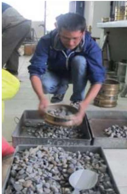
**Figura 44:** Tamizado de los agregados
