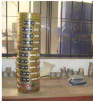
Figura 3: juego de tamices para granulometría
