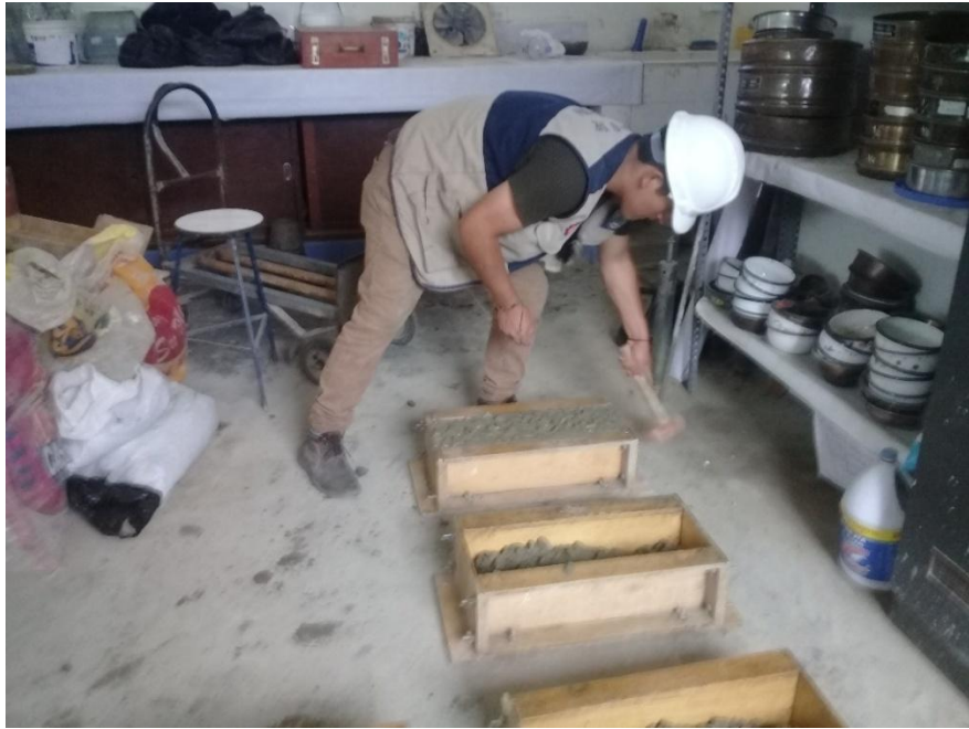
Foto 13: baseado de mezcla 1ra capa
