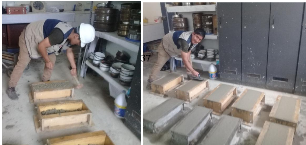
Figura 15. Elaboración de las vigas patrón (9).
