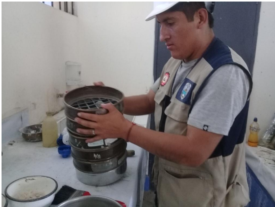
Foto 4: Tamizado de los agregados gruesos
