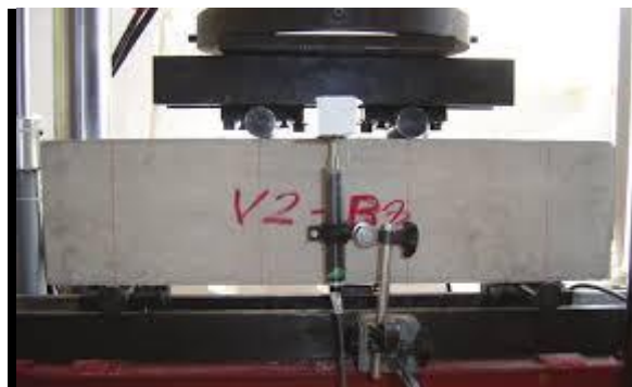
FIGURA1. Flexión de vigas de concreto
