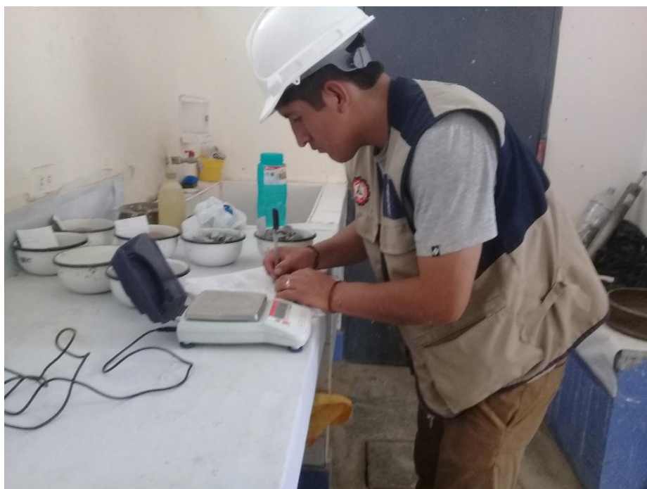
Foto 6: obteniendo datos del agregado grueso para hallar el contenido de humedad.
