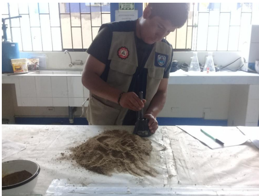
Foto 10: compactación molde cónico
