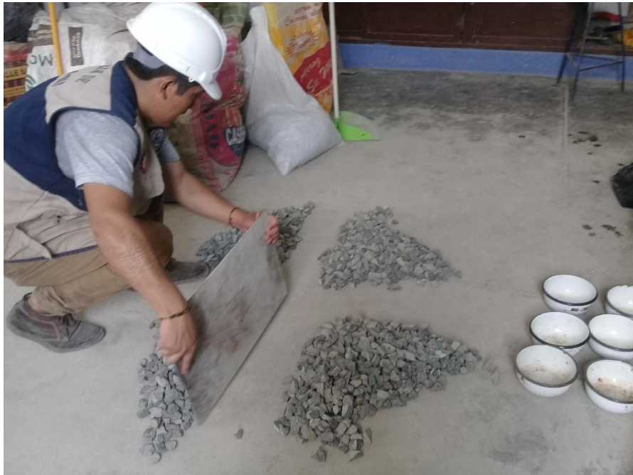
Foto 2: cuarteando el agregado grueso para los ensayos de granulometría
