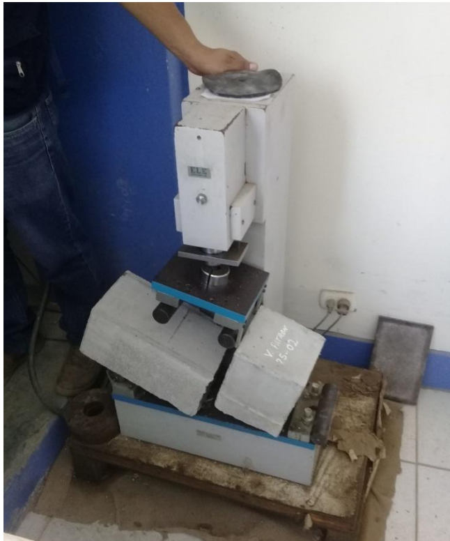
Foto 19: ensayo de rotura viga Patrón 7 días
