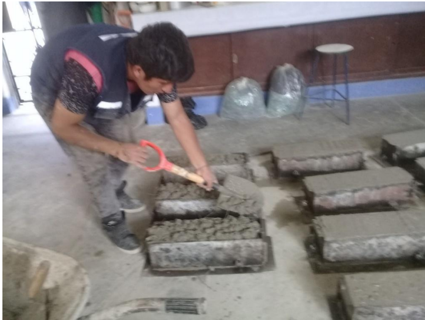
Foto 14: baseado de mezcla 2da capa
