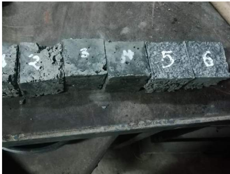
Se realizaron cubitos de 5cm. por 5cm. para laboratorio de conductividad Térmica.
