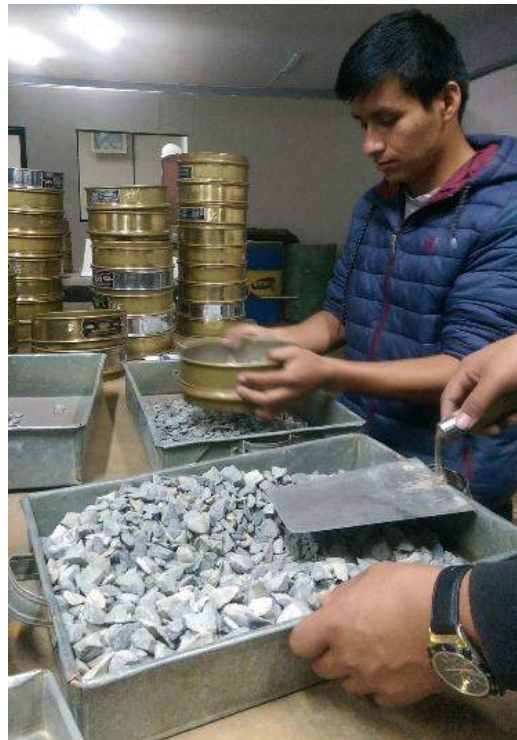
Análisis de los agregados finos y gruesos en el laboratorio de mecánica de suelos y materiales de la USP - Huaraz
