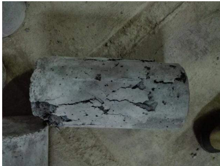
Falla de las muestras después de rotura a compresión.
