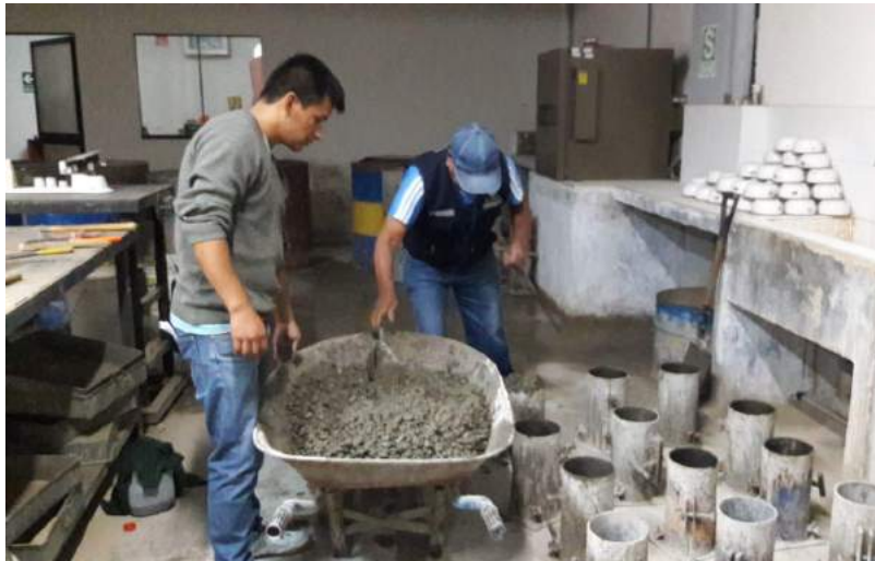
Llenado de los moldes en 3 capas, se realizó 25 chuzadas por cada capa y golpeando con un martillo de goma en el lado exterior del molde para liberar el aire atrapado.
