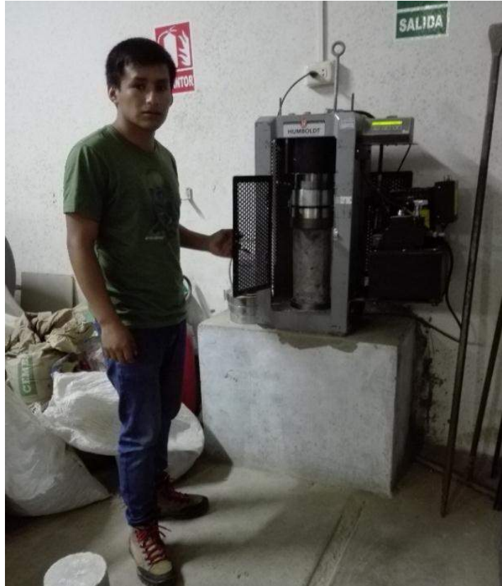
Rotura a compresión de las muestras de concreto en el laboratorio de mecánica de suelos y materiales de la USP – Huaraz.
