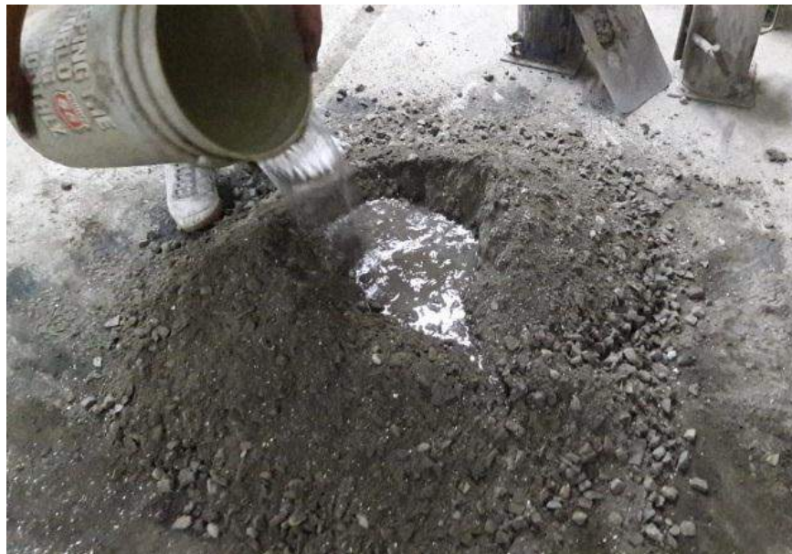
Preparado de la mezcla del concreto, se realizó manualmente con pala en el laboratorio de mecánica de suelos y materiales de la USP.
