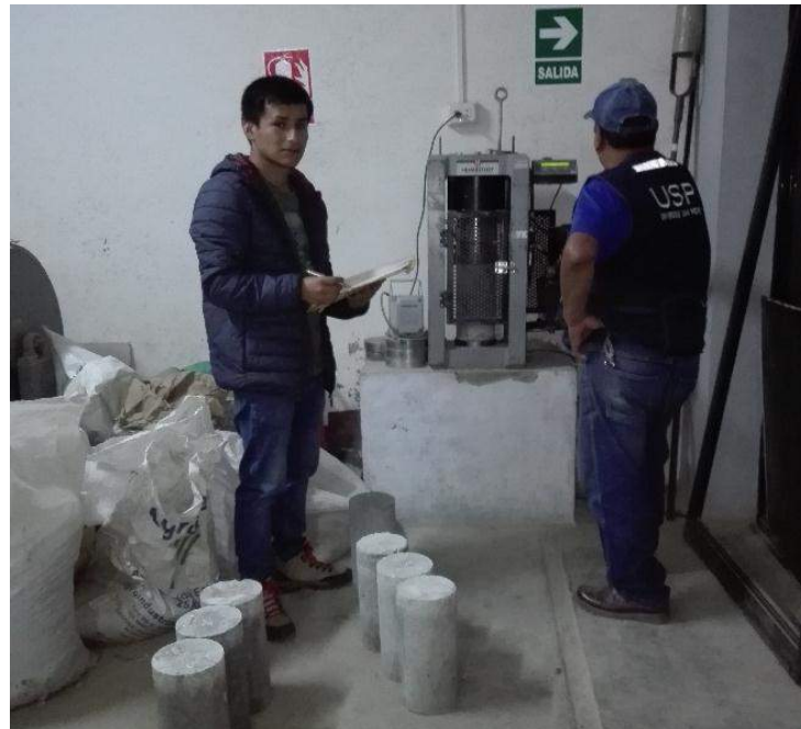
Rotura a compresión de las muestras de concreto en el laboratorio de mecánica de suelos y materiales de la USP – Huaraz.
