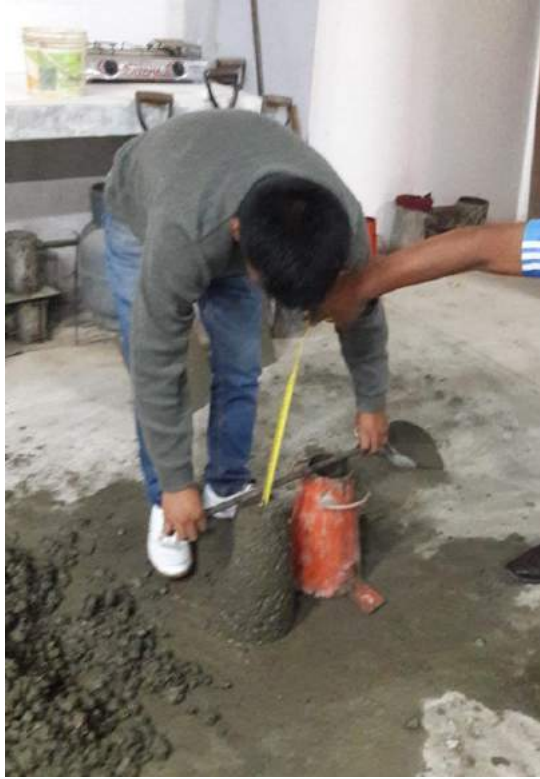
Se realizó ensayo de asentamiento con el cono de Abraham.
