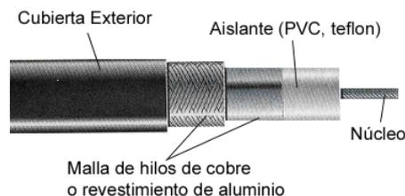
*Figura N° 01: Descripción de las partes del cable coaxial*
