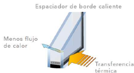
Figura N° 62: Espaciador de borde caliente
