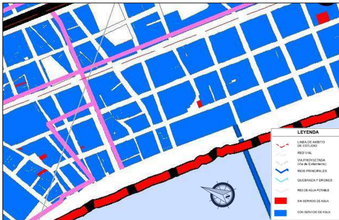
Figura N° 17: Plano cobertura de agua potable de Chimbote.
