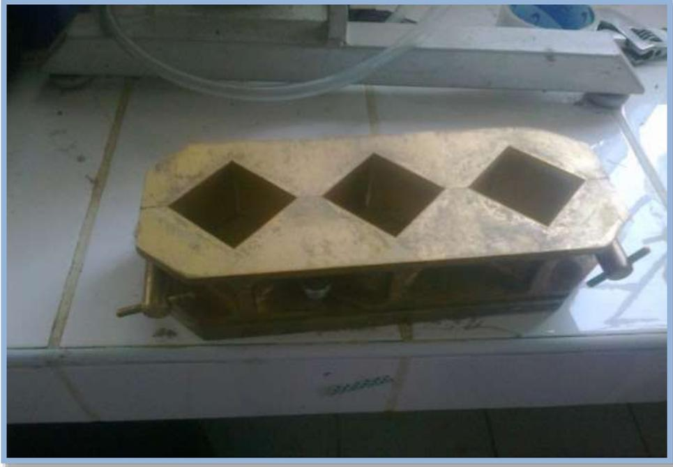
IMAGEN 13: Se encinto los 3 moldes y se procedio a armarlos hasta que ya estaban listas para el vaciado del mortero para la elaboracion de los morteros.
