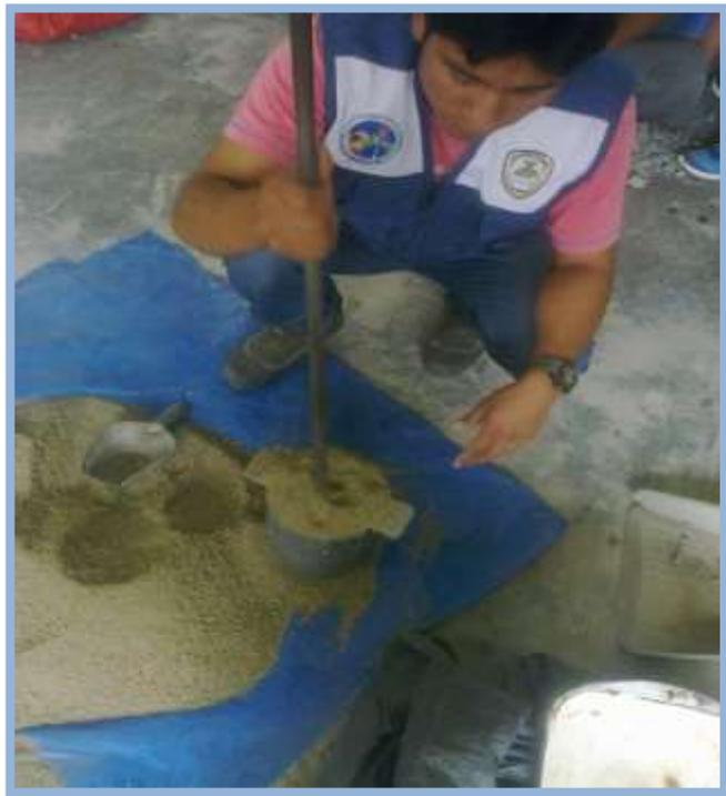
IMAGEN 10: Luego de terminar la tercera capa los 25 golpes con el chuceado del ensayo peso unitario compactado.
