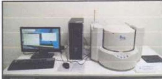
Figura 1. Espectrómetro de Fluorescencia de Rayos X
