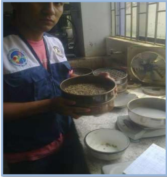
IMAGEN 09: Se puede observar como se tamiza el agregado. Se van pesando el material retenido por los tamizes ,hasta llegar a la malla n°200.
