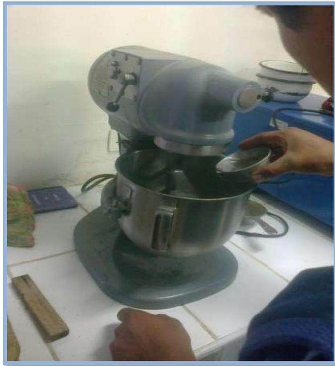
IMAGEN 14: Se observa el proceso de elaboracion de la mecla del mortero.
