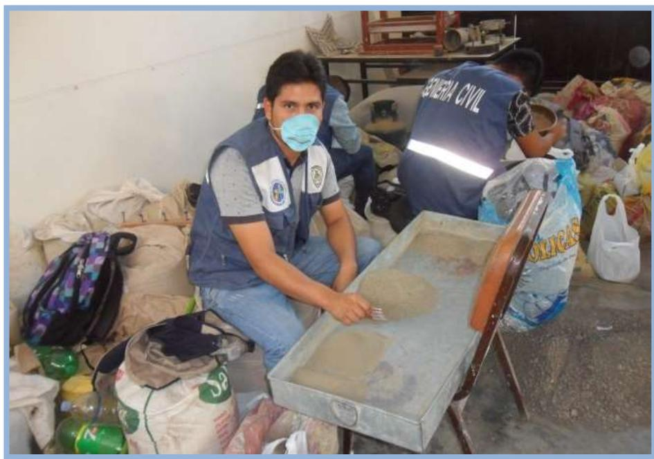
IMAGEN 12: Se observa la mezcla de mi material gradado.
