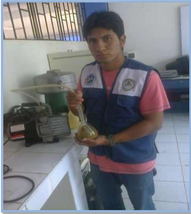
IMAGEN 11: Con la bomba de vacios se succiono el aire que quedo dentro del agregado con el agua en la fiola durante un tiempo de 15min para ensayo de peso especifico.
