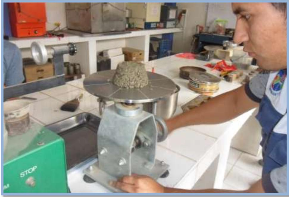
IMAGEN 15: Se realizó el siguiente ensayo para determinar la fluidez del material tanto del patrón como de los experimentales
