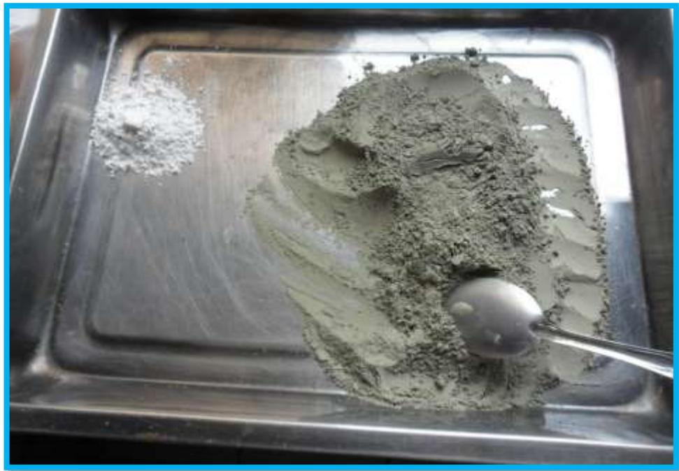
IMAGEN 16: Se mezclan la ceniza de hoja de eucalipto proporcionalmente hasta homogenizar todo el material y después se mezcló el molusco pata de mula.
