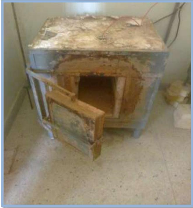
IMAGEN 07: Se llevo a la mufla electrica a calcinarse a 800 °C durante 6 horas en el Laboratorio de Materiales ,Facultad de Ing.Civil –UNT.
