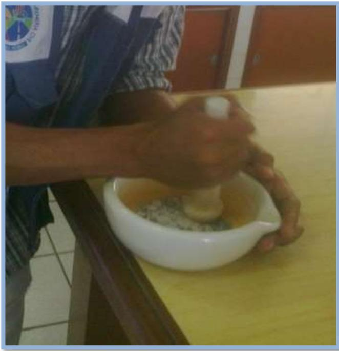
IMAGEN 08: activacion mecanica de el material calcinado en la mufla concha pata de mula .
