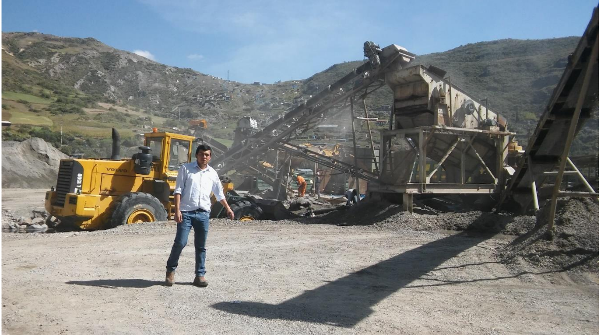
En esta imagen se ve ya la chancadora trabajando para obtener el resultado de los agregados reciclados.
