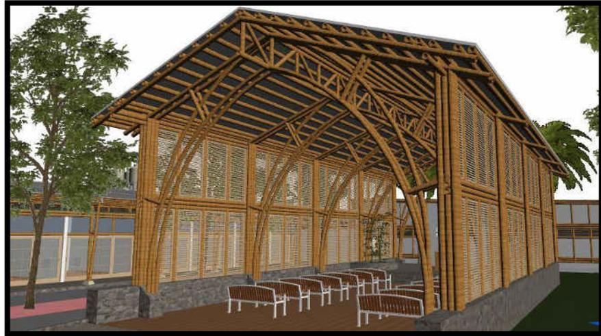
*Figura 113. Arcos de carga de bambú (Capilla).
