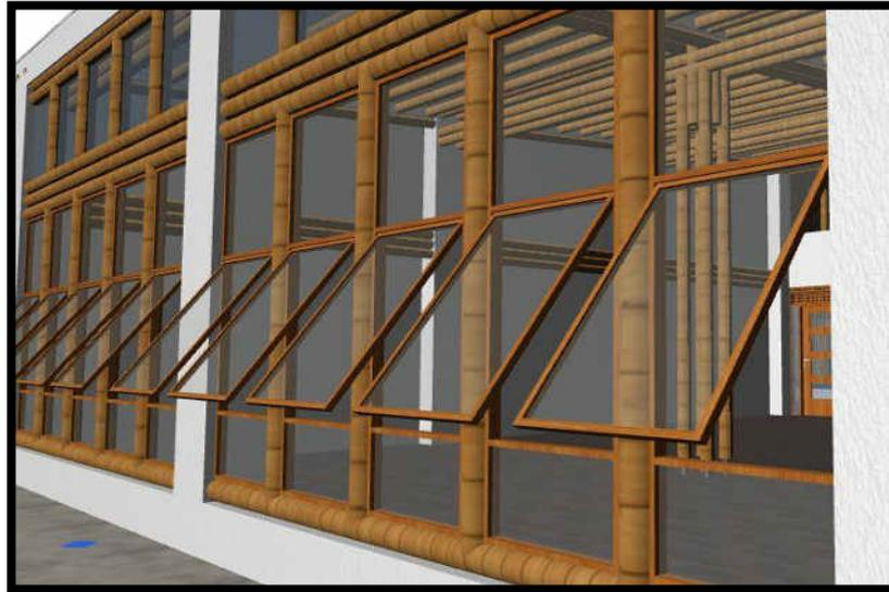
*Figura 109. Vanos y ventanas con apertura saliente (zona de talleres).
