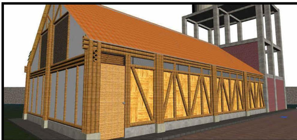
*Figura 100. Muro con estructura expuesta Tipo 2 – Zona de Almacén general.
