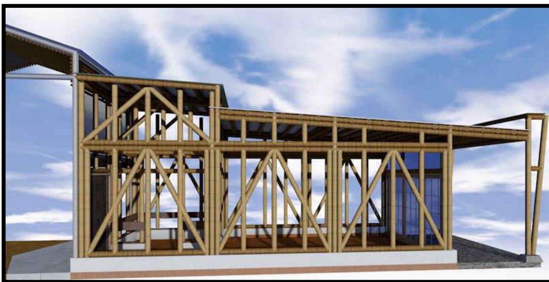
*Figura 98. Estructura de muro portante para módulo de habitaciones – bloque 1 y 2. Proyecto: Centro de atención para el adulto mayor.*
