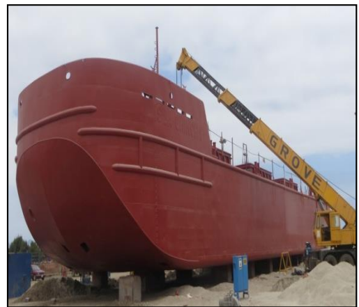
Figura N°18 – Montaje de Caseta Barcaza
