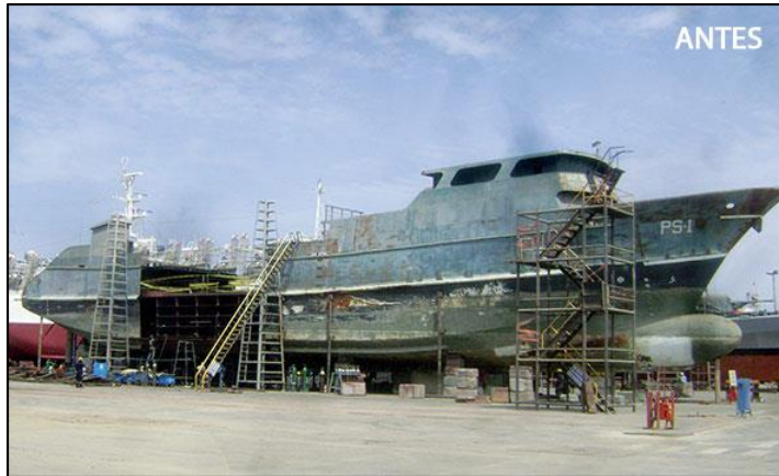
Figura N°20- Corte para inserción Modulo en Bodegas
