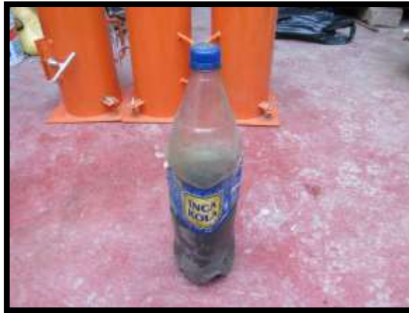
Figura N° 8: Petróleo para los bordes de las probetas antes de vaciar el concreto.
