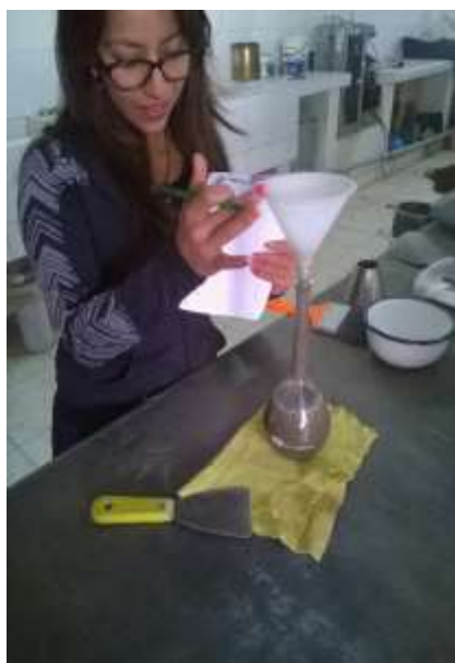
Fotografía 07: ensayo de gravedad específica y absorción.
