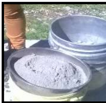
Figura N° 9 Cemento empleado en Obra (Portland tipo I).
