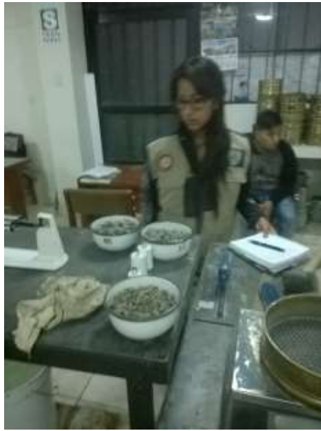
Fotografía 09: Halle el peso saturado y lleve la muestra al horno por 24 horas. Saque la muestra del horno y deje enfriar de 1 a 3 horas. Pesamos la muestra para hallar el peso seco final.
