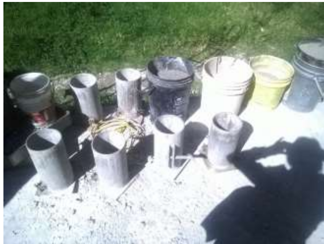
Fotografía 13: materiales listos, probetas, Ag. Fino, Ag. Grueso, cemento y agua potable.
