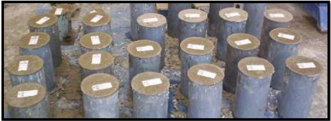
Figura N° 17: Luego de fraguado se procedió a realizar el curado
