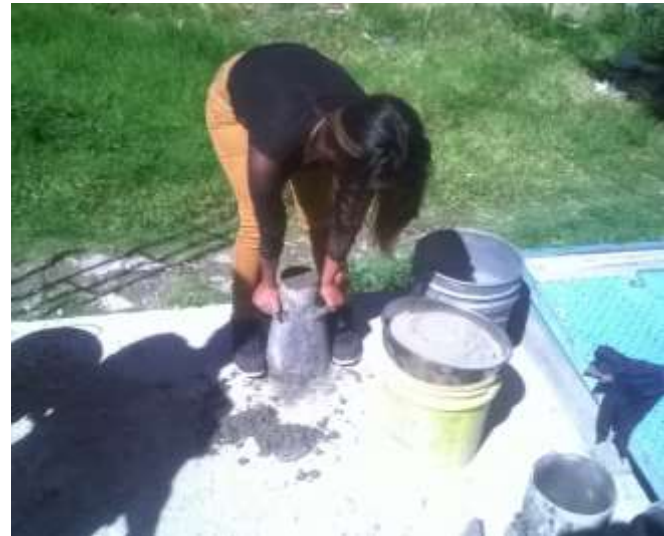
Fotografía 12: realizando la prueba de revenimiento.
