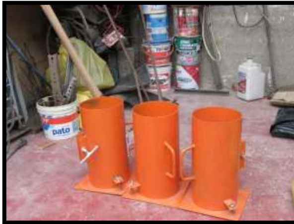
Figura N° 7: Probetas estandarizadas para muestreo de concreto.
