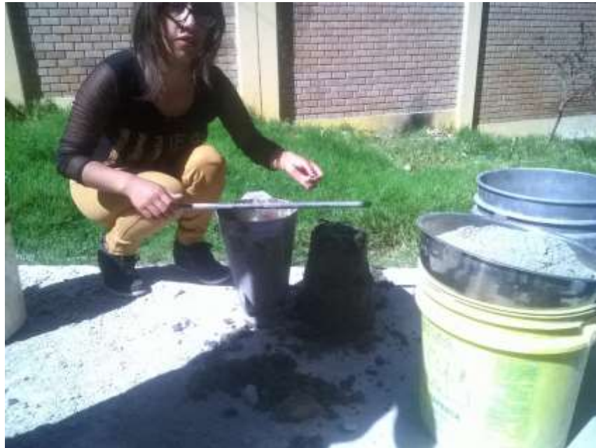
Figura N° 15: Midiendo el Slump
