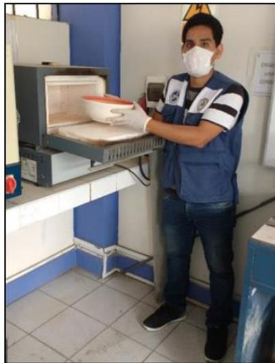
FOTO N° 7: Retirado de la mufla después de la calcinación
