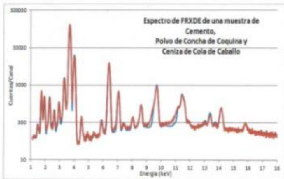
Figura 1. Espectro de FRXDE de una mezcla de cemento con polvo de concha de coquina (12%) y ceniza de cola de caballo (36%) en escala semi logarítmica. Incluye el pico de Ar del aire y los picos de rayos-X de Au dispersados por la muestra. La curva en azul muestra el espectro simulado
