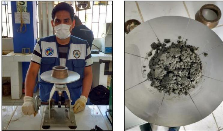
FOTO N° 24: Realización de la fluidez del mortero patrón y experimental.
