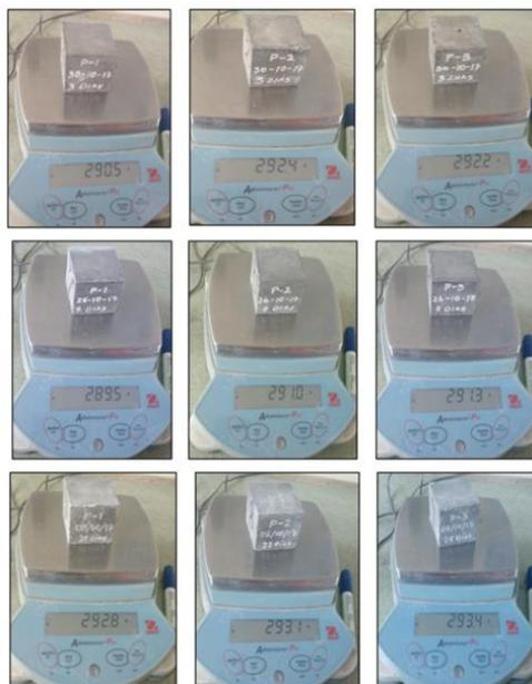
FOTO N° 26: Pesos de especímenes de mortero patrón antes de ensayar.
