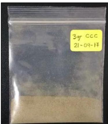
FOTO N°4: Muestra, molida y tamizada por la malla N° 200 para realizar el ensayo análisis térmico diferencial.
