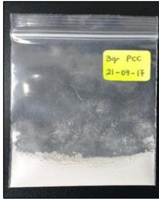
FOTO N° 12: Muestra, molida y tamizada por la malla N° 200 para realizar el ensayo análisis térmico diferencial.
