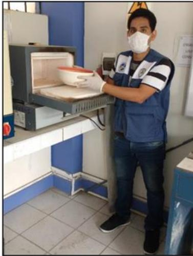
FOTO N° 13: retirado de la mufla después de calcinar la muestra coquina
