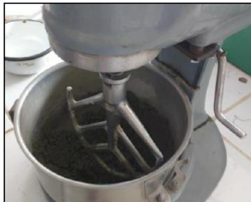
FOTO N° 23: Elaboración de los especímenes mortero patrón y experimental.
