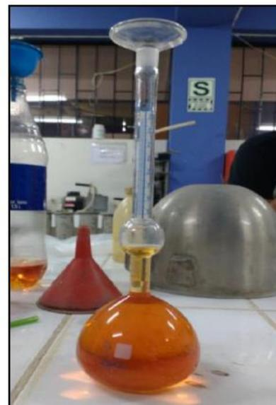
FOTO N° 20: Ensayo de peso específico
