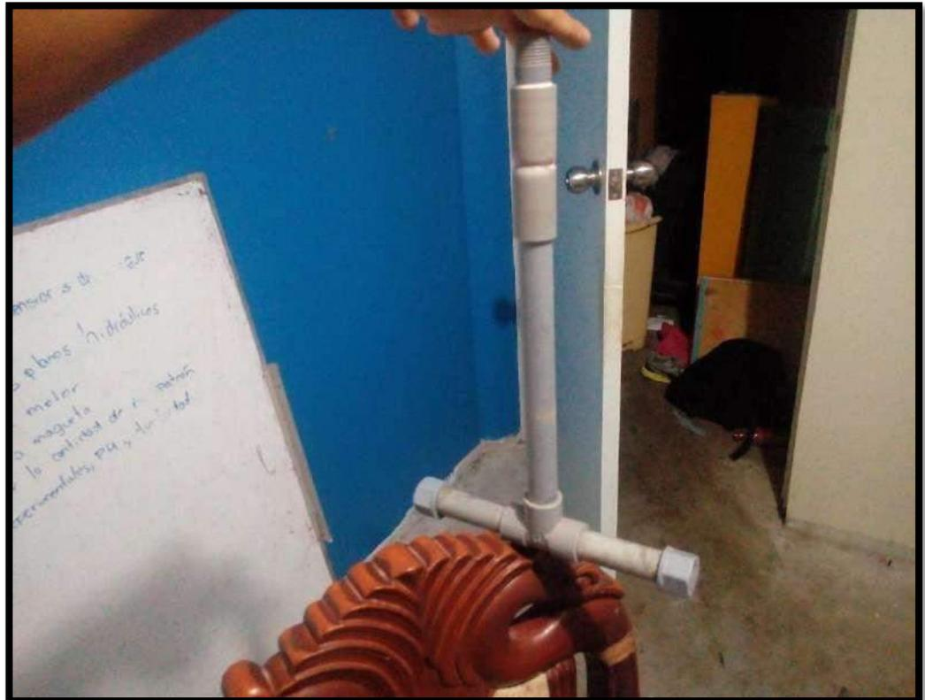
**Figura N°29.** Tubería en forma de T que gira a revoluciones por minuto al conectarse al engranaje del motor.
