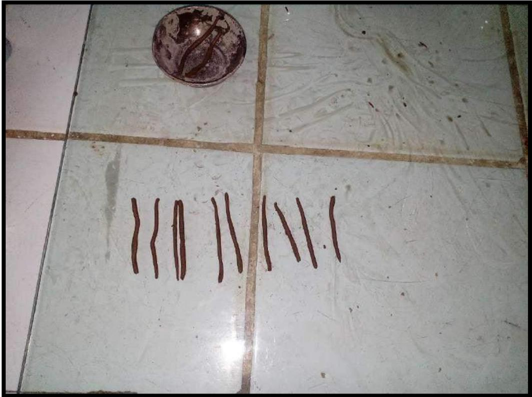
**Figura N°44.** Límite plástico de muestra de calicata C-01.
