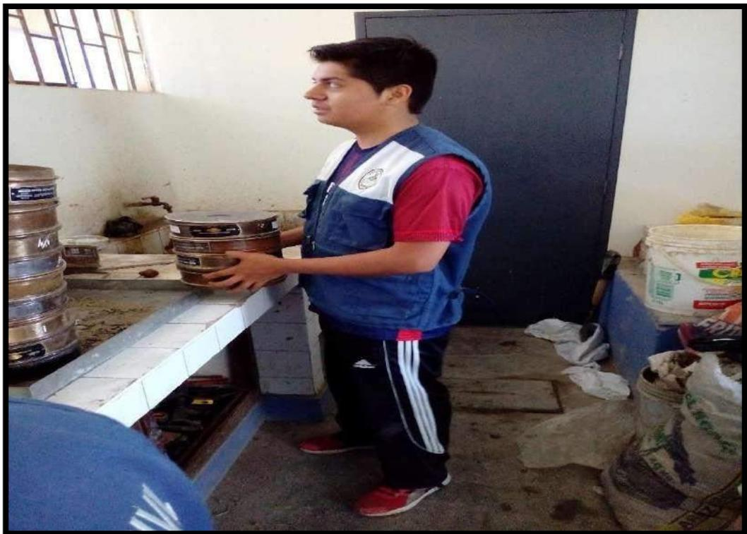
**Figura N°41.** Granulometría de la muestra de Calicata C-01.
