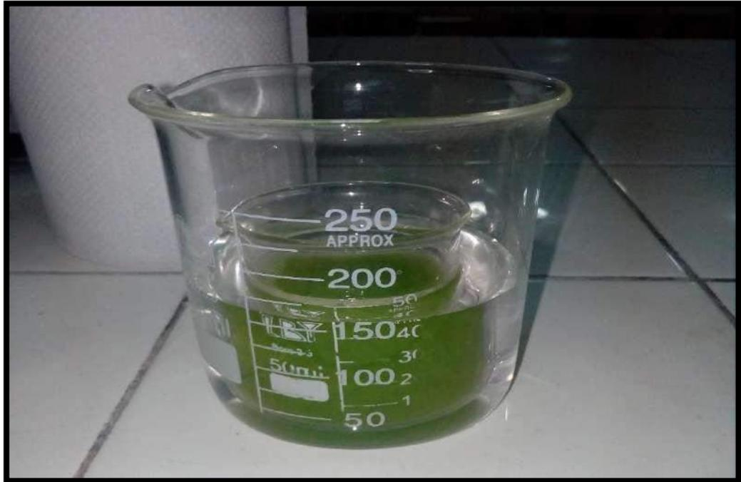
**Figura N°22.** Mucílago de tuna almacenado en un recipiente con agua para el baño María a 80°C.
