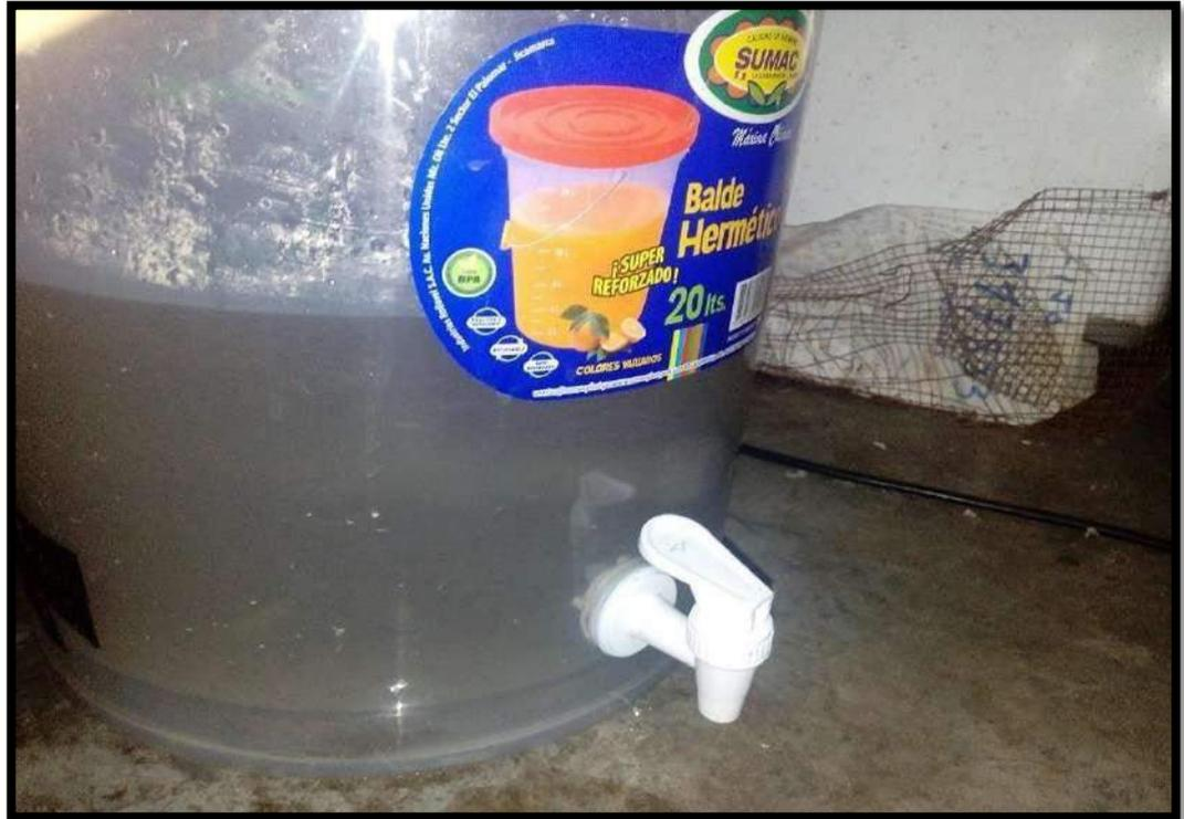
**Figura N°32.** Grifo que se utiliza para la limpieza del biofiltro prototipo.
