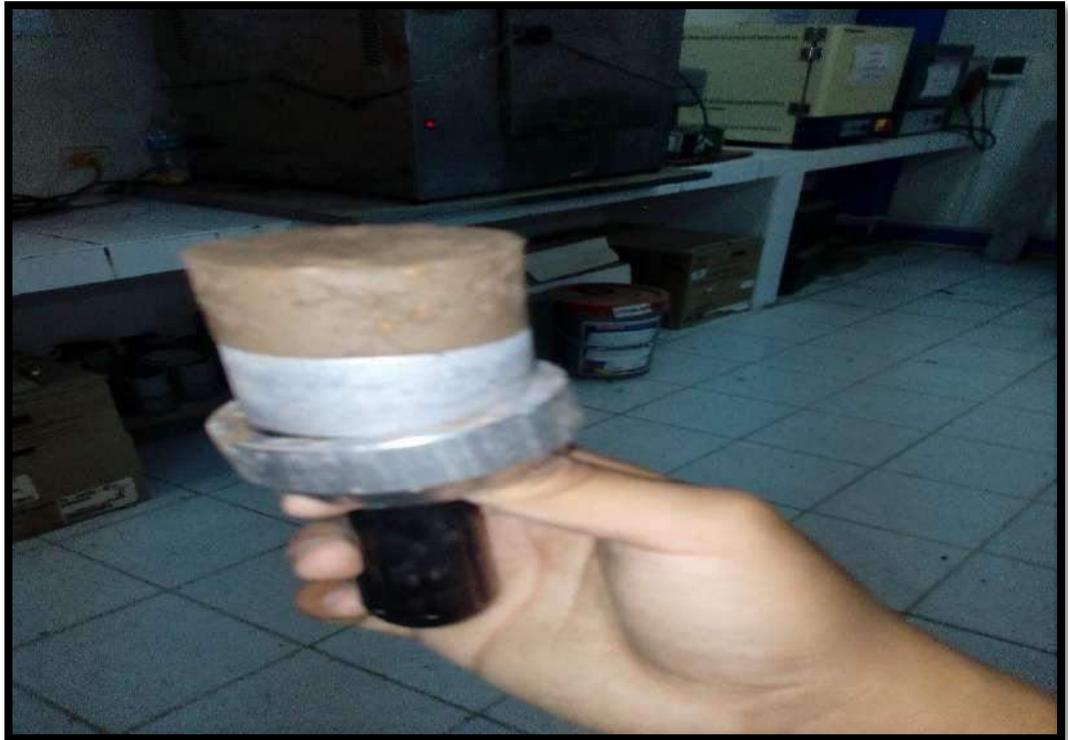
**Figura N°42.** Ensayo de corte directo de la muestra de calicata C-01.
