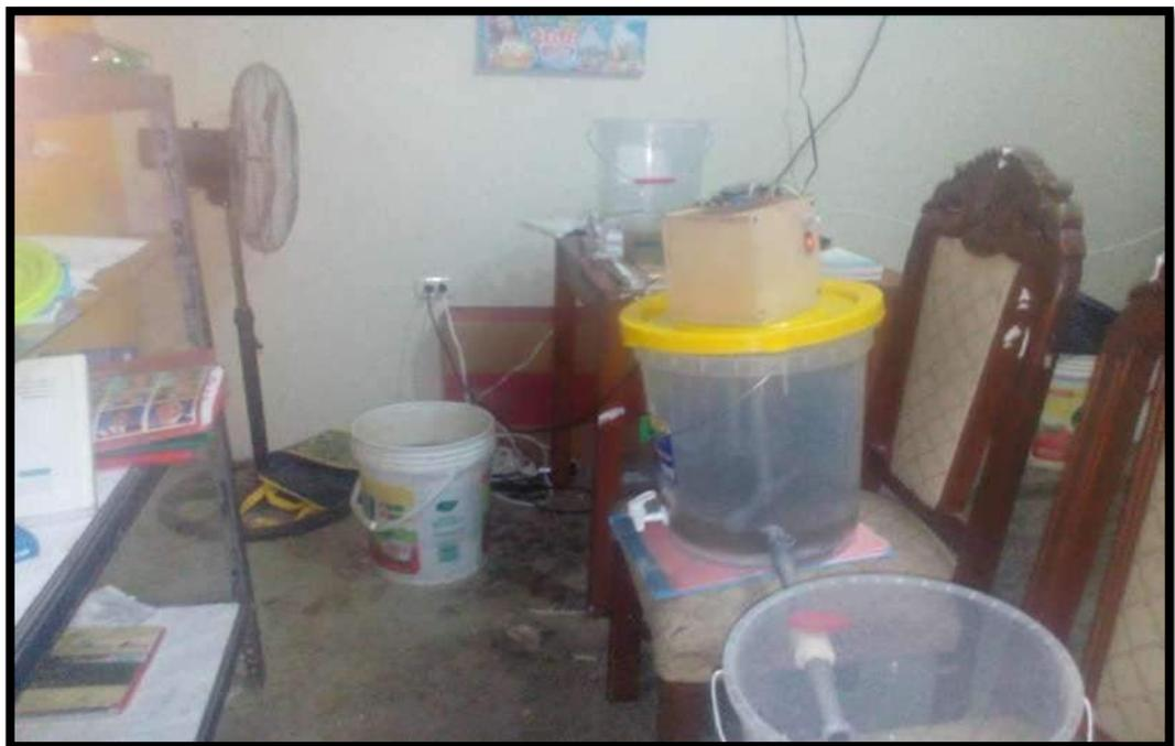
**Figura N°33.** Sistema de biofiltro siendo probado para ver si existe alguna fuga de agua.
