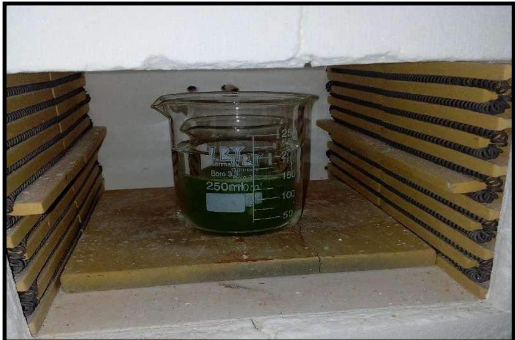
**Figura N°23.** Mucílago de tuna almacenado en un recipiente con agua para el baño María a 100°C en mufla por 12 minutos.
