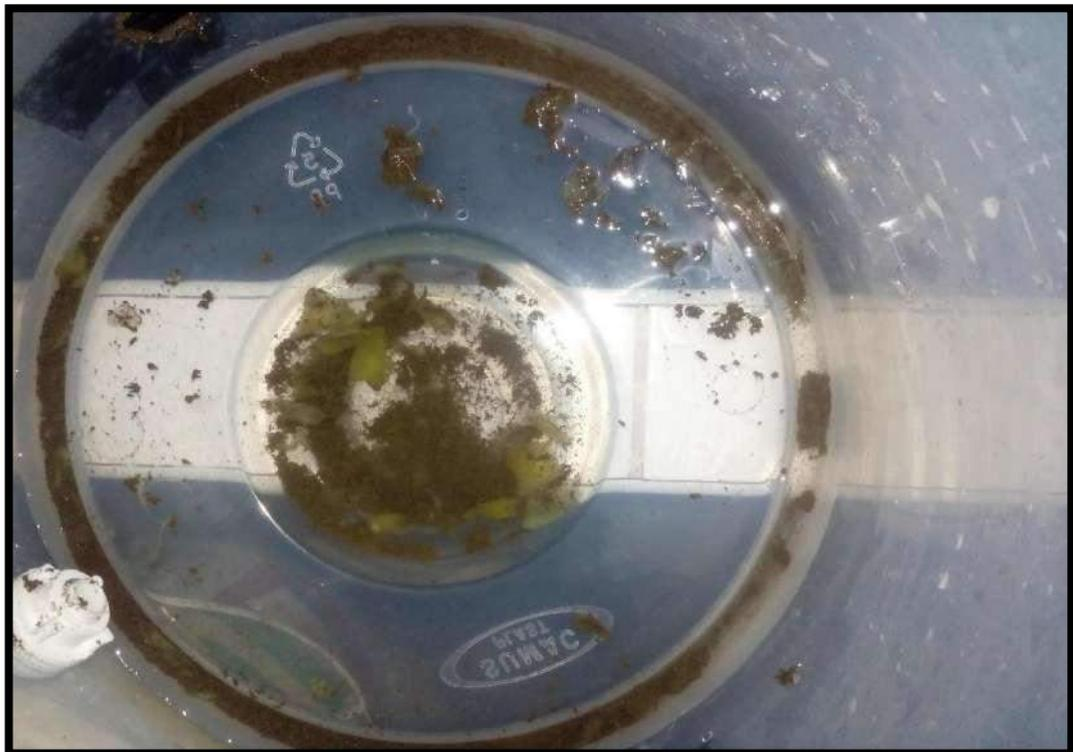
**Figura N°45.** Adsorción de coloides en el fondo del biofiltro prototipo.
