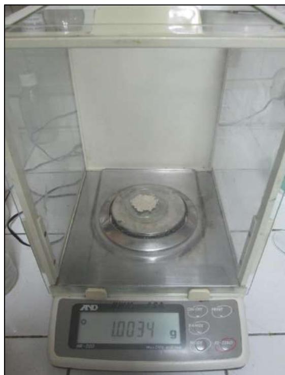
Foto N° 49: Pesamos 1 gramo del Compuesto en Polvo sin activar En proporciones 1:1:1 y 2:1:1. Para aplicar en los vasos de 500ml que estarán con agua de la laguna los Ángeles – Quiruvilca. En el equipo de juego de jarras de la USP.
