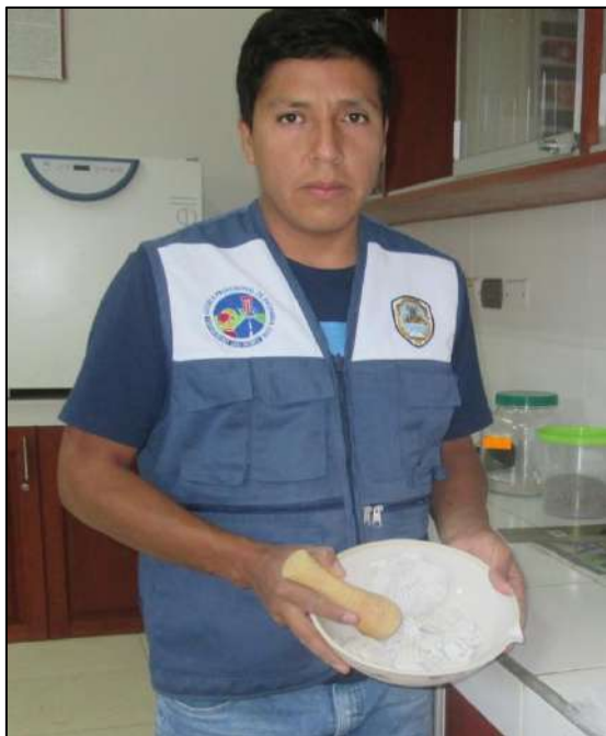
Foto N° 31: Molienda de la Concha de Abanico Activada y pasado por la tela organza. Para ayudarnos en el momento de tamizar por la malla N° 200.
