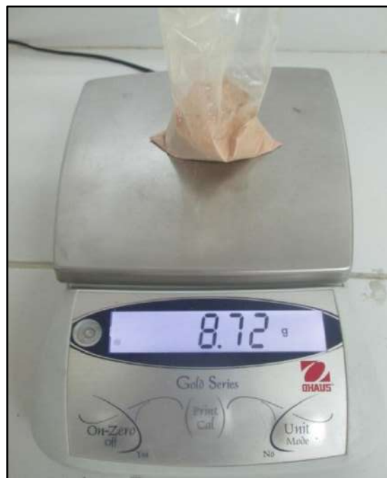
Foto N° 33: Pesado de materiales listos para el ensayo de FLUORESCENCIA DE RAYOS X
