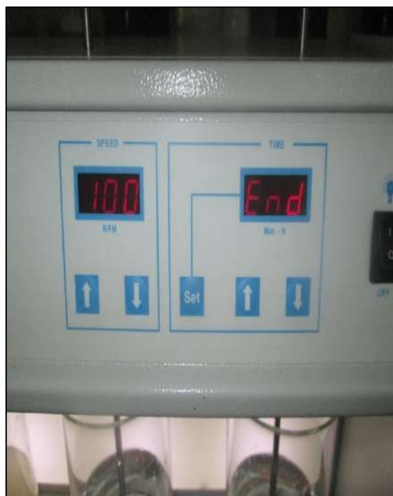
Foto N° 55: Empezamos con la primera corrida de 100 rpm por 2 minutos para remover de manera rápida el material
