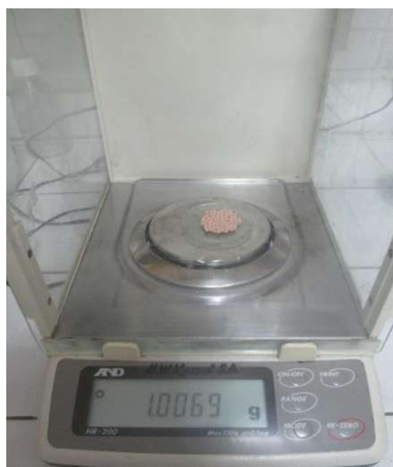
Foto N° 50: Pesamos 1 gramo del Híbrido activado en esferas de 2mm en proporciones 1:1:1 y 2:1:1. Para aplicar en los vasos de 500ml que estarán con agua de la laguna los Ángeles – Quiruvilca. En el equipo de juego de jarras de la USP.
