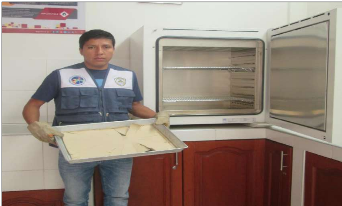
Foto N° 12: Retiramos la Arcilla secada por 24 horas en el horno, Observamos que la Arcilla adquirió la forma de galletas.
