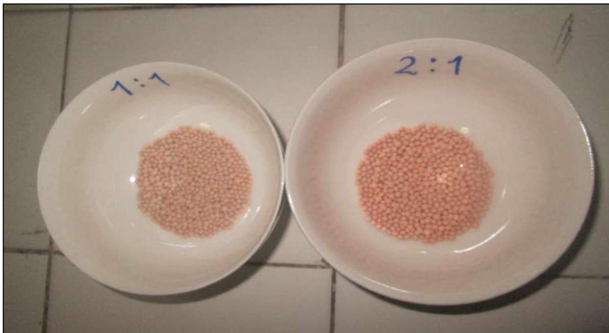
Foto N° 47: El Híbrido en esferas de 2mm. En proporciones 1:1:1 y 2:1:1. Activados Térmicamente, podemos observar como cambio su color
