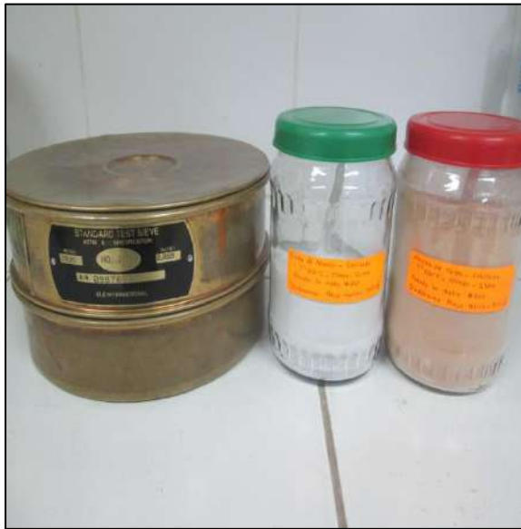
Foto N° 35: Materiales listos, usamos una balanza y un vaso de 50ml donde pesaremos nuestros materiales pero solo usaremos el volumen de 20ml para cada material
