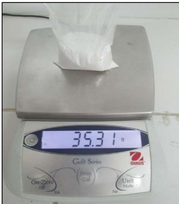
Foto N° 33: Pesado de materiales listos para el ensayo de FLUORESCENCIA DE RAYOS X
