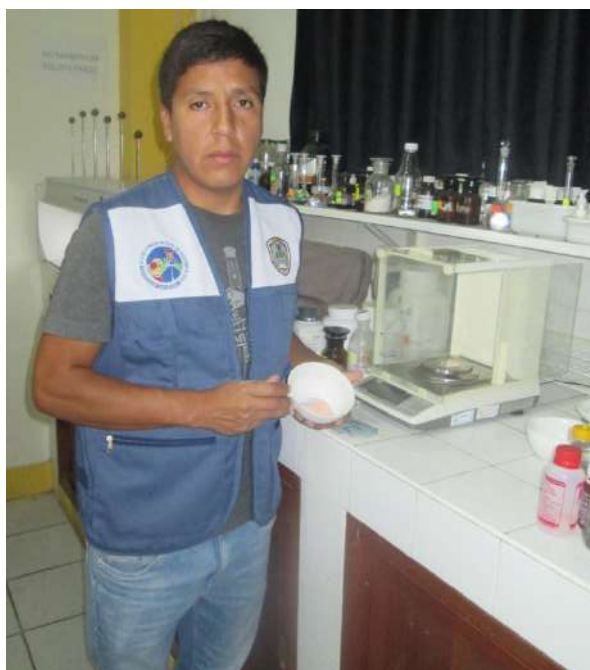
Foto N° 50: Pesamos 1 gramo del Híbrido activado en esferas de 2mm en proporciones 1:1:1 y 2:1:1. Para aplicar en los vasos de 500ml que estarán con agua de la laguna los Ángeles – Quiruvilca. En el equipo de juego de jarras de la USP.
