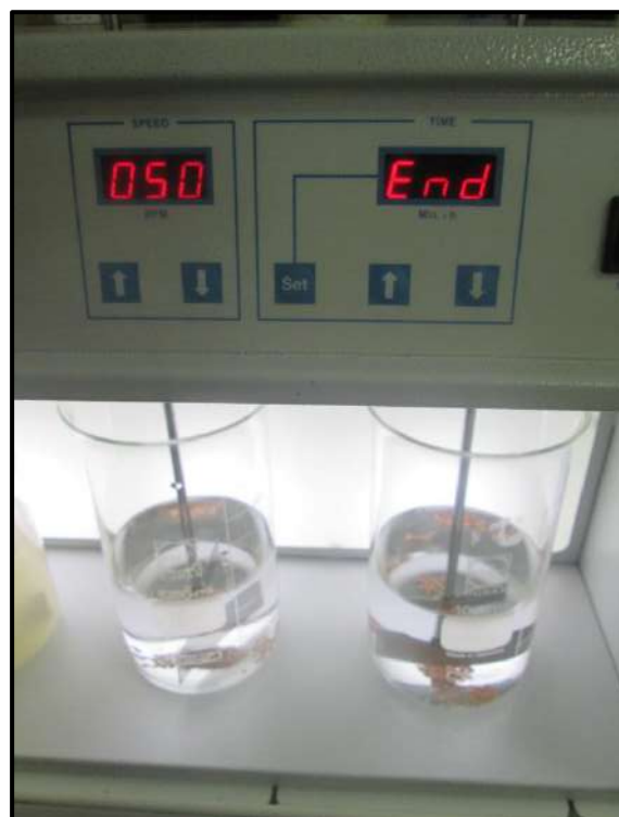
Foto N° 56: Empezamos con la segunda corrida de 50 rpm por 15 minutos para homogenizar las soluciones
