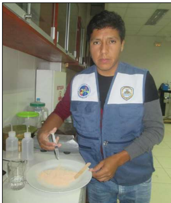
Foto N°40: Una vez que la mezcla este completamente uniforme, Agregamos agua destilada en relación al Índice de Plasticidad de la arcilla para las diferentes proporciones a utilizar.
