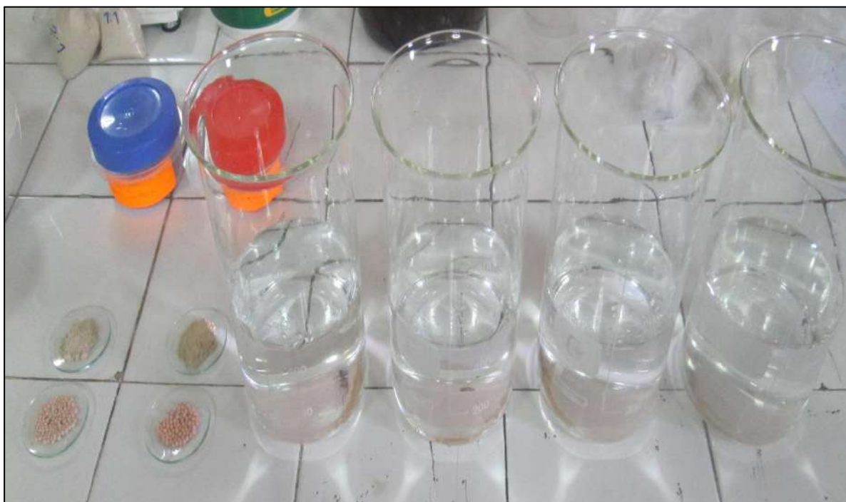
Foto N° 52: Llenamos Agua de la Laguna Los Ángeles – Quiruvilca en cada vaso, solo 500ml de agua para luego aplicar el compuesto
