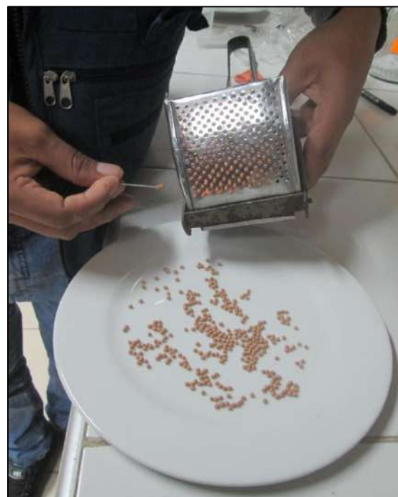
Foto N° 42: Presionamos la prensa papas poco a poco, hasta ver salir el material y con la ayuda de una aguja retiramos, para con la ayuda de la yema de nuestros dedos formar las esferas de 2mm
