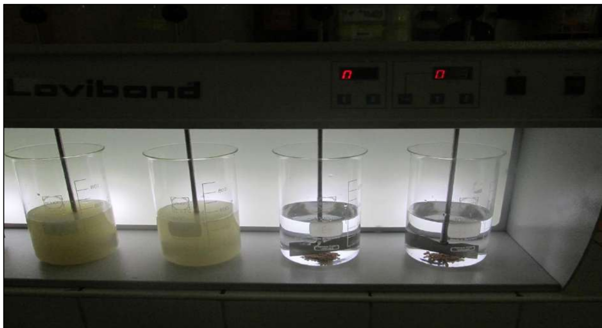
Foto N° 57: Después de las 2 corridas, damos comienzo al reposo para que los sólidos se precipiten (decanen)
