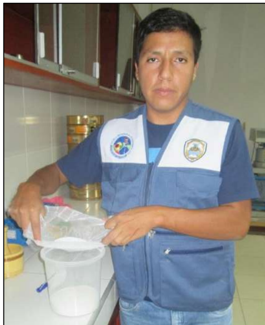
Foto N° 31: Molienda de la Concha de Abanico Activada y pasado por la tela organza. Para ayudarnos en el momento de tamizar por la malla N° 200.
