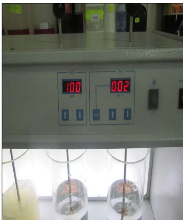
Foto N° 55: Empezamos con la primera corrida de 100 rpm por 2 minutos para remover de manera rápida el material
