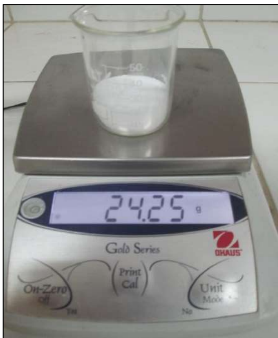
Foto N° 37: Pesamos de la Concha de Abanico, empleamos un vaso de 50ml pero solo medimos 20ml de material y lo pesamos
