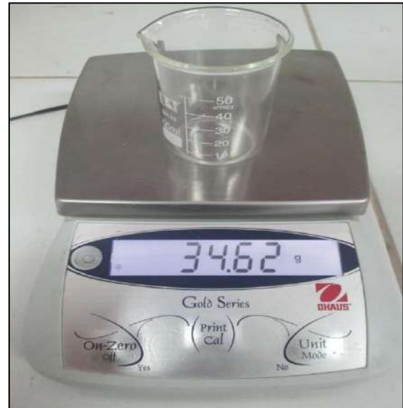
Foto N° 35: Materiales listos, usamos una balanza y un vaso de 50ml donde pesaremos nuestros materiales pero solo usaremos el volumen de 20ml para cada material
