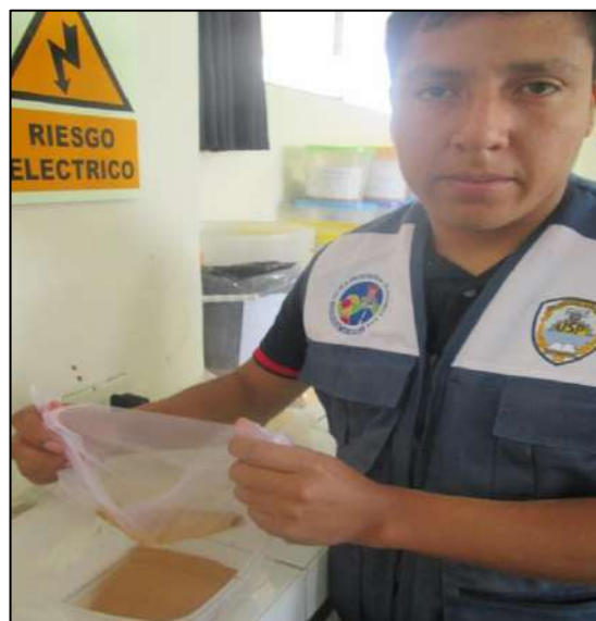
Foto N° 29: Molienda de la Arcilla Activada y pasado por la tela organza. Para ayudarnos en el momento de tamizar por la malla N° 200.
