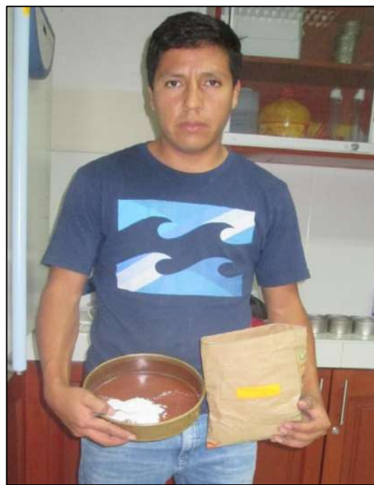
Foto N° 32: Concha de Abanico tamizada por la malla N° 200 y depositado en las bolsas de papel para que no adquiera humedad y este conservado.
