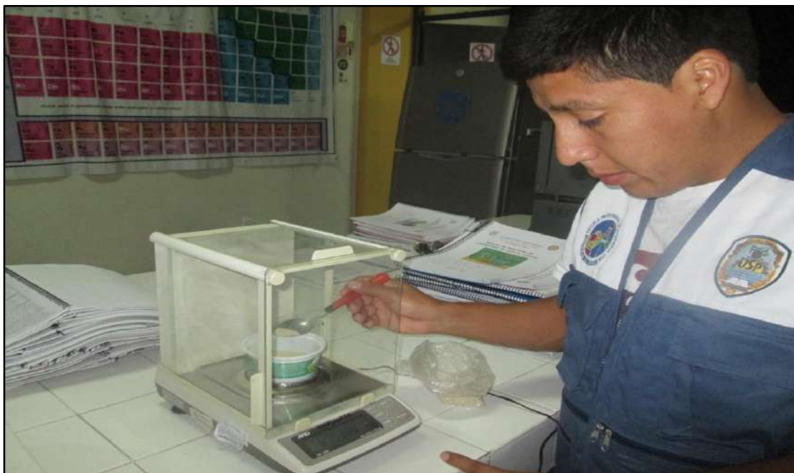
Foto N° 25: pesado de los materiales antes de su calcinación
