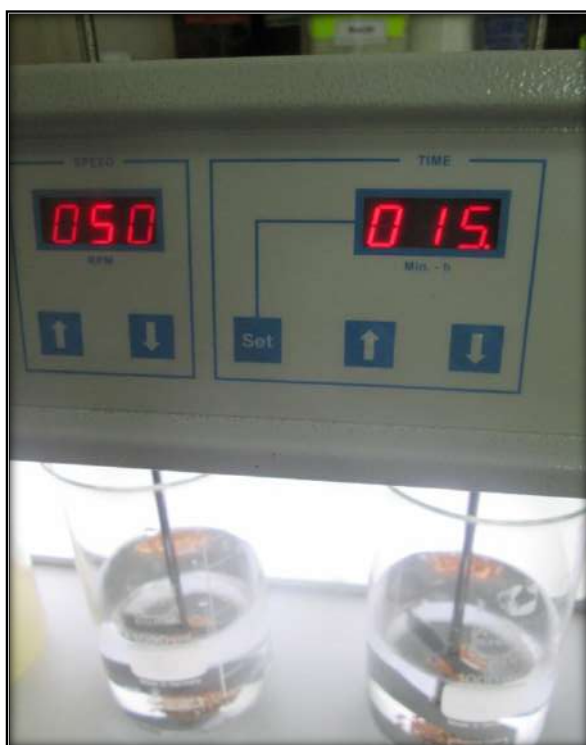
Foto N° 56: Empezamos con la segunda corrida de 50 rpm por 15 minutos para homogenizar las soluciones
