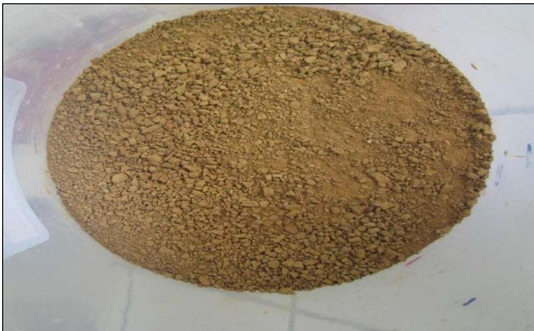
Foto N° 07: Arcilla Natural Pulverizada en mortero antes de lavarlo
