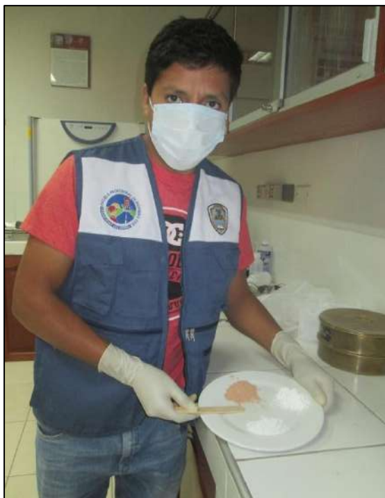
Foto N° 39: Después de pesar, pasamos a mezclar los 3 materiales de manera uniforme. Según la proporción que vamos a utilizar, en esta imagen apreciamos la proporción 1:1:1 Arcilla: Concha de Abanico: Maicena
