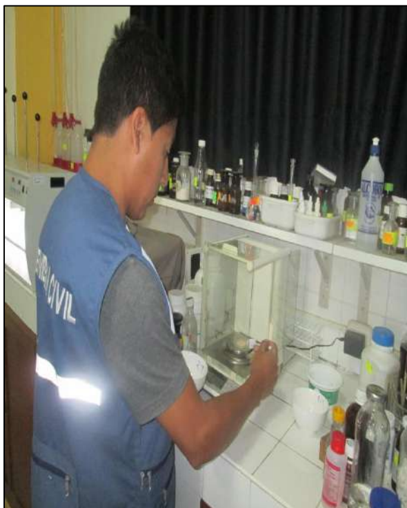
Foto N° 49: Pesamos 1 gramo del Compuesto en Polvo sin activar En proporciones 1:1:1 y 2:1:1. Para aplicar en los vasos de 500ml que estarán con agua de la laguna los Ángeles – Quiruvilca. En el equipo de juego de jarras de la USP.
