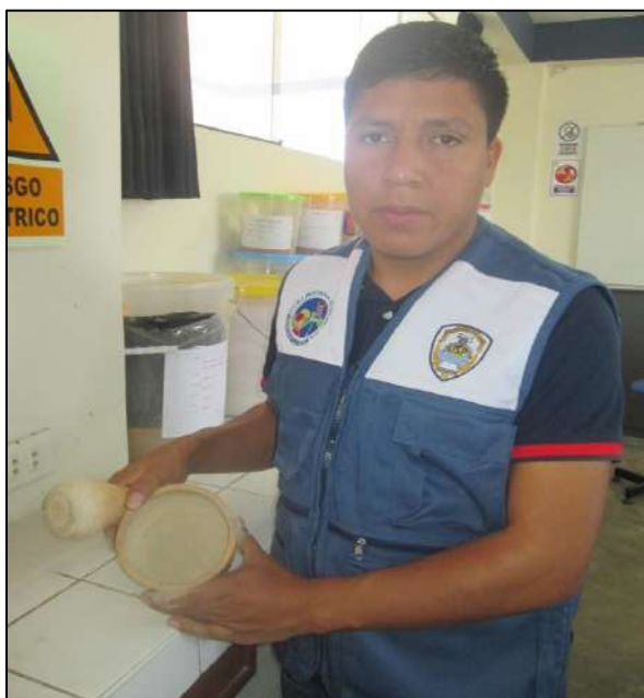
Foto N° 14: pulverizando la arcilla y pasado por la tela organza.
