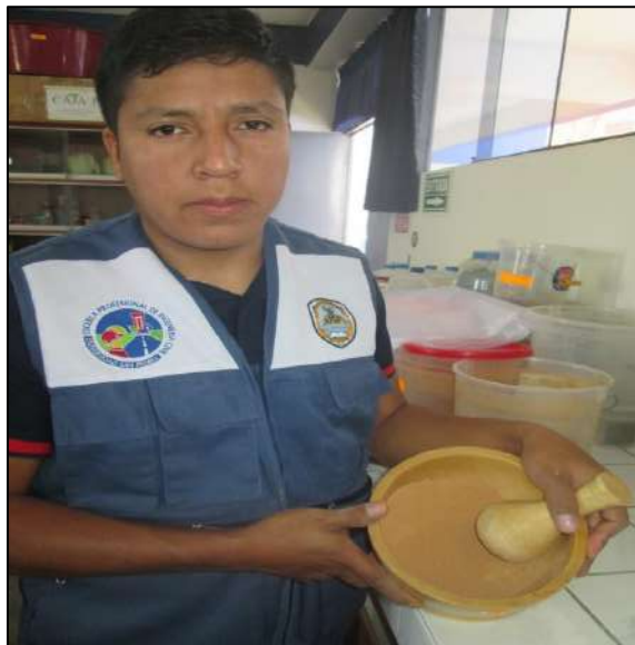
Foto N° 29: Molienda de la Arcilla Activada y pasado por la tela organza. Para ayudarnos en el momento de tamizar por la malla N° 200.
