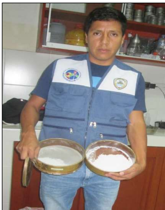
Foto N° 32: Concha de Abanico tamizada por la malla N° 200 y depositado en las bolsas de papel para que no adquiera humedad y este conservado.
