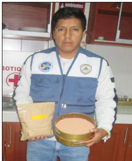
Foto N° 30: Arcilla Tamizada por la malla N° 200 y depositado en las bolsas de papel para que no adquiera humedad y este conservado.
