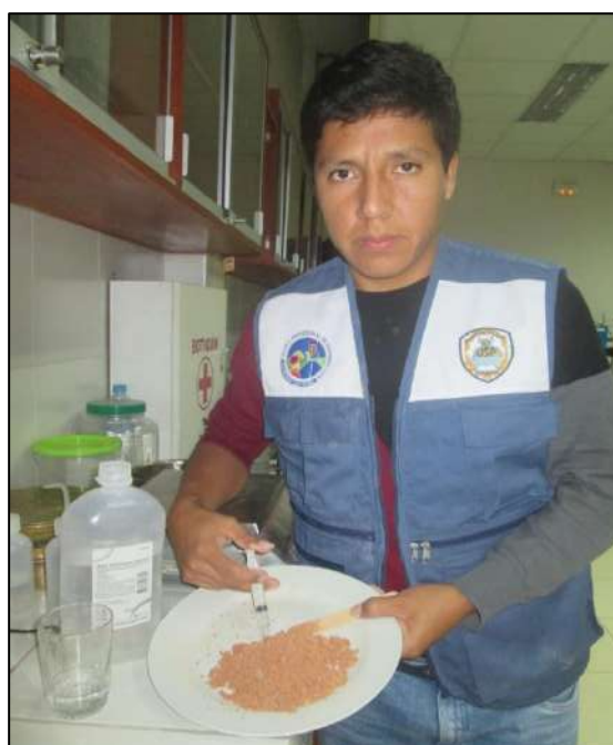
Foto N°40: Una vez que la mezcla este completamente uniforme, Agregamos agua destilada en relación al Índice de Plasticidad de la arcilla para las diferentes proporciones a utilizar.
