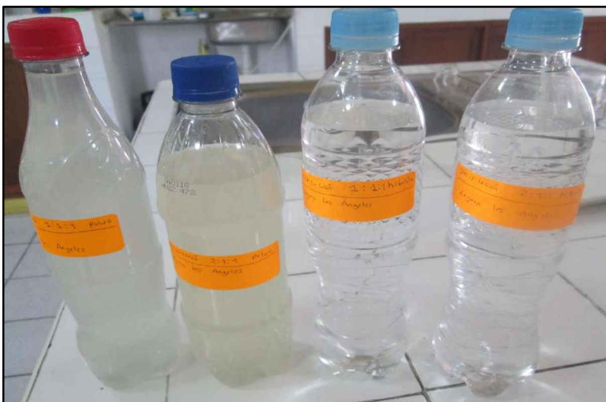
Foto N° 60: Una vez listas nuestras soluciones de Agua remediadas en el equipo de Juego de Jarras de la USP y bien identificadas. Lo llevamos al Laboratorio COLECBI para su respectivo Análisis de pH.
