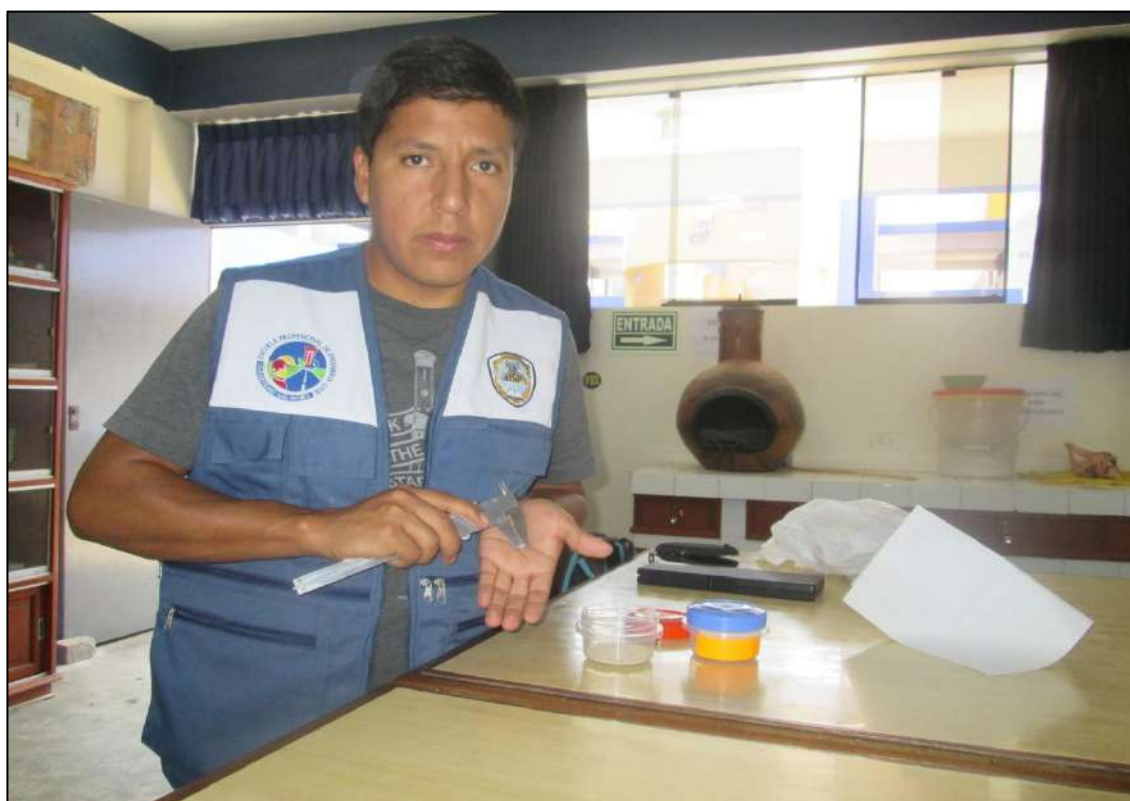
Foto N° 44: Utilización del vernier para el control de calidad de nuestras esferas elaboradas en la medida de 2mm
