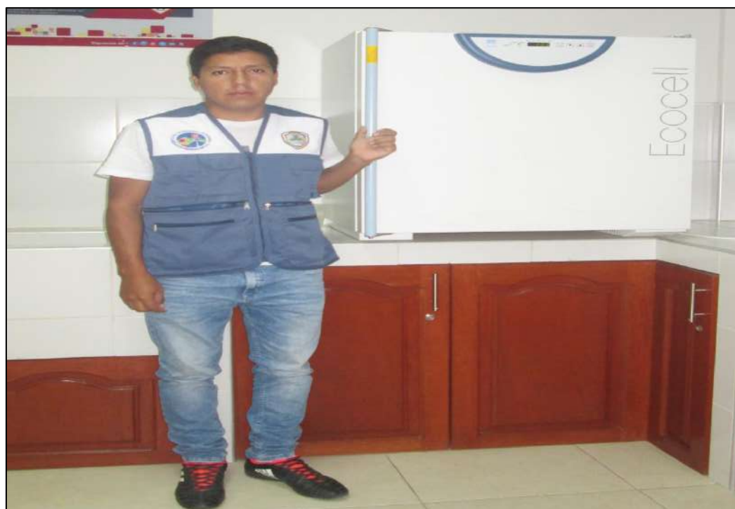
Foto N° 22: Programando el horno para secar por 24 horas
