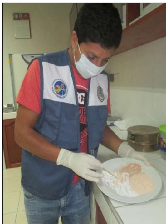
Foto N° 39: Después de pesar, pasamos a mezclar los 3 materiales de manera uniforme. Según la proporción que vamos a utilizar, en esta imagen apreciamos la proporción 1:1:1 Arcilla: Concha de Abanico: Maicena
