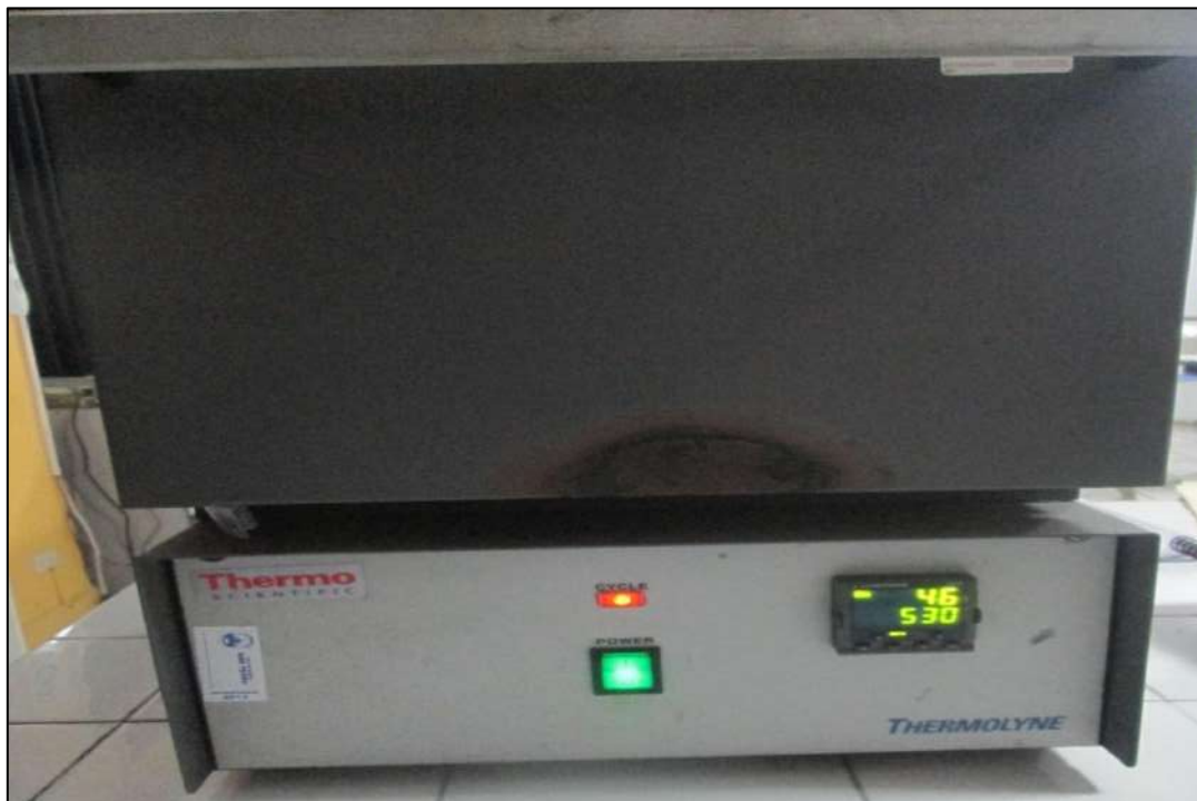
Foto N° 27: Calcinación de la Arcilla a 530° C por 1 hora
