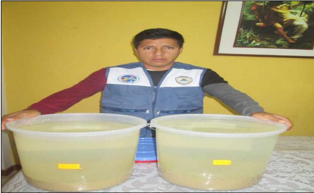
Foto N° 09: Arcilla lavada y puesta en reposo por 24 horas
