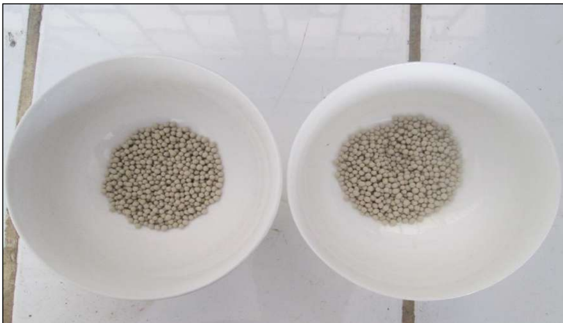
Foto N° 43: Obtención de esferas de 2mm. En proporciones 1:1:1 y 2:1:1. Listas para su respectiva Calcinación a 800° C durante 30min
