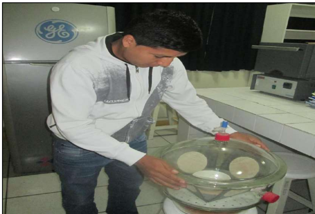
Foto N° 28: Los 2 materiales después de ser calcinados por 1 hora, pasamos a dejar enfriar, con la ayuda del secador para evitar un Choque Térmico.
