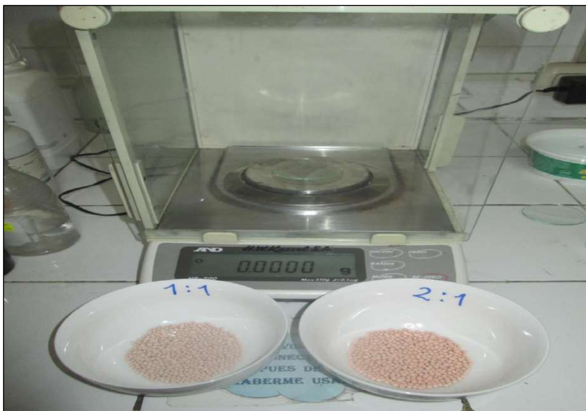
Foto N° 48: Pasamos a pesar el Híbrido en esferas de 2mm. En proporciones 1:1:1 y 2:1:1. Activados Térmicamente después de salir de la mufla
