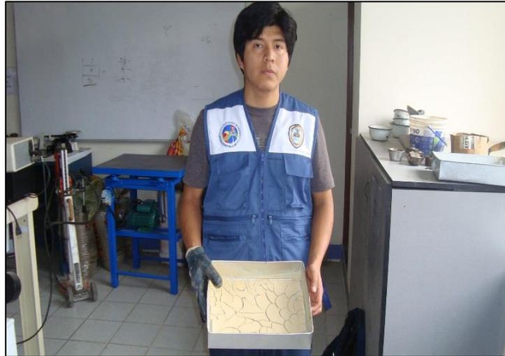
Figura 12: Arcilla después de secar por 24 horas en el horno
