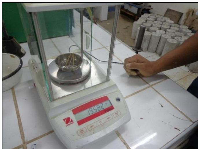
Figura 17: Pesando la muestra para ver su contenido de plasticidad.
