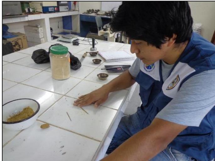
Figura 16: La arcilla se moldea en forma cilíndrica
