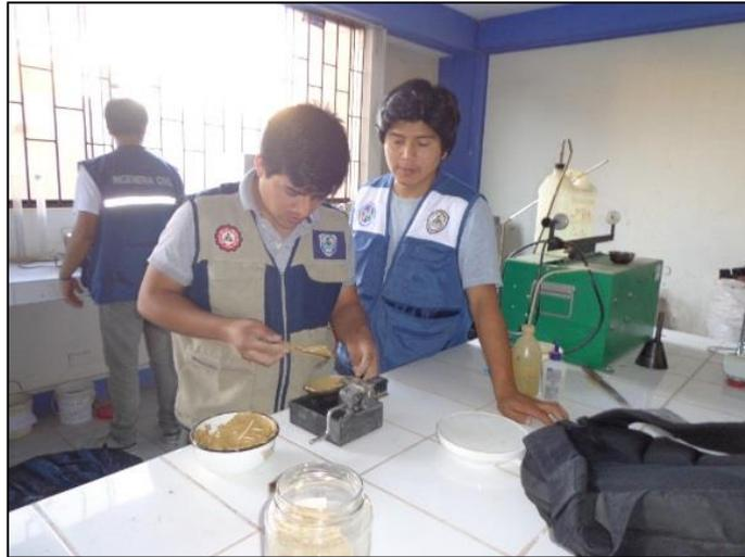
Figura 14: Colocando la arcilla mezclada en el cucharon Casagrande
