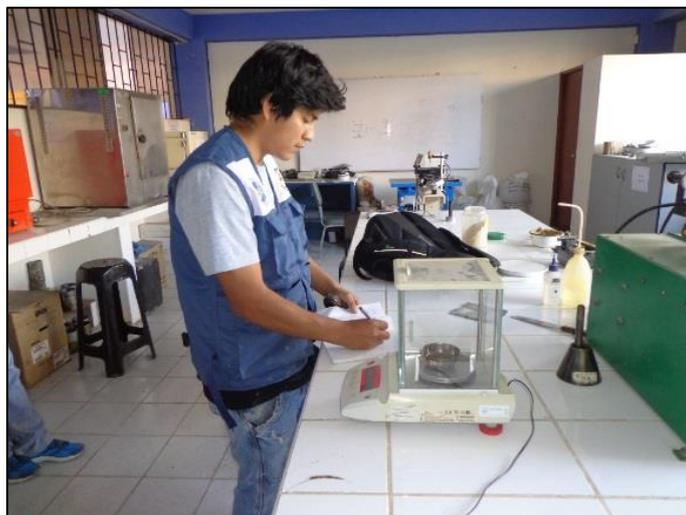
Figura 15: Pesando la muestra seca para ver el contenido de humedad
