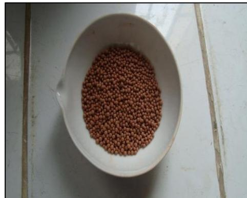
Figura 20: Se llevó a la mufla para ser calcinada a una temperatura de 540°C por 1 hora.
