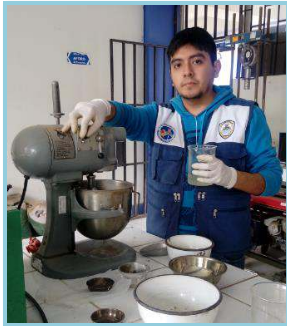
Foto N° 41: Mezcla de agua y mucílago de nopal lista para verter en la mezcladora.
