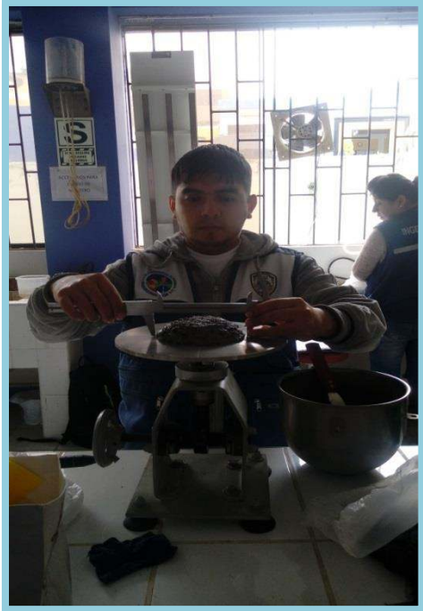
Foto N° 26: Retiramos el molde, hacemos girar 25 veces en un tiempo de 15 segundos y tomamos la medida de los diámetros tomando los respectivos apuntes, para determinar la fluidez.
