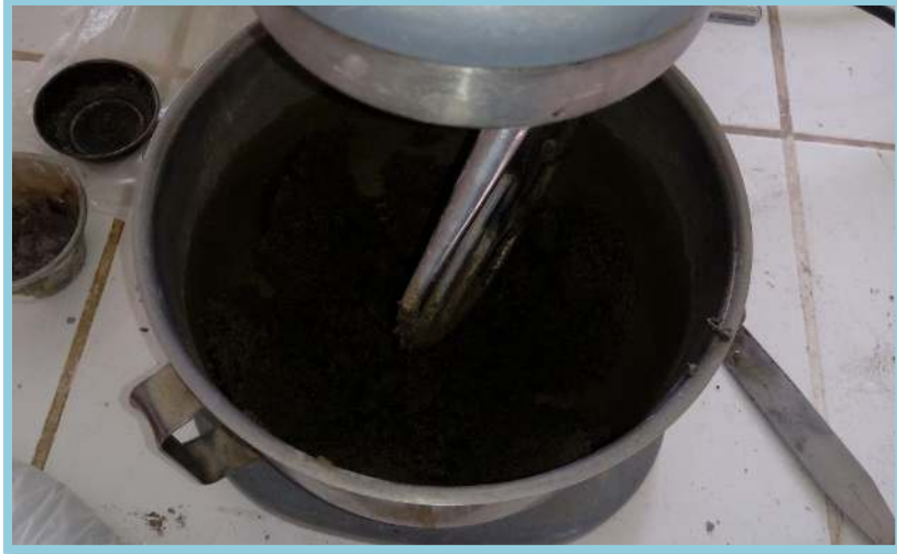
Foto N° 32: Se puso en la mezcladora durante 2 minutos; posteriormente se echó el agua para que mezcle por 2 minutos más.
