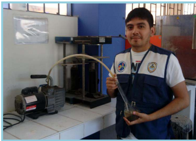
Foto N° 20: Con la bomba se succionó el aire que quedó dentro de la fiola durante un tiempo de 15 minutos.
