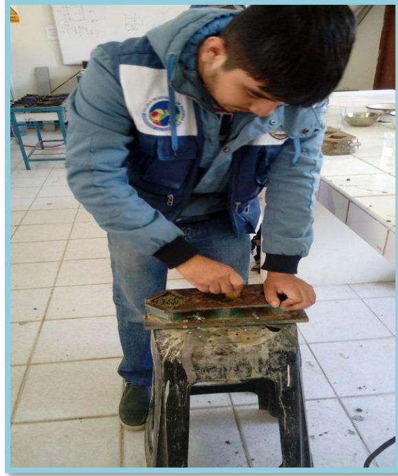
Foto N° 34: El mismo procedimiento para los demás cubos, vaciado y compactado.
