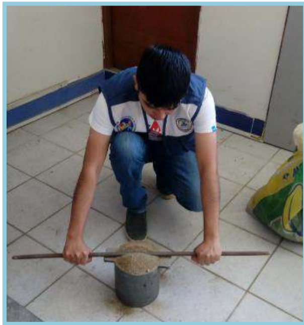
Foto N° 12: Después de haber llenado la tercera capa, se hace el enrasado respectivo y luego se pesa.
