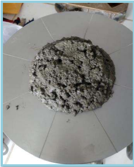
Foto N° 27: Fluidez del mortero patrón
