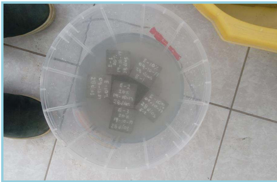
Foto N° 37: Curado de especímenes de mortero.
