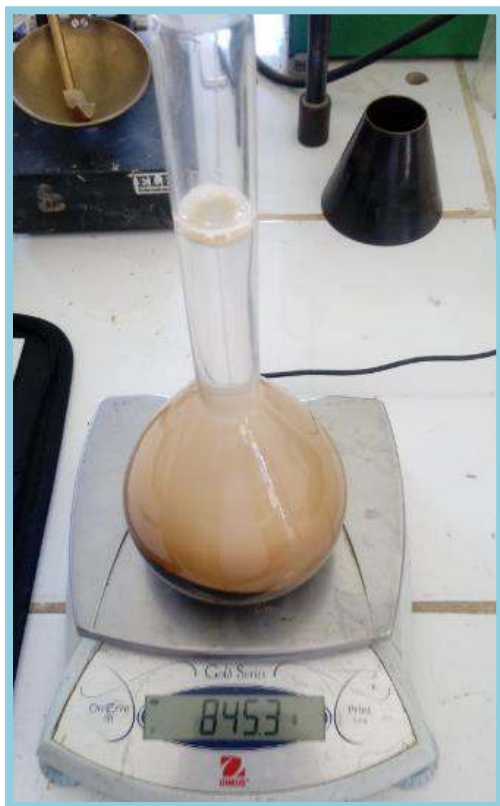
Foto N° 21: Luego se procedió a pesar la fiola con el agregado y el agua.
