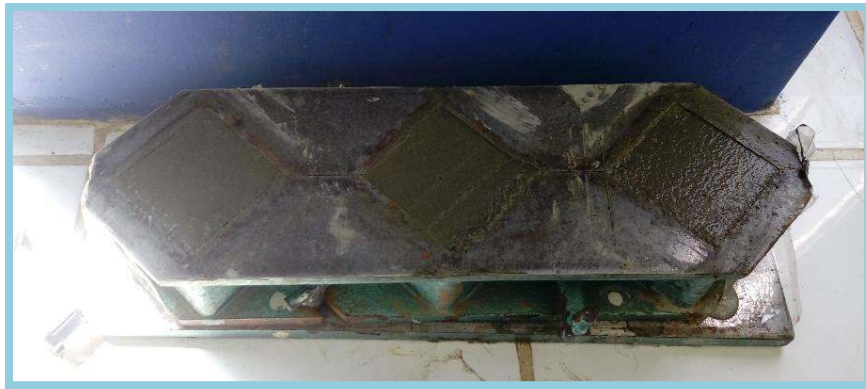
Foto N° 35: Terminado el anterior proceso, se procedió a enrasar, quedando de esta manera listo para el fraguado, de un tiempo de 24 horas.
