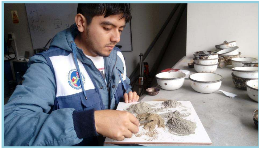
Foto N° 23: Se procede a hacer el cuarteo de la arena gradada, para luego mezclarla con el cemento antes de poner en la mezcladora.
