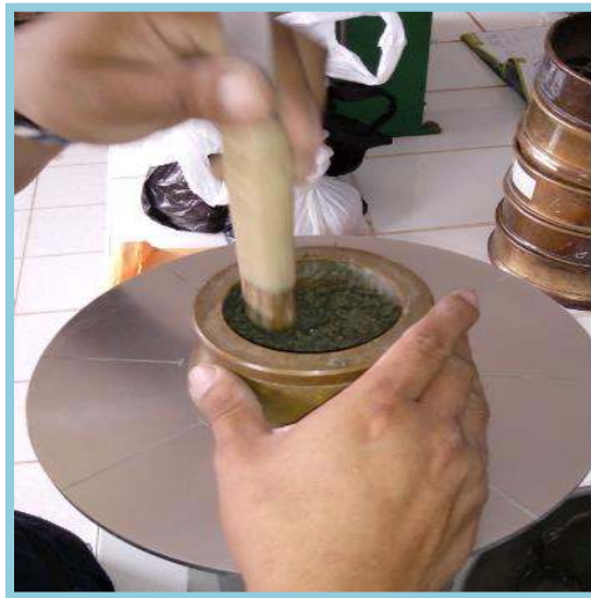
Foto N° 25: Echar la mezcla en el molde tronco-cónico en dos capas, en cada capa tiene que apisonarse 20 veces.
