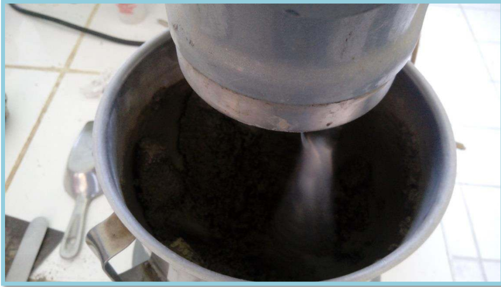
Foto N° 24: Una vez obtenida la mezcla de cemento y arena, se procede a ponerla en la mezcladora, durante 2 minutos. Luego de eso se echa el agua para que mezcle durante otros 2 minutos más.
