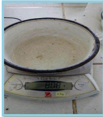
Foto N° 22: Se pesaron cemento, arena y agua para la elaboración del mortero patrón.
