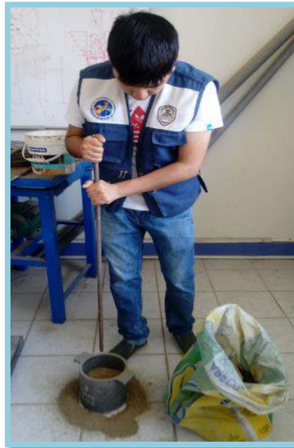
Foto N° 13: Se llena el molde a través de 3 capas, y en cada capa se compacta 25 veces.
