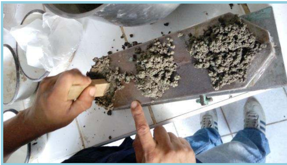
Foto N° 33: Se procedió a vaciar la mezcla de mortero en el molde, y con el apisonador de madera se compactó 32 veces que se hizo en 4 partes cada una con 8 lados en sentido horizontal y vertical
