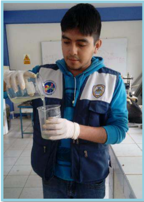
Foto N° 40: Se mezcla el agua con el mucílago de nopal, manera adecuada para utilizar como aditivo para el mortero experimental.
