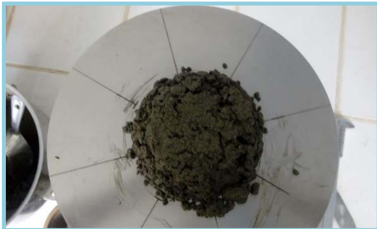
Foto N° 29: Fluidez del mortero experimental con 20% de adición de mucílago de nopal
