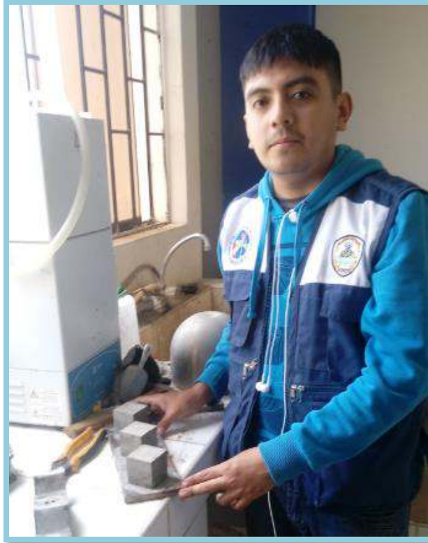
Foto N° 36: Después de 24 horas de fraguado, se desencofran los especímenes.
