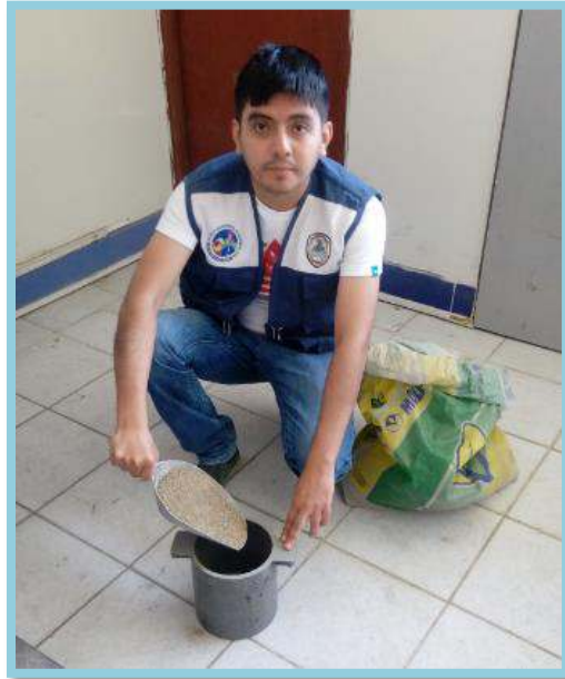
Foto N° 11: Se hace el llenado del molde con el agregado fino, dejándolo caer de manera natural a una altura determinada.
