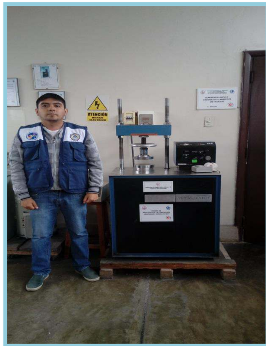
Foto N° 45: Prensa donde se realizará la rotura de los especímenes de mortero. (LABORATORIO N°1 DE ENSAYO DE MATERIALES- UNI)
