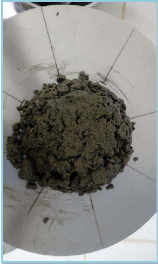
Foto N° 28: Fluidez del mortero experimental con 10% de adición de mucílago de nopal
