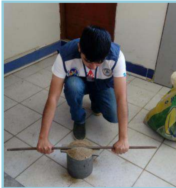
Foto N° 14: Se hace el respectivo enrasado, dejando la superficie plana y las orejas del molde totalmente limpias, sin restos del agregado. Posteriormente se pesa.
