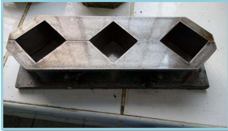
Foto N° 30: Alistamos el molde, encintándolo y armándolo, quedando listo de esta manera para el vaciado de la mezcla.
