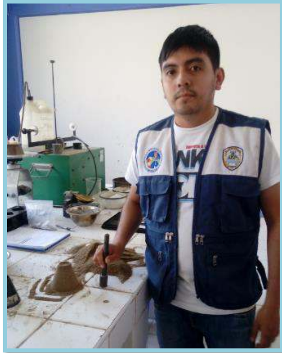
Foto N° 19: Se midió la consistencia del agregado fino con el cono y el apisonador.
