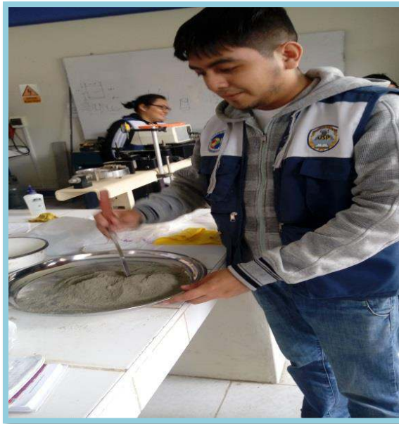
Foto N° 31: Hacemos el mezclado por cuarteo previo de la arena y el cemento.
