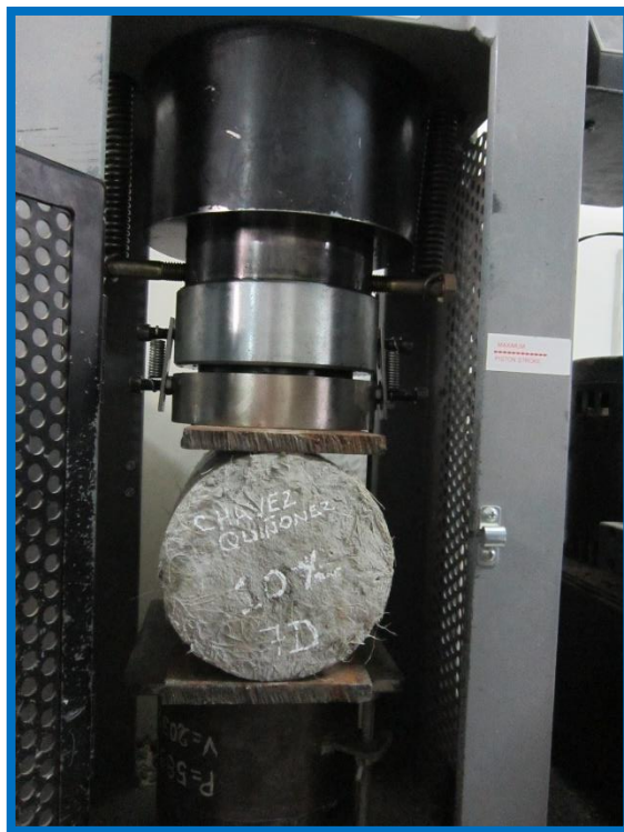
Figura 72: Realización de ensayo de tracción por compresión diametral simple espécimen experimental con 10% de fibra de agave - Laboratorio de la USP – Huaraz
