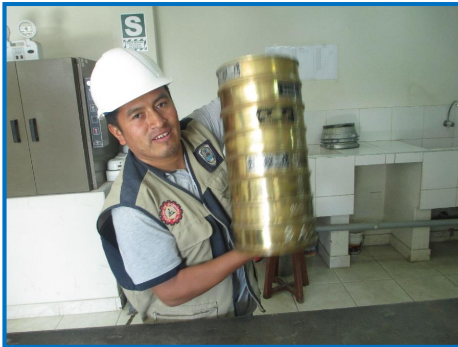
Figura 60: Tamizado de los agregados.
