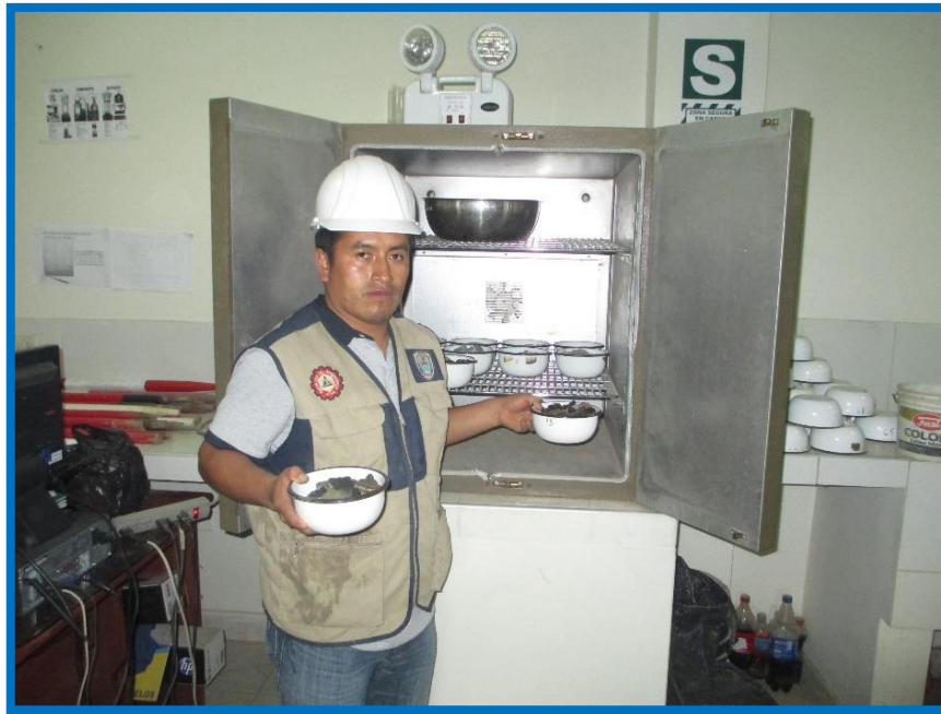
Figura 61: Secado de las muestras de agregado en el horno durante 24 horas.
