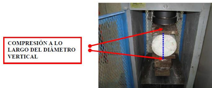
Figura 8: Resistencia a la tracción por compresión diametral
