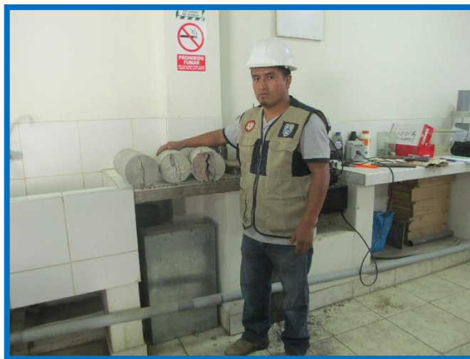
Figura 74: Muestra de los especímenes ensayados a tracción por compresión diametral simple.
