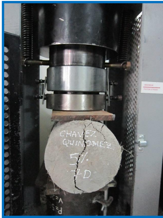
Figura 71: Falla por tracción diametral de la probeta experimental con 5% de fibra de agave.
