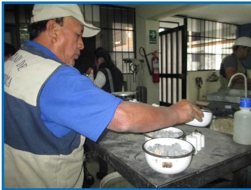
Figura 62: Ensayo de Absorción y peso específico de los agregados.
