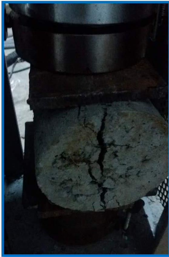
Figura 73: Falla por tracción diametral de la probeta experimental con 5% de fibra de agave.
