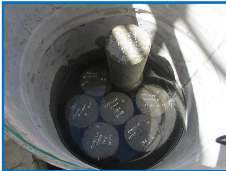
Figura 68: Curado de especímenes de concreto
