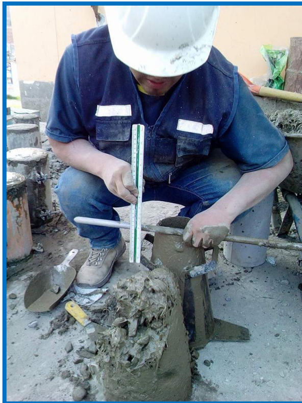
Figura 66: Ensayo de asentamiento del concreto “Slump”
