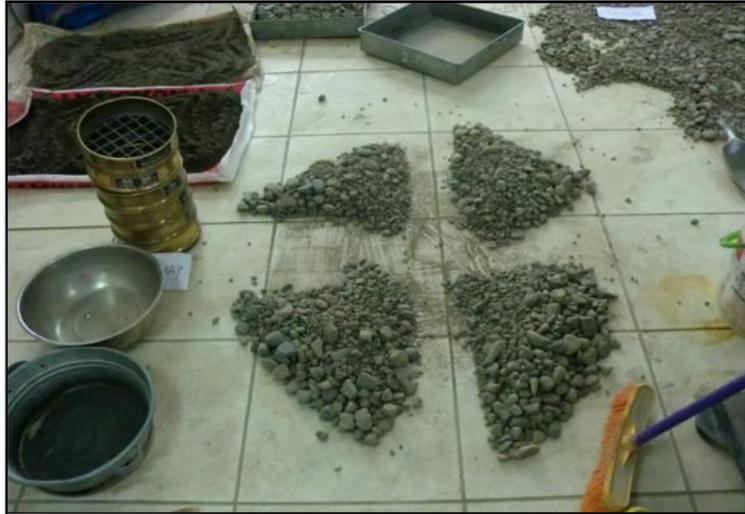
**Fotografía 09:** Cuarteo de muestras de agregado grueso de las 03 canteras.
