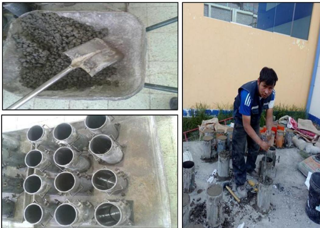
**Fotografía 15:** Probetas de concreto para la tesis.
