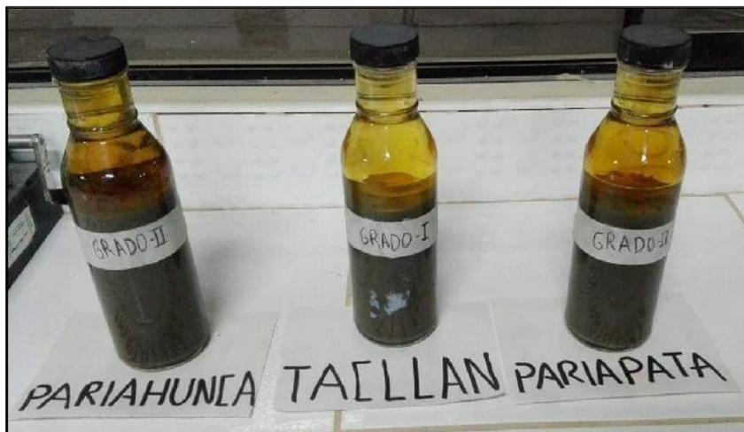
**Fotografía 19:** Identificación de grado de impureza de las muestras.
