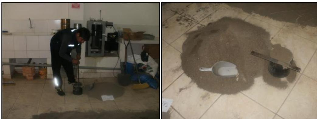
**Fotografía 11:** Densidad Compactada de la Arena de las diferentes canteras.
