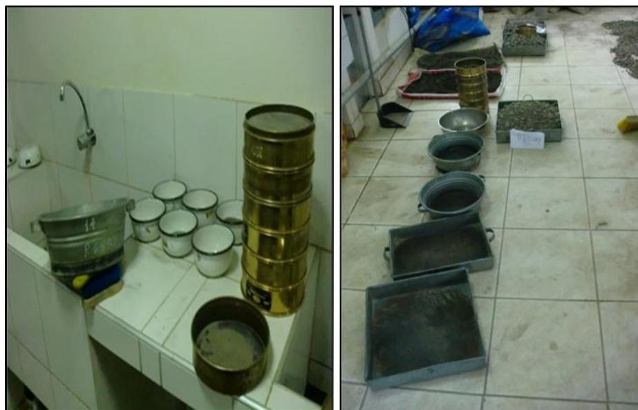
**Fotografía 08:** Tamices empleados para realizar ensayos de laboratorio.
