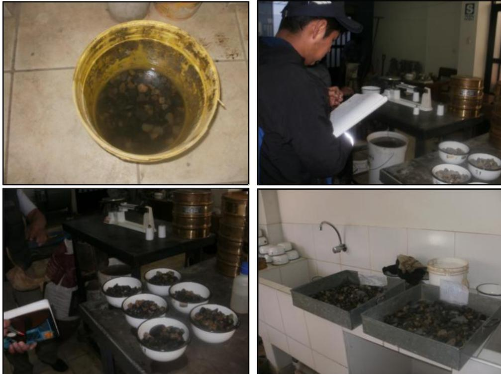
**Fotografía 14:** Densidad y Absorción Real del agregado grueso de las 03 canteras.
