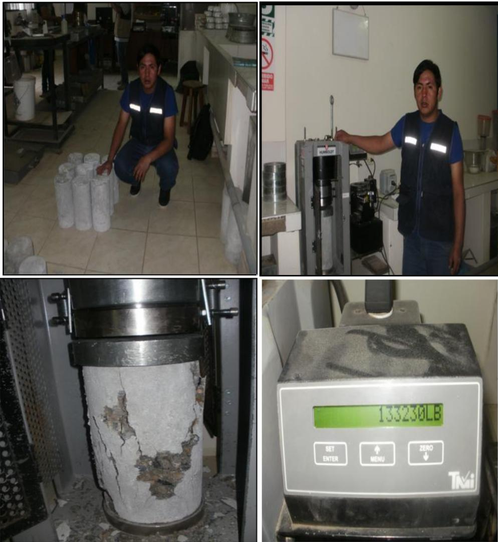
**Fotografía 17:** Inspección de roturas de probeta.
