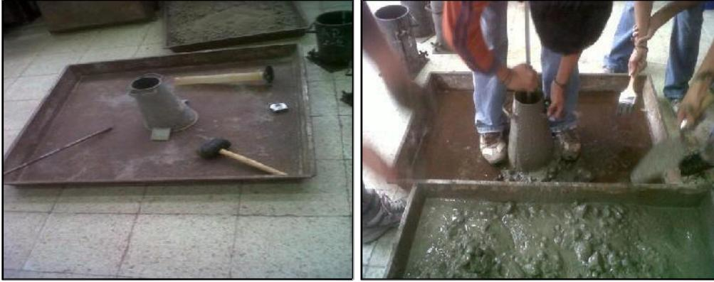
**Fotografía 16:** Ensayo del Cono de Abrams o Prueba de Slump.
