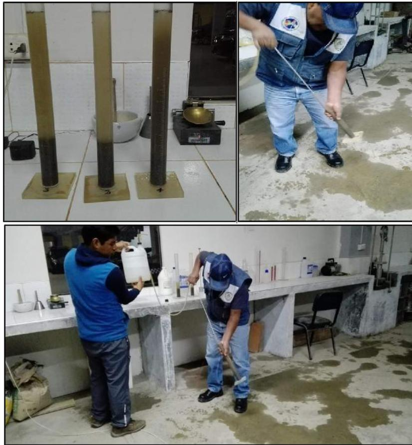
**Fotografía 18:** Ensayo de equivalencia de arena del agregado fino.
