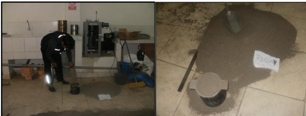
**Fotografía 10:** Densidad Suelta de la Arena de las diferentes canteras.
