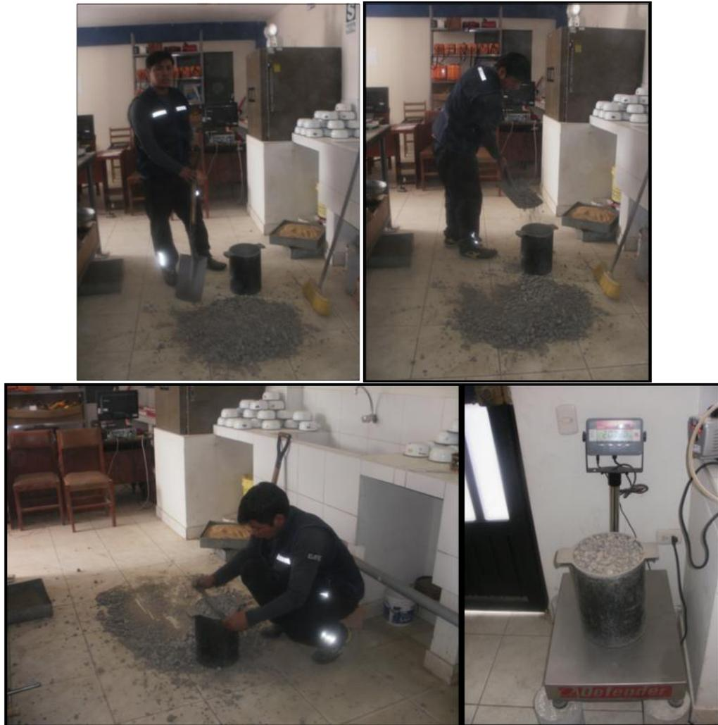
**Fotografía 12:** Densidad Suelta y Compactada del agregado grueso de las canteras.
