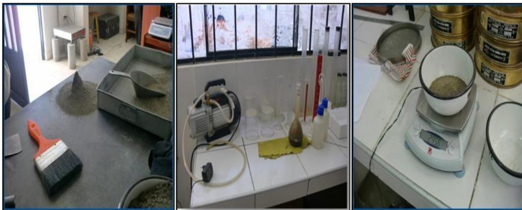
**Fotografía 13:** Densidad Real y Absorción de la Arena de las 03 canteras.
