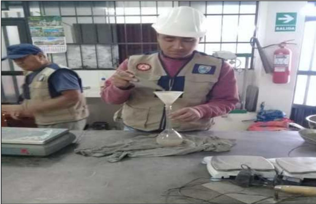
**Fotografía N°10:** *peso específico de agregado fino*
