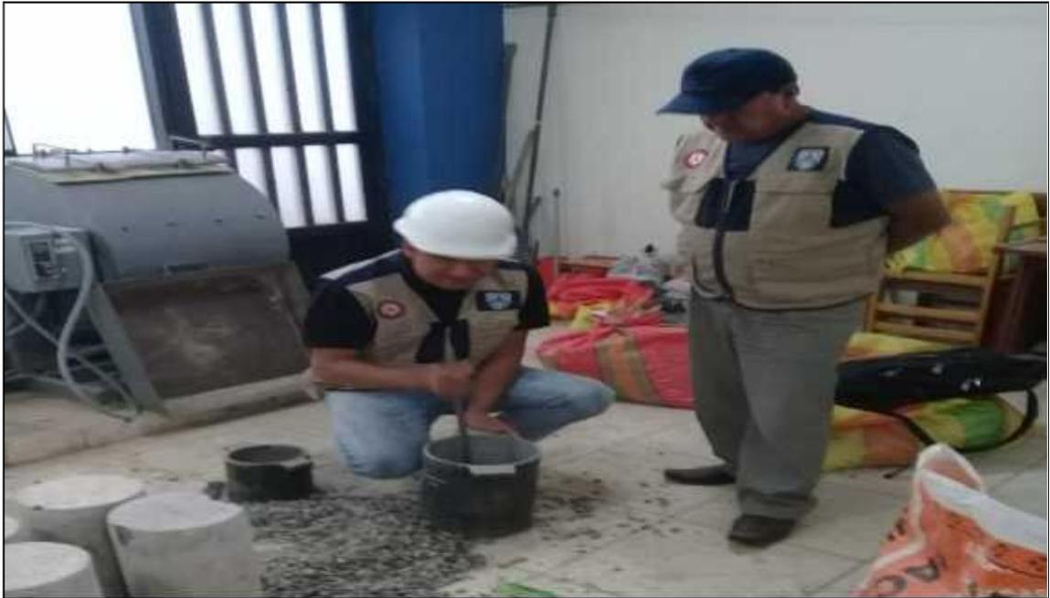
**Fotografía N°06:** *Varillado de agregado fino.*
