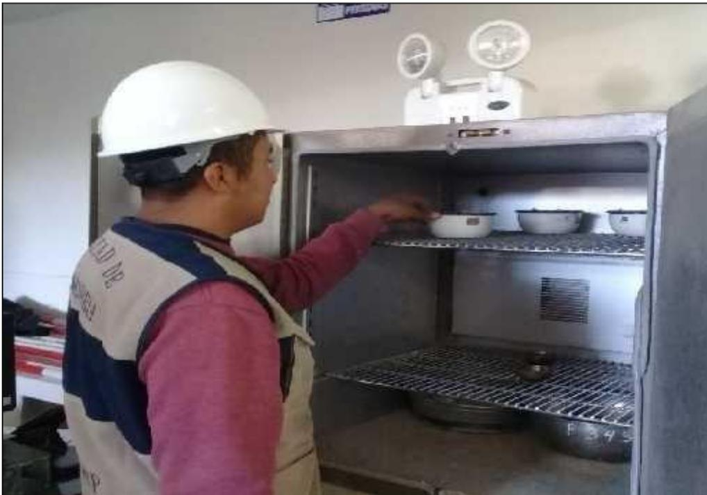
**Fotografía N°09:** *Secado de muestra en horno.*
