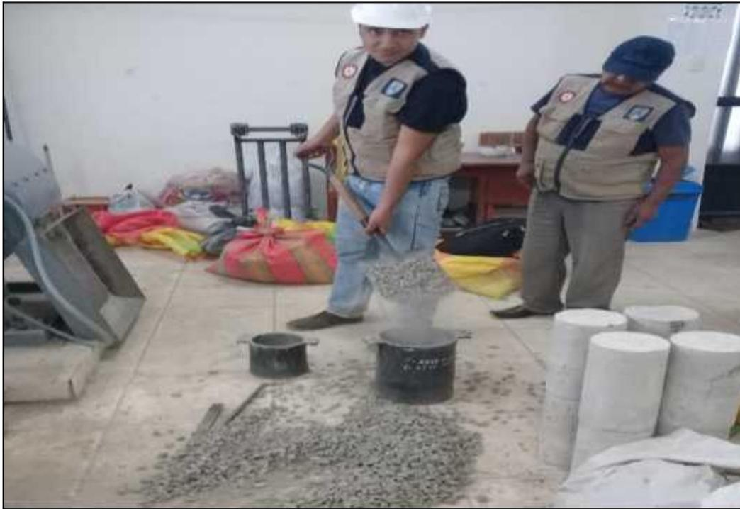
**Fotografía N°04:** *Ensayo de peso unitario en laboratorio.*
