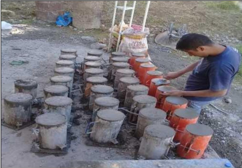
**Fotografía N°18:** *Enrasado de las probetas de concreto.*
