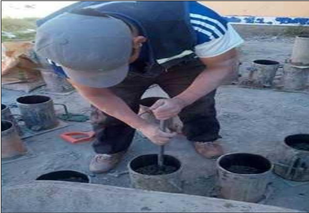
**FOTOGRAFÍA N°16:** *varillado del concreto 25 golpes por capa.*
