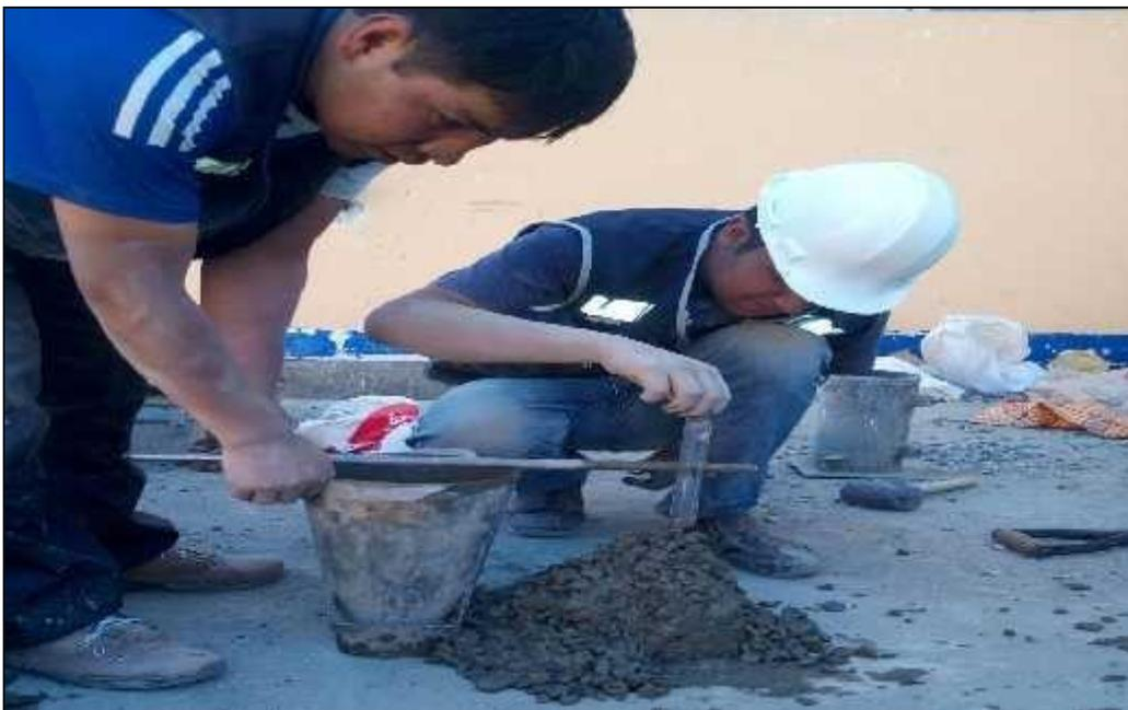
**Fotografía N°17:** *Prueba de slump.*
