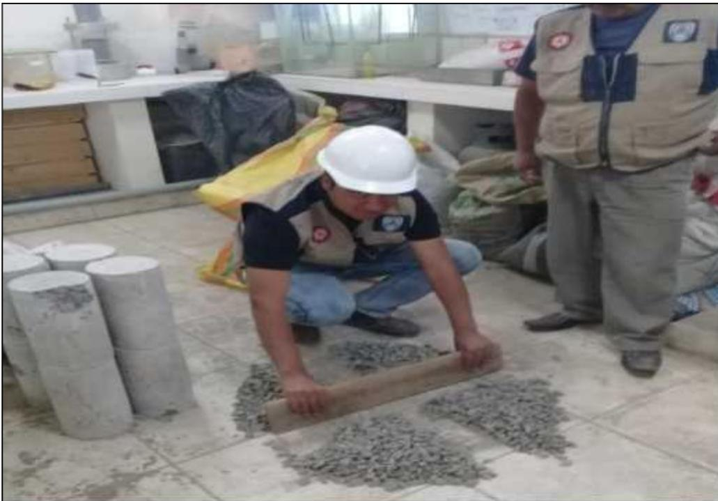
**Fotografía N°05:** *Método de cuarteo para determinar las propiedades físicas del agregado grueso.*
