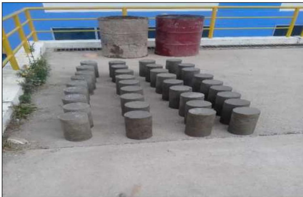
**Fotografía N°19:** *desencofrado de las probetas.*
