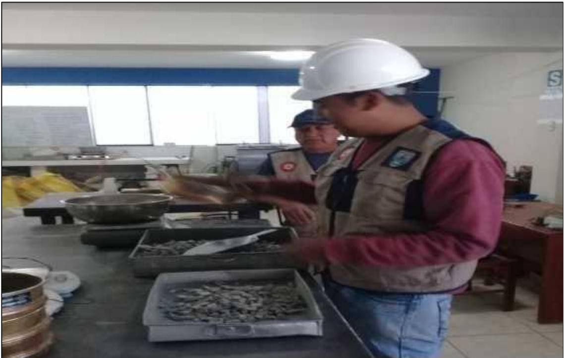
**Fotografía N°07:** *Proceso de tamizado de agregado grueso.*
