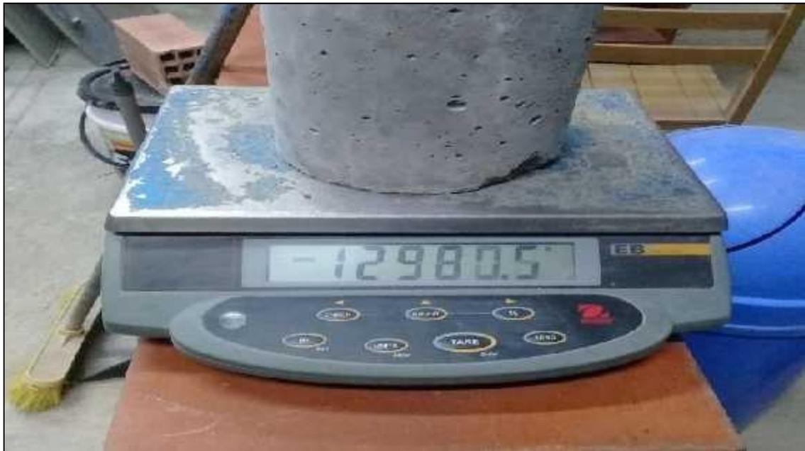
**Fotografía N°21:** *pesaje de probetas de concreto con balanza electrónica*
