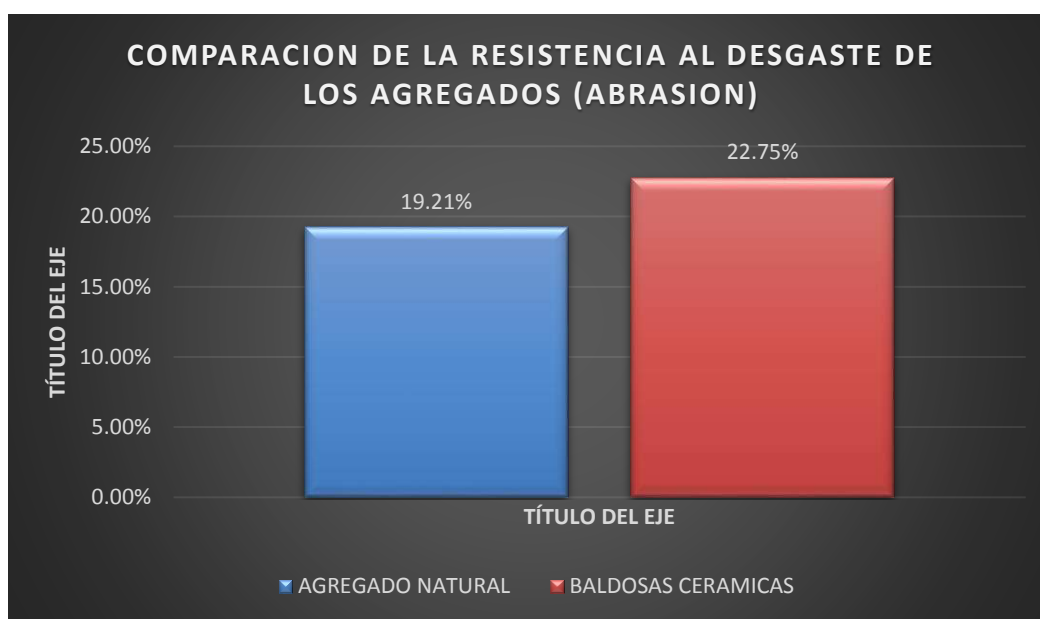
Figura 21 Comparación de la Resistencia al desgaste de los agregados Fuente: Laboratorio de mecánica de suelos de la USP
