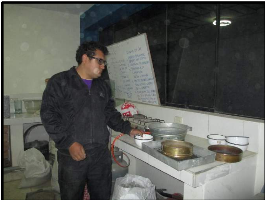
Figura 6 Ensayo de % de humedad
