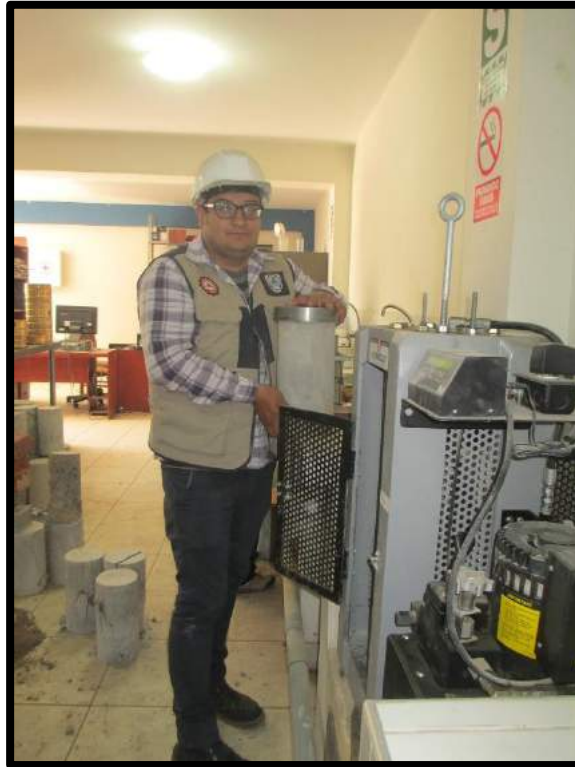
Figura 17 Rotura de probetas
