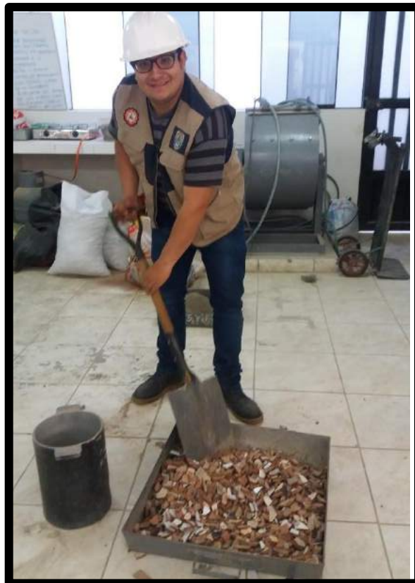
Figura 10 Ensayo de peso unitario
