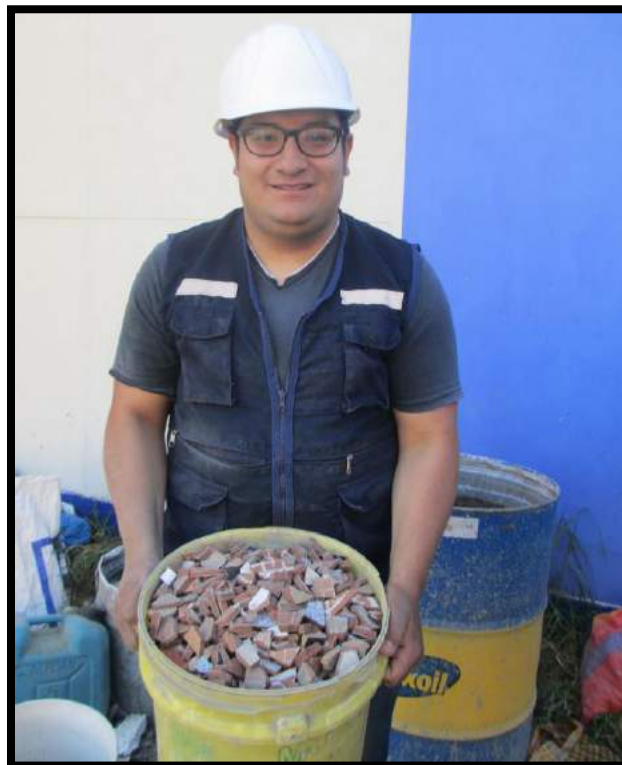
Figura 4 material triturado baldosa cerámica (comba manual)
