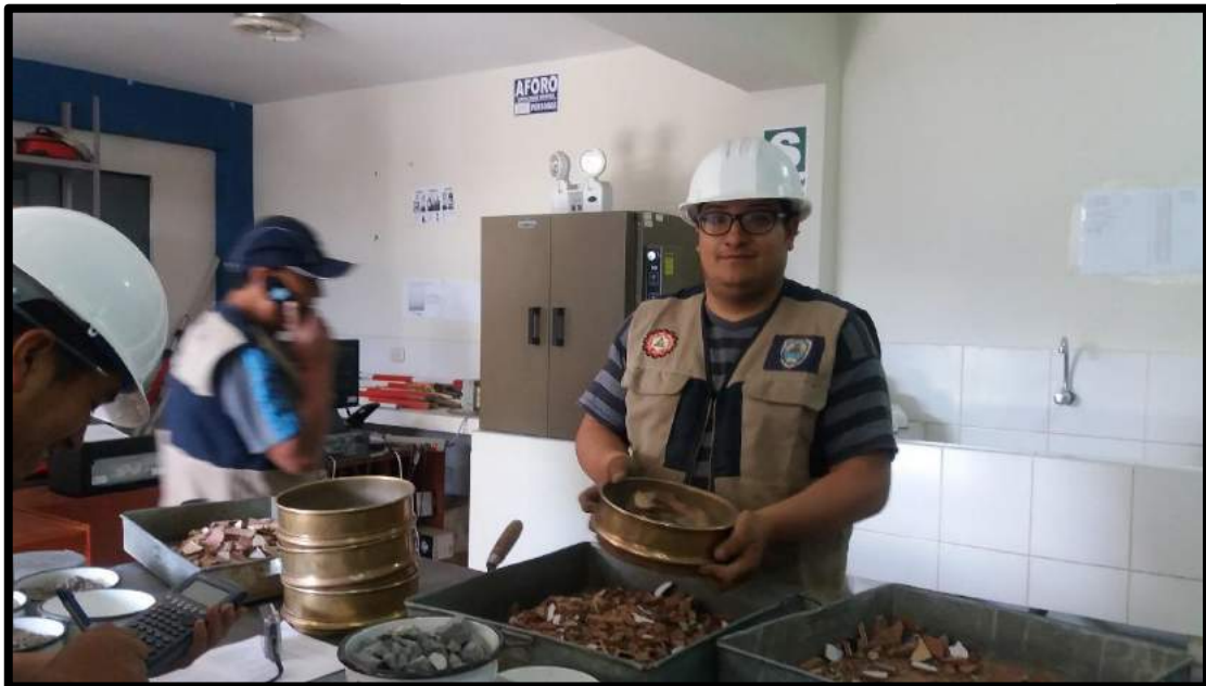
Figura 12 Ensayo de granulometría
