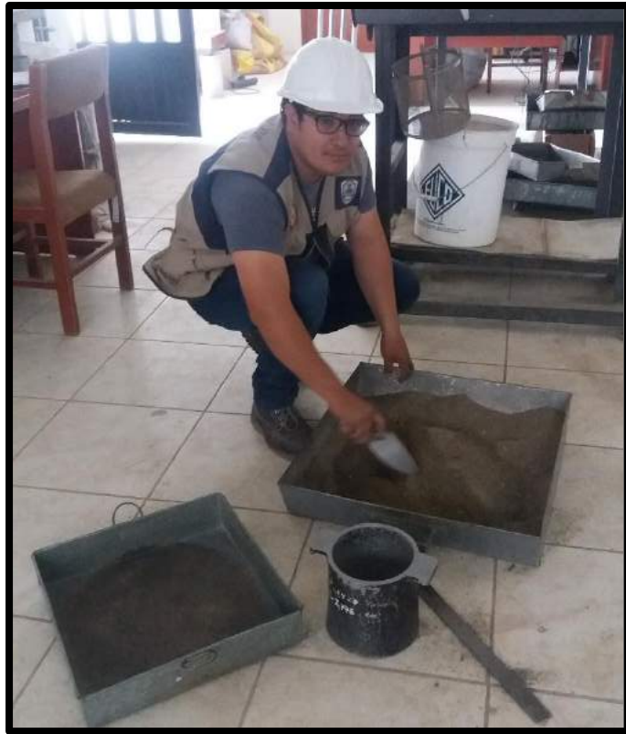
Figura 7 Ensayo de peso unitario
