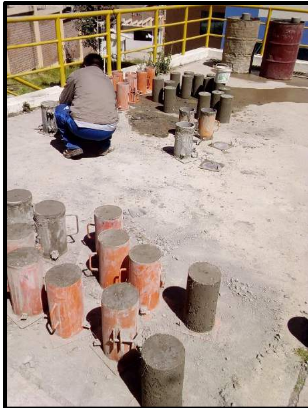
Figura 16 Desencofrado de probetas
