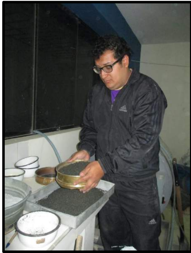
Figura 5 tamizado de material
