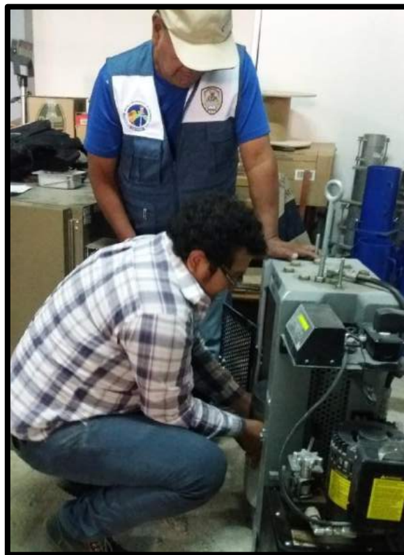
Figura 18 Rotura de probetas
