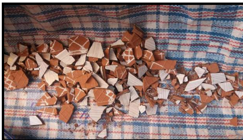
Figura 3 desperdicio de baldosas cerámicas particionado de forma artesanal (comba manual)
