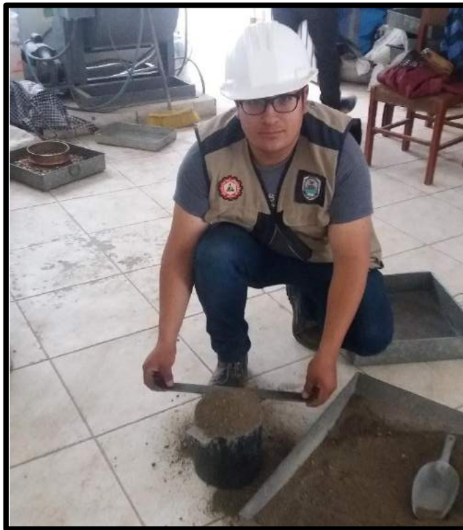
Figura 8 Ensayo de peso unitario
