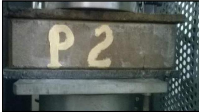
Figura II-19 Ensayo a compresión simple
