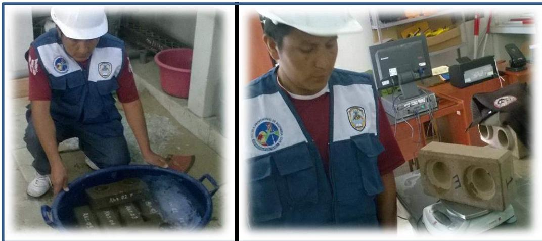
Figura II-21 Ladrillo sumergido en agua y control de peso
