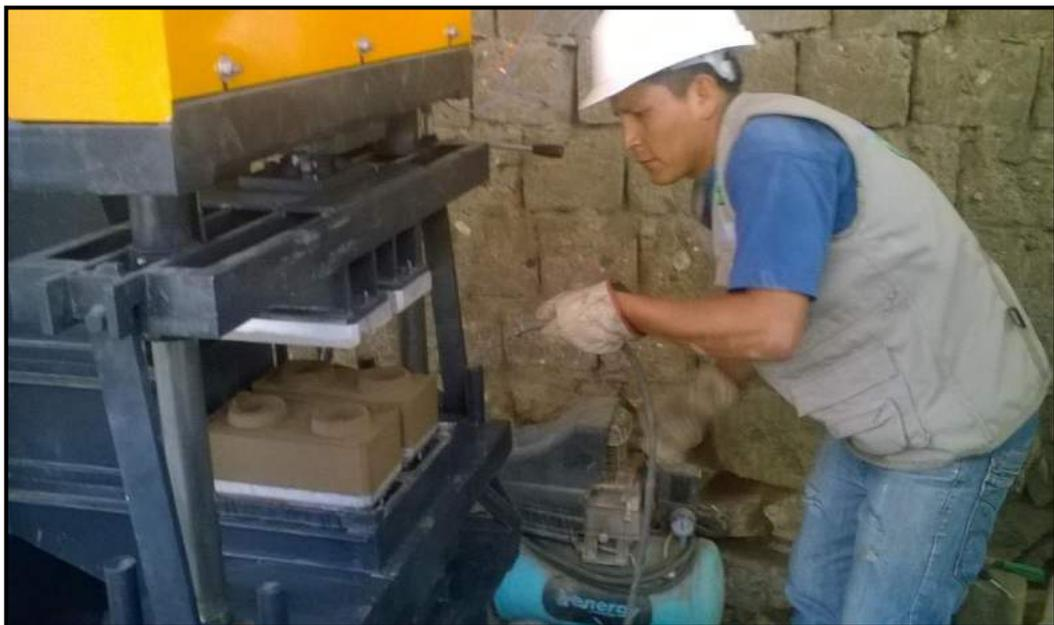
FOTO N° 6 Prensado de ladrillos ecológico
