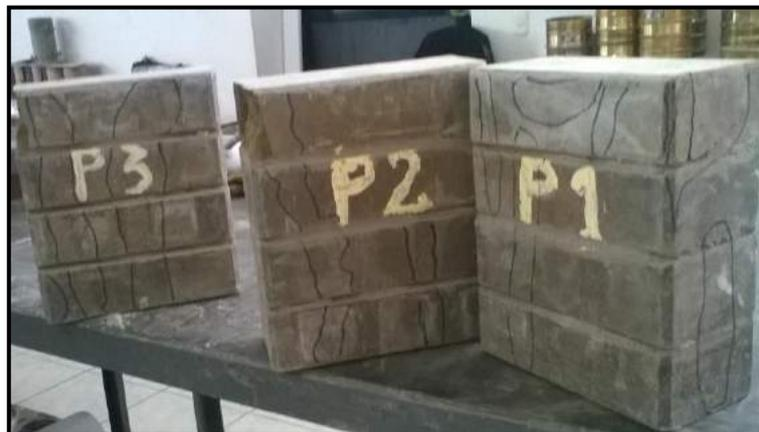
Figura II-26 Forma de falla de las tres pilas patrón
