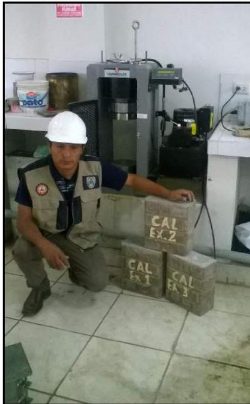
FOTO N° 18 Ensayo de compresión axial de pilas
