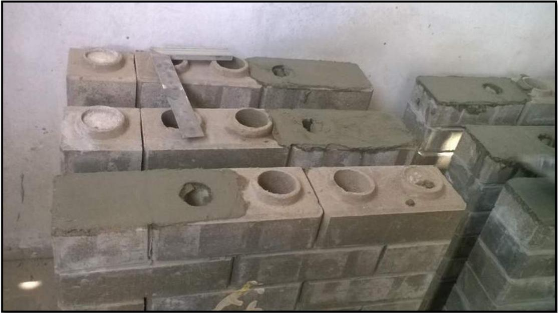
FOTO N° 9 Incorporación de Cappin de yeso – cemento a los muretes
