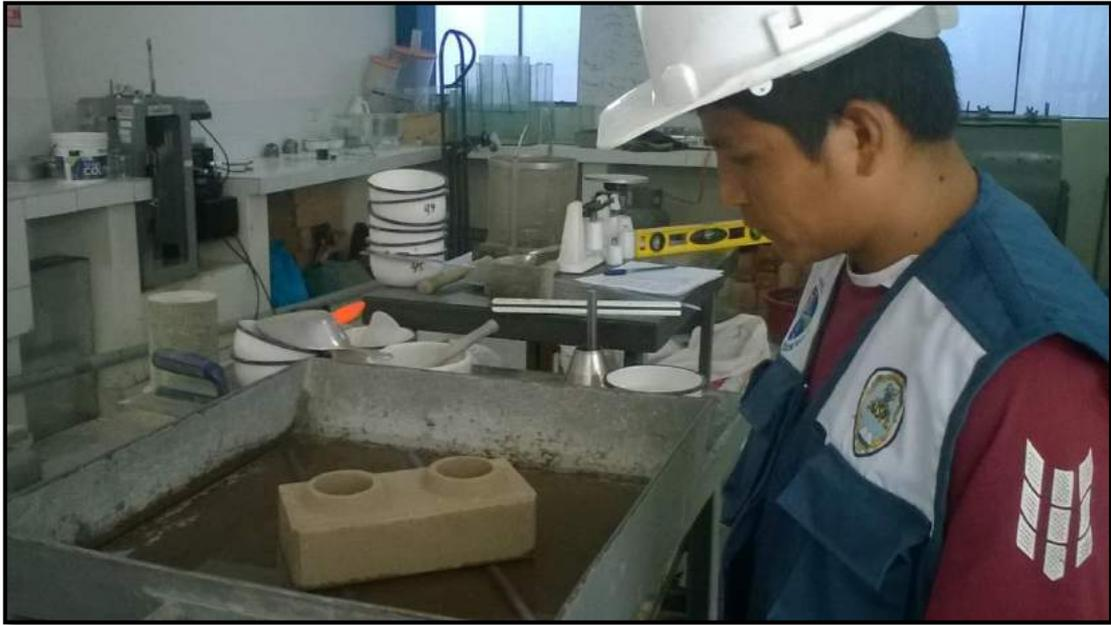
FOTO N° 17 Ensayo de Succión
