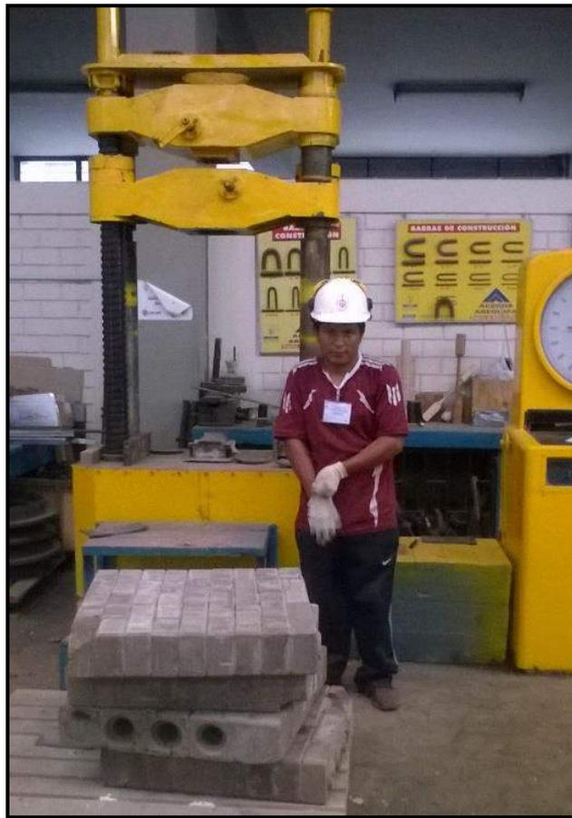
Figura II-29 Máquina de compresión universal
