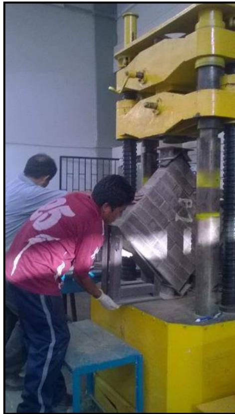
FOTO N° 20 Ensayo a compresión diagonal de Muretes
