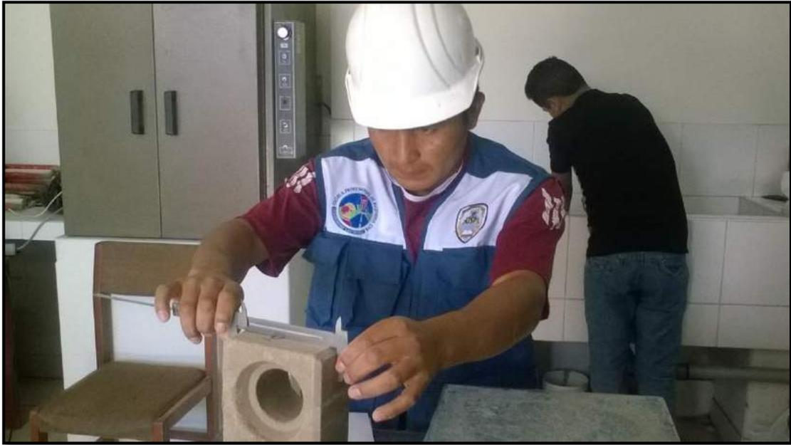
FOTO N° 15 Ensayo de Variación de Dimensiones
