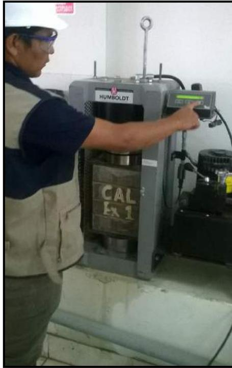
Figura II-25 Compresión de pilas
