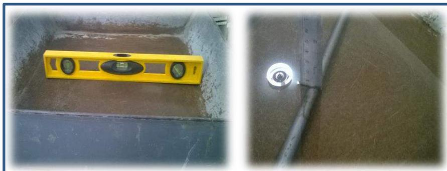
Figura II-22 Nivelación De Bandeja Y Control De Nivel De Agua
