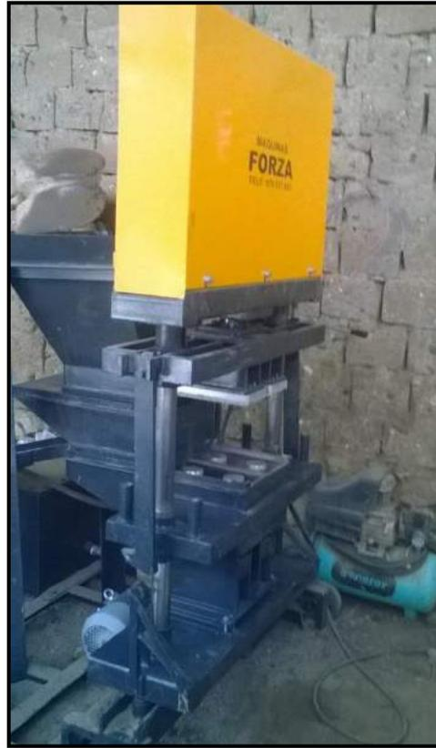
FOTO N° 5 Prensa hidráulica de 6ton
