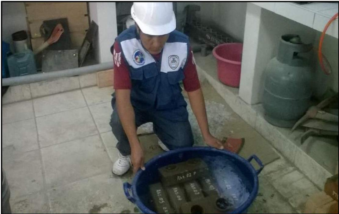
FOTO N° 16 Ensayo de Absorción
