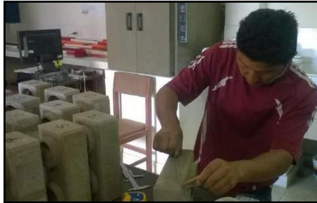
Figura II-17 Medición de concavidad y convexidad
