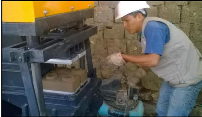
Figura II-5 Prensado con la prensa hidráulica
