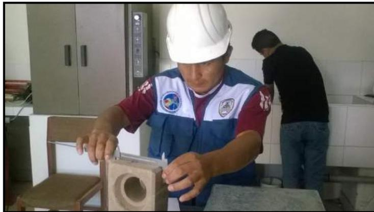
Figura II-15 Medición de las dimensiones
