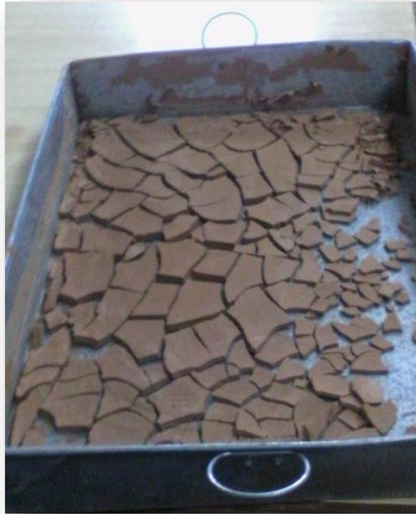
**Imagen N° 09:** Arcilla luego de secar 24 horas en el horno.
