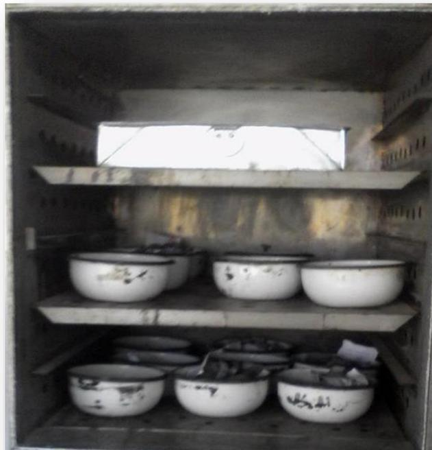
**Imagen N° 08:** Arcilla en el horno durante 24 horas a una temperatura de 80°C.
