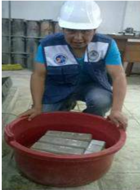
Figura 8: Saturación de los ladrillos
