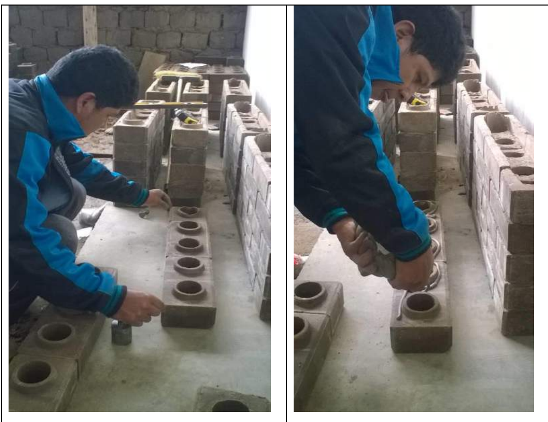
La foto 13. Se observa la elaboracion de testigos de murestes y pilas
