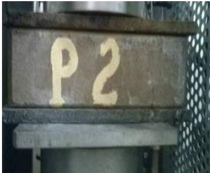
Figura 10: ensayo a compresión simple de unidades ecológicas Fuente: Elaboración propia, laboratorios USP San Pedro
