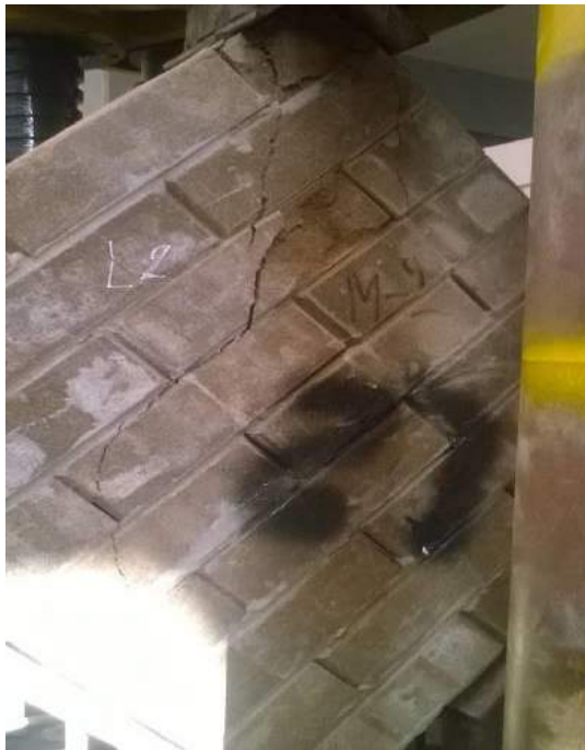
Figura 19: Falla típico en muestra patrón Fuente: Elaboración propia, laboratorios UNI LEM
