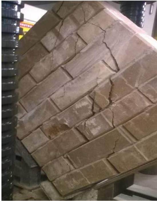
Figura 18: Falla típico en muestra patrón Fuente: Elaboración propia, laboratorios UNI LEM
