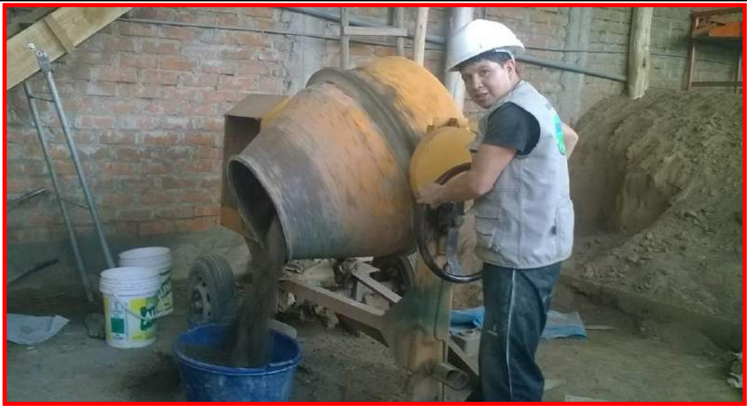
En la foto 05. Se observa la mezcla ya listo para trasladar al equipo de prensado
