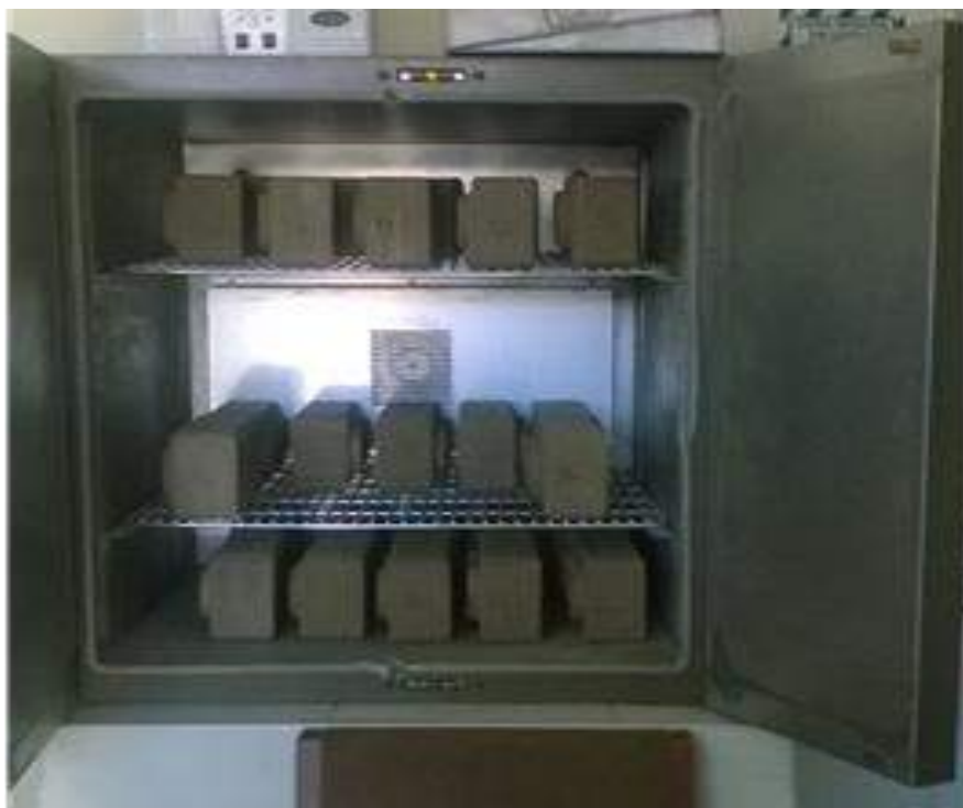
Figura 7. Secado de las unidades en el horno Fuente: Elaboración propia
