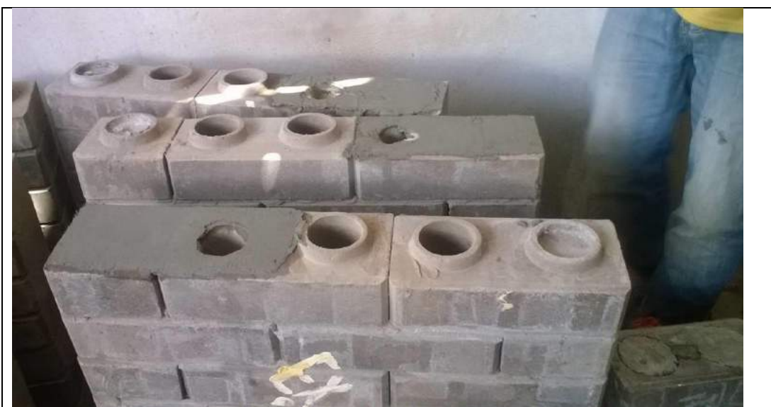
Foto 14. Se observa que las esquina en donde se someten los ensayos se a nivelado con canping de yeso cemento
