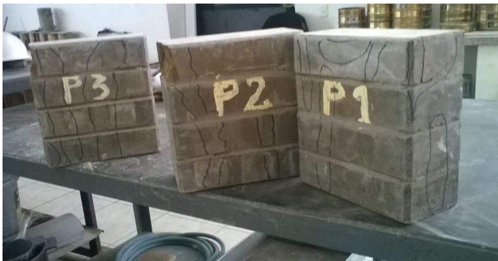
Figura 15: dela falla de muestra experimental Fuente: Elaboración propia, laboratorios USP San Pedro
