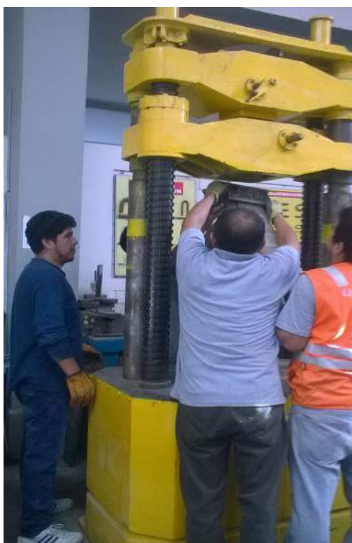
Figura 16: Colocación para el ensayo de compresión diagonal de murete Fuente: Elaboración propia, laboratorios UNI LEM
