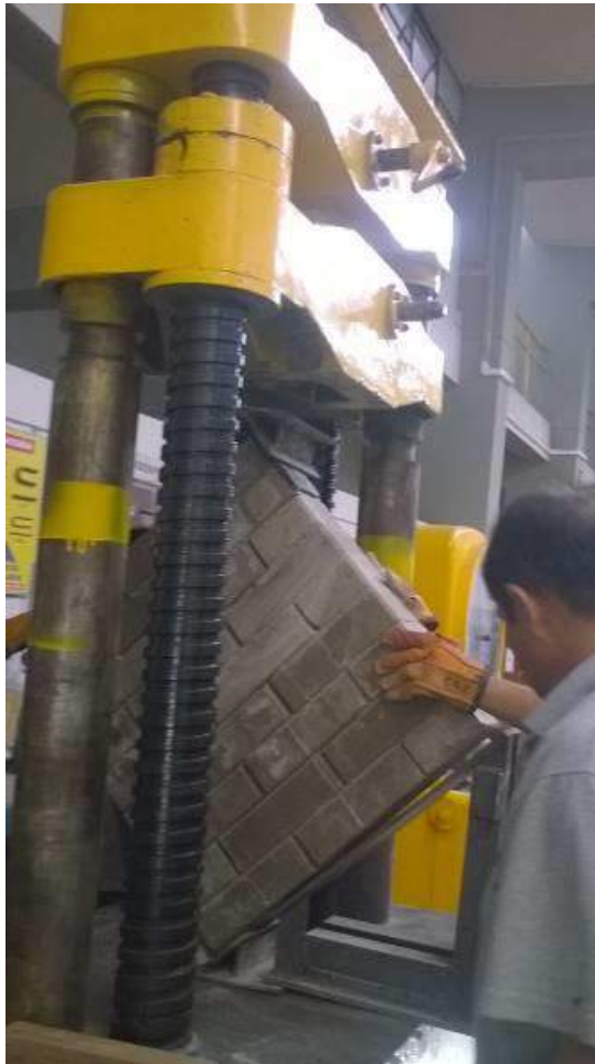
Figura 17: Alineamiento para someter la carga al muerete Fuente: Elaboración propia, laboratorios UNI LEM
