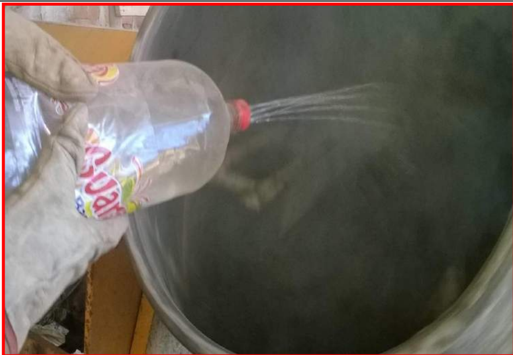
En la foto 04. Se observa la adición de agua a la mezcla, el agua se agrega de forma esparcida
