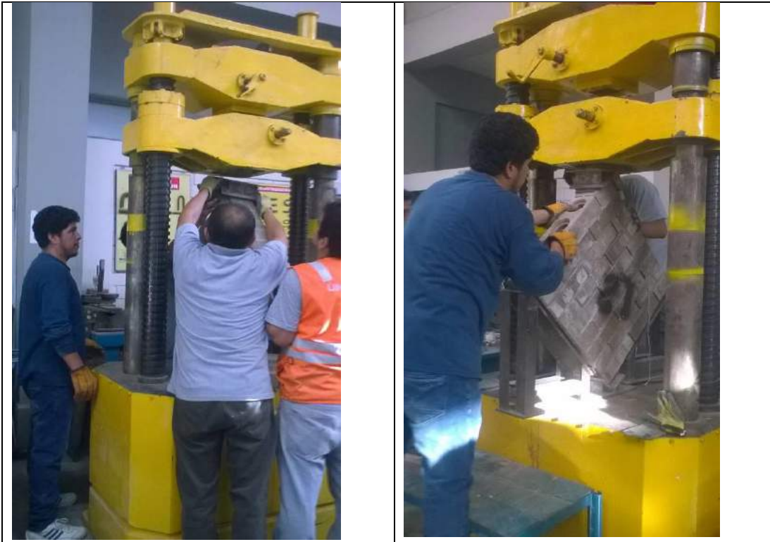
Foto 17. Se observa la colocación y ensayo diagonal de muretes
