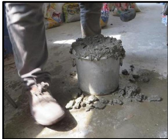
3.- Una vez terminado de limpiar el exceso de concreto en la parte exterior del recipiente se procede a pesar el molde lleno de concreto.
