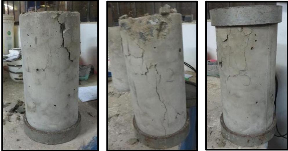
Probetas patrón N° 01, 02 y 03 después de ser ensayadas a los 7.
