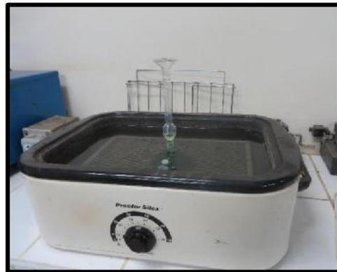
Se agregó gasolina 96 a la Fiola hasta el nivel 0 y se coloca en baño maría a temperatura de 22°C, se deja que la gasolina suba todo lo que se pueda, luego se retira y se vuelve a dejar en el nivel 0.
