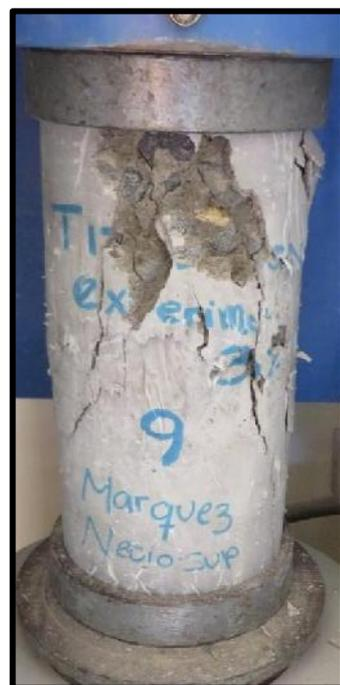
Las probetas experimentales del 3% después de ser ensayadas a los 28 días de curado.
