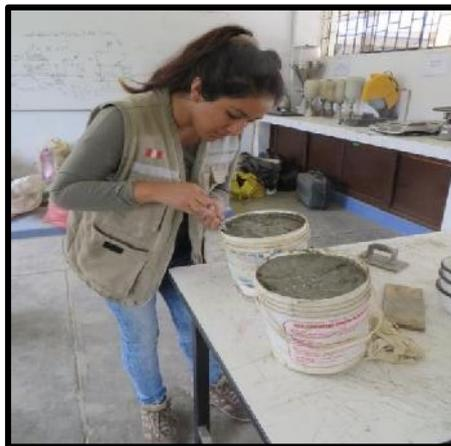
**o. PESO UNITARIO DEL CONCRETO (NORMA: ASTM C 138)**
