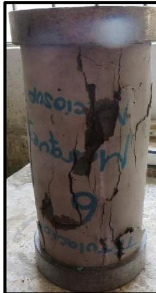
Las probetas patrón N° 04, 05 y 06 después de ser ensayada a los 14 días de curado
