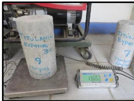
Se pesan las probetas experimentales al 3% para ser ensayadas a los 28 días.
