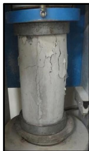
Observamos las probetas experimentales al 3% N° 04, 05 y 06 después de ser ensayadas a los 14 días de curado.
