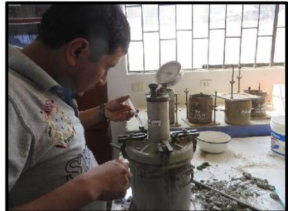
2.- Se inyecta agua a través de una de las llaves de purga hasta que se salga por la otra. Luego se cierra la válvula de escape de aire y se bombea aire dentro de la cámara hasta que el manómetro este en la línea de presión inicial.
