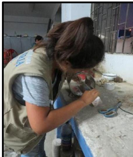
Se procedió hacer la limpieza respectiva de los moldes de las probetas la cual se forro con cinta de embalaje para proteger al concreto del óxido que trae las probetas
