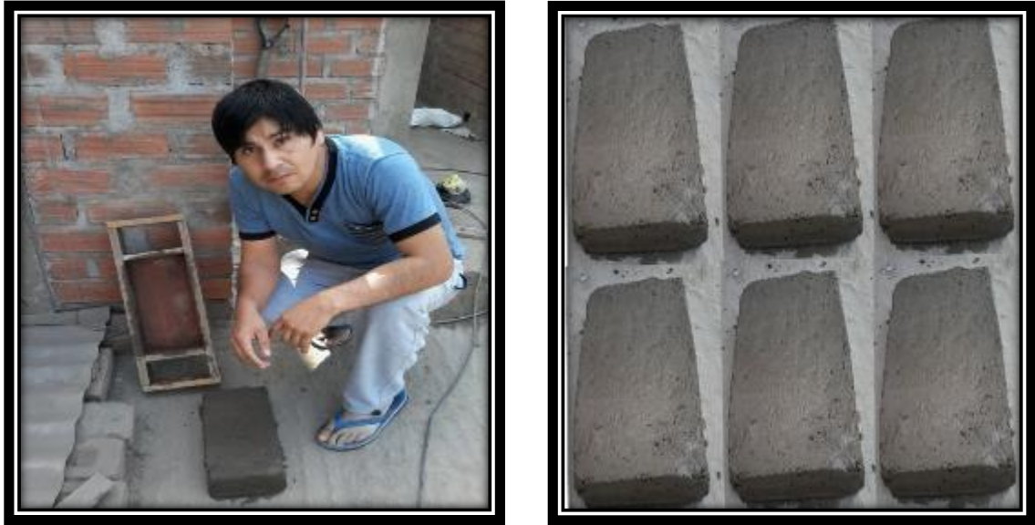
FIG. 15. Proceso de elaboración del adobe estabilizado
