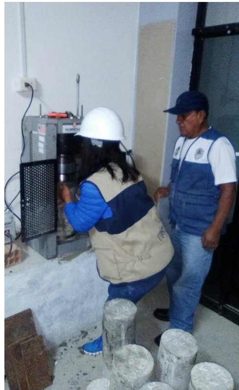
FOTOGRAFÍA 06: Preparación y colocación de las testigos para las roturas correspondientes con la prensa hidráulica
