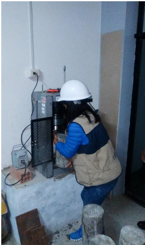
FOTOGRAFÍA 06: Preparación y colocación de las testigos para las roturas correspondientes con la prensa hidráulica
