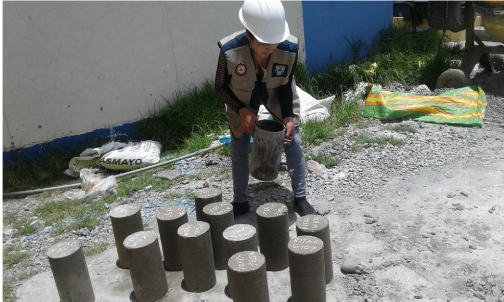
FOTOGRAFÍA 05: Desencofrando las probetas
