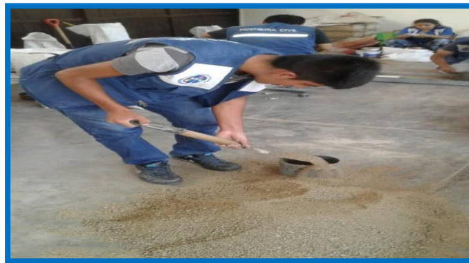
FIGURA N°15: LA ARENA SE DEJA CAER A CIERTA ALTURA SIN COMPACTAR, ENRASANDO Y PESANDO LA MUESTRA (PAG. 27)
