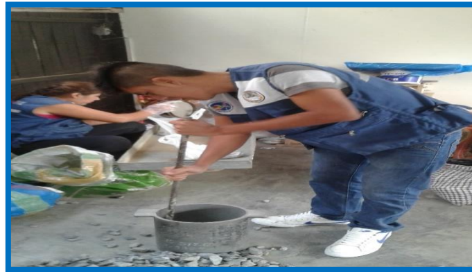
FIGURA N°26: LA PIEDRA SE DEJA CAER A CIERTA ALTURA COMPACTANDO Y CHUCEANDO EN TRES CAPAS IGUALES, ENRASANDO Y PESANDO LA MUESTRA (PAG. 27)
