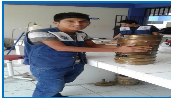
FIGURA N°23: DEL CUARTEO REALIZADO SE TOMA UNA MUESTRA DE ARENA Y SE PASA A REALIZAR LA GRANULOMETRÍA, TOMANDO LOS PESOS RETENIDOS EN CADA MALLA (PAG. 27)
