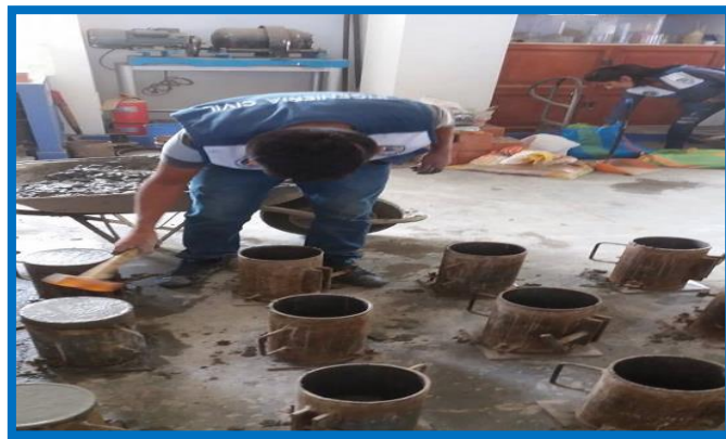
FIGURA N°37 – N°38: VACEADO Y CHUCEADO DE PROBETAS PATRONES (PAG. 27)
