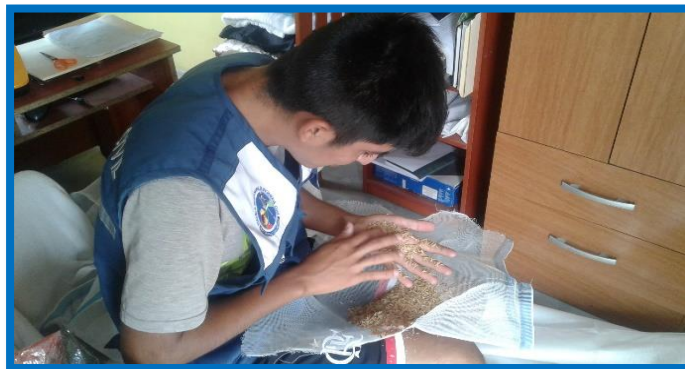
FIGURA N°10: LIMPIEZA DE LA CASCARA DE ARROZ (PAG. 26)
