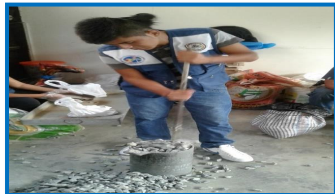
FIGURA N°27: LA PIEDRA SE DEJA CAER A CIERTA ALTURA COMPACTANDO Y CHUCEANDO EN TRES CAPAS IGUALES, ENRASANDO Y PESANDO LA MUESTRA (PAG. 27)
