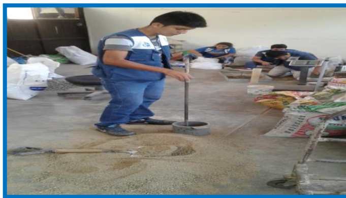
FIGURA N°16 – N°17: LA ARENA SE DEJA CAER A CIERTA ALTURA COMPACTANDO Y CHUCEANDO EN TRES CAPAS IGUALES, ENRASANDO Y PESANDO LA MUESTRA (PAG. 27)
