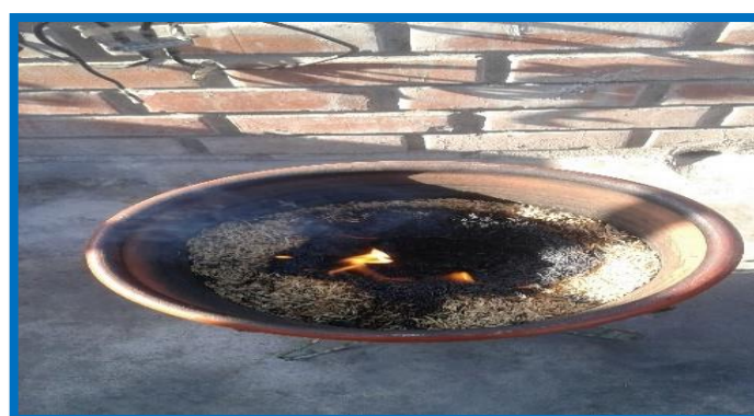
FIGURA N°12: CASCARA DE ARROZ INICIANDO EL PRE-QUEMADO (PAG. 26)
