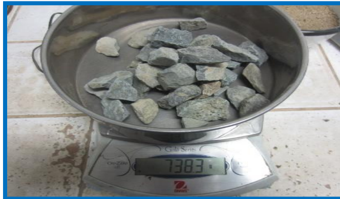
FIGURA N°30 – N°31: DEL CUARTEO REALIZADO SE TOMA UNA MUESTRA DE PIEDRA Y SE PASA A REALIZAR LA GRANULOMETRÍA, TOMANDO LOS PESOS RETENIDOS EN CADA MALLA (PAG. 27)
