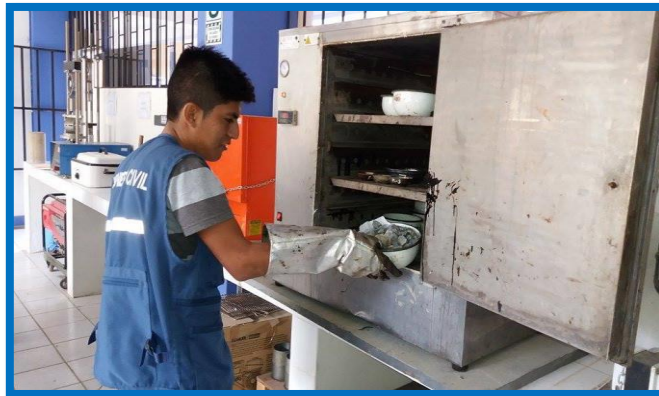
FIGURA N°29: LA PIEDRA ES LLEVADA AL HORNO PARA SU SECADO (PAG. 27)
