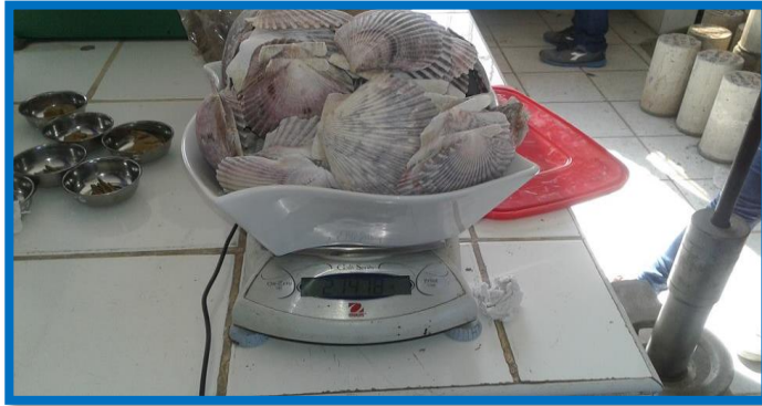
FIGURA N°7: MUESTRA ANTES DE CALCINAR (PAG. 26)
