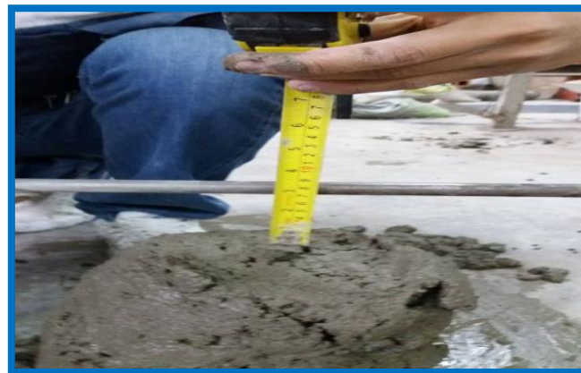
FIGURA N°46 – N°47: ELABORACIÓN DEL SLUMP PARA LA MEZCLA EXPERIMENTAL (PAG. 27)
