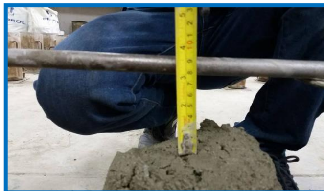
FIGURA N°36: ELABORACIÓN DEL SLUMP PARA LA MEZCLA PATRÓN (PAG. 27)
