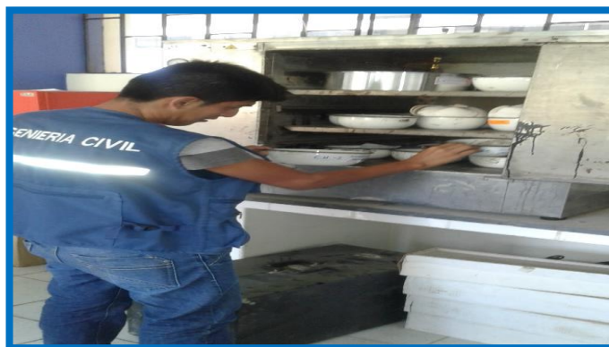
FIGURA N°18 – N°19: SE PASA A REALIZAR EL CUARTEO DEL MATERIAL, PESADO Y POSTERIORMENTE TOMAR LAS MUESTRAS PARA LLEVARLAS AL HORNO (PAG. 27)
