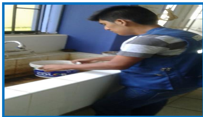
FIGURA N°20: SE PASA HACER EL LAVADO DE LA ARENA (PAG. 27)
