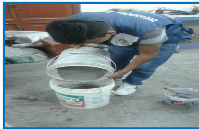
FIGURA N°43 – N°44: COMBINACIÓN DE CEMENTO CON EL POLVO DE LA CONCHA DE ABANICO Y LAS CENIZAS DE CASCARA DE ARROZ (PAG. 27)
