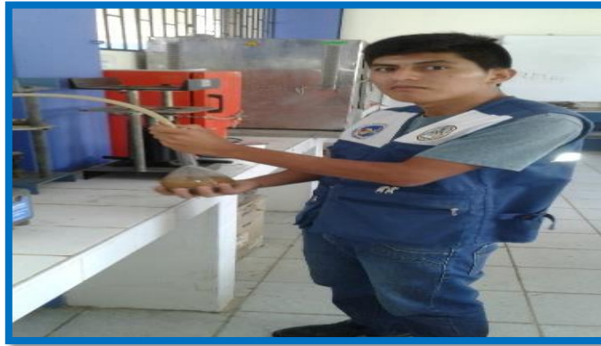
FIGURA N°21 – N°22: LUEGO SE PASA A SECAR LA ARENA Y POSTERIORMENTE REALIZAR LOS ENSAYOS CON LA FIOLA Y TOMAR SU PESO (PAG. 27)
