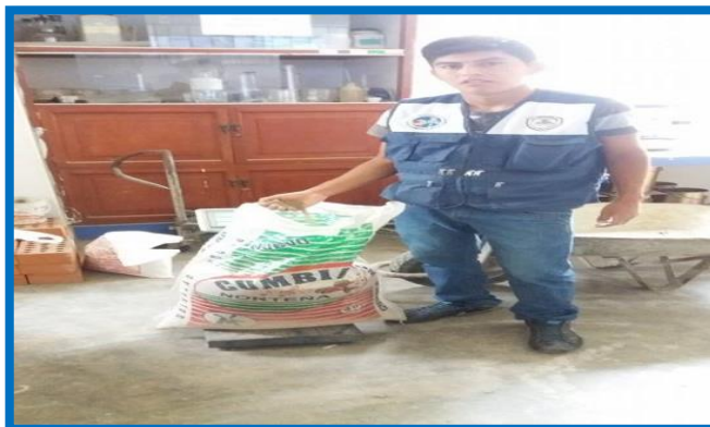
FIGURA N°32: PESADO DE AGREGADOS GRUESO (PAG. 27)
