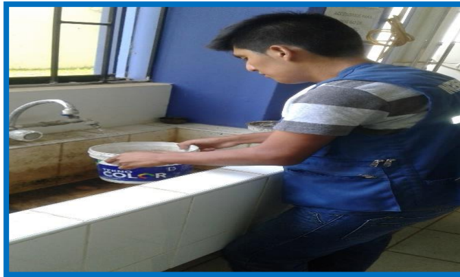
FIGURA N°28: LA PIEDRA ES LAVADA Y SECADA (PAG. 27)
