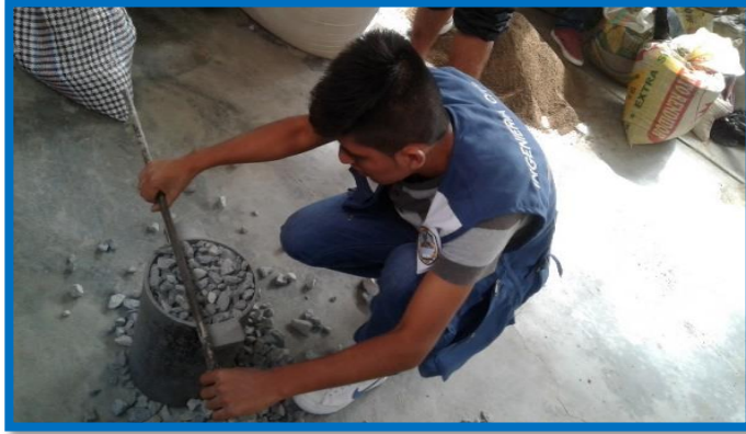
FIGURA N°24 – N°25: LA PIEDRA SE DEJA CAER A CIERTA ALTURA SIN COMPACTAR, ENRASANDO Y PESANDO LA MUESTRA (PAG. 27)
