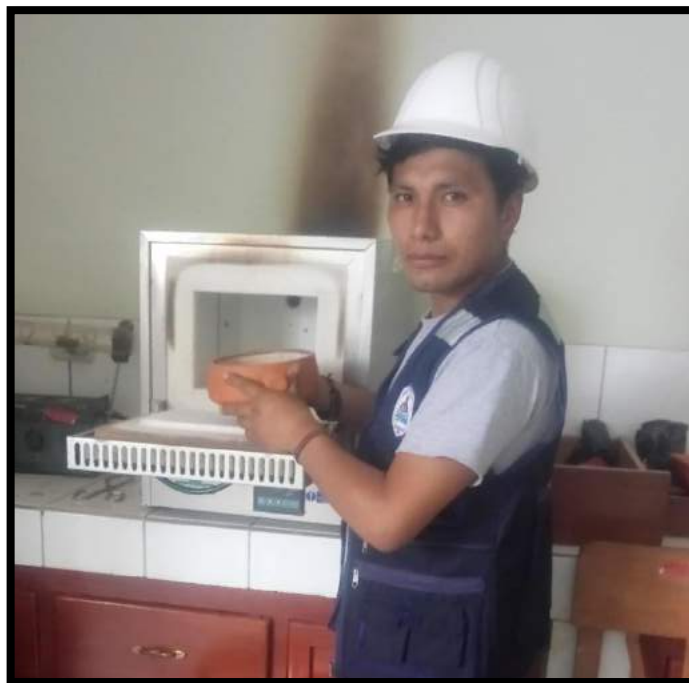
Foto 8: Metiendo la mufla con la viruta de madera tornillo al horno.
