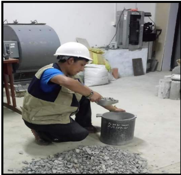
Foto 17: Llenado de la piedra chancada al molde suelto
