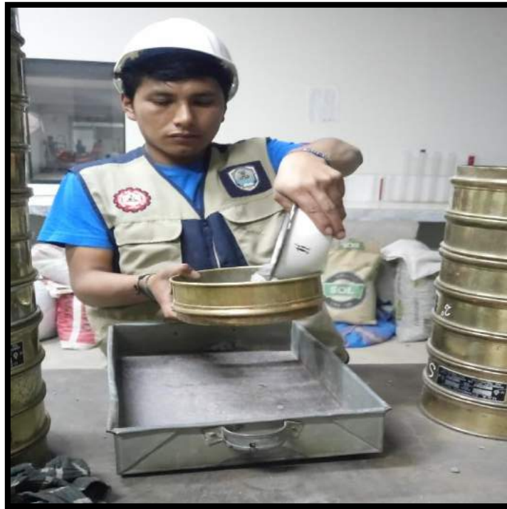
Foto 13: Tamizado de la piedra chancada
