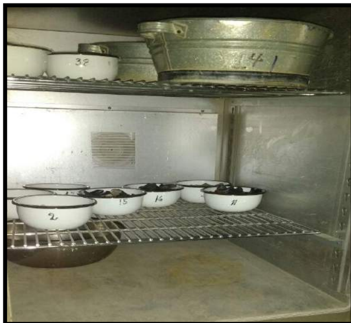
Foto 16: Secado de los agregados en el horno
