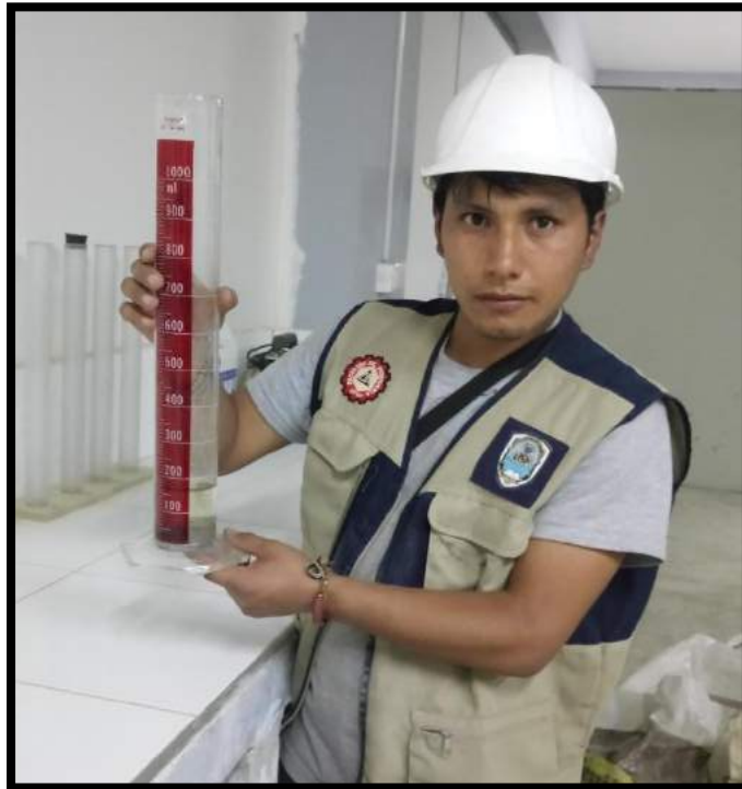
Foto 19: Peso específico de la ceniza de viruta de madera tornillo.
