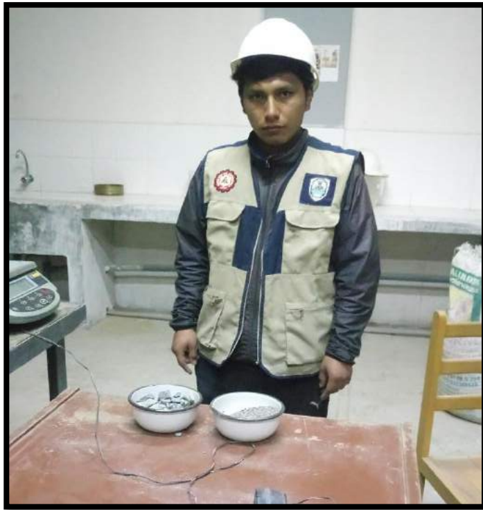
Foto 11: Muestra de los agregados en cada tara para ser metidos al horno
