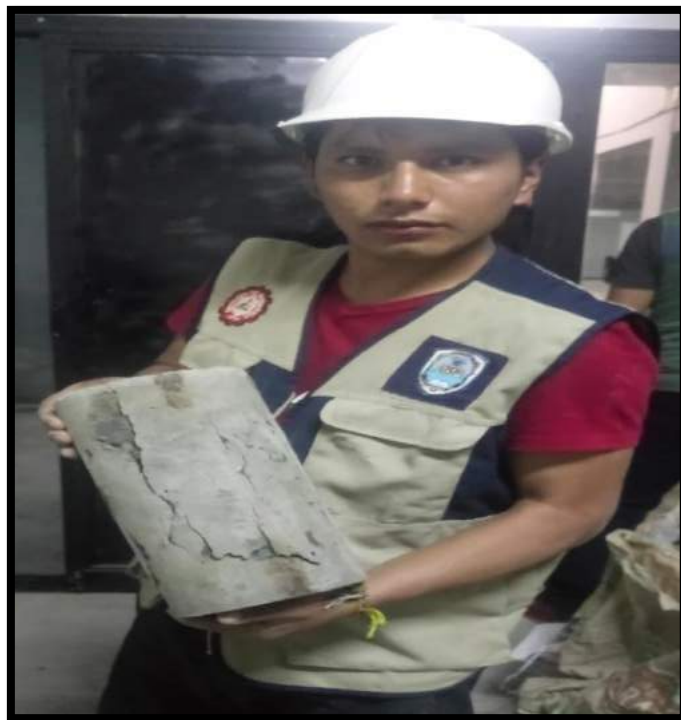
Foto 24: Probeta ya sacada de la máquina de compresión a los 7 días
