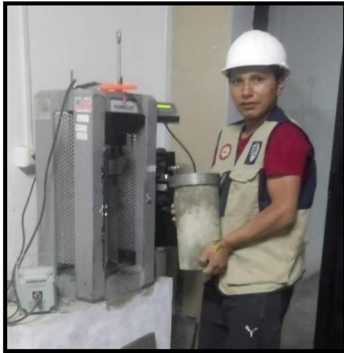
Foto 23: Rotura de las probetas a los 7 días
