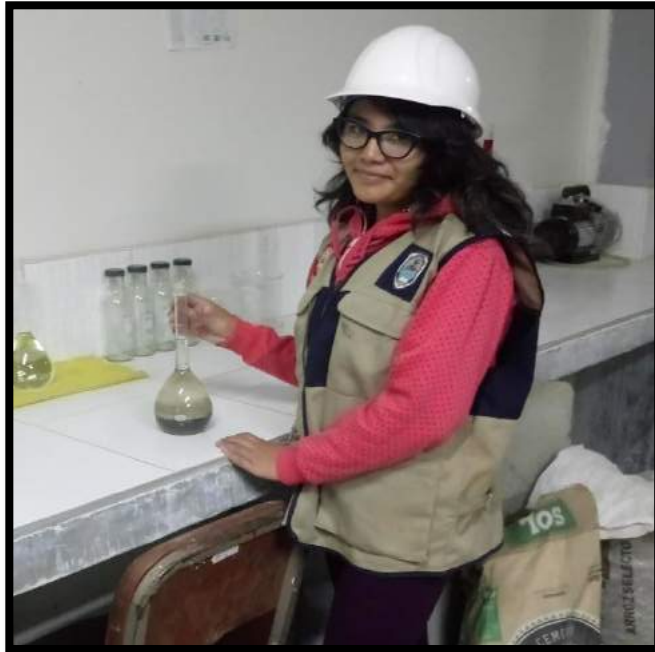
Foto 11: El agregado fino ya introducido en la viola.
