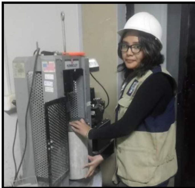
Foto 18: Rotura de las probetas a los 7 días de curado.
