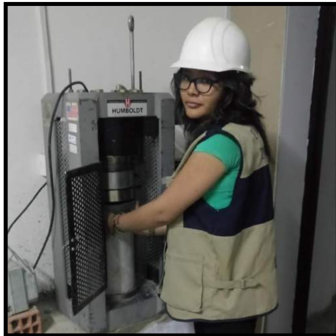
Foto 20: Rotura de las probetas a los 14 días.
