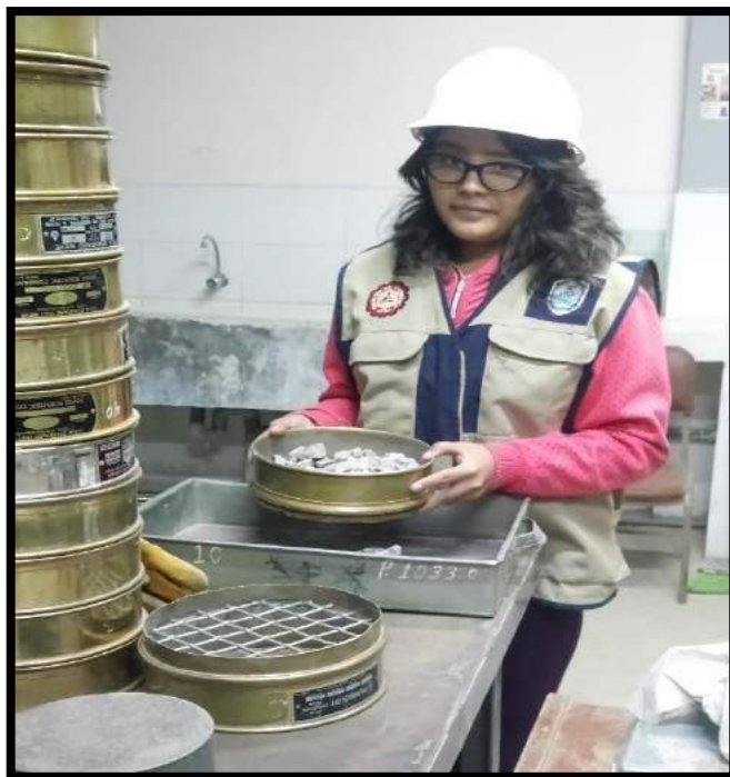
Foto 10: Tamizado del agregado reciclado.
