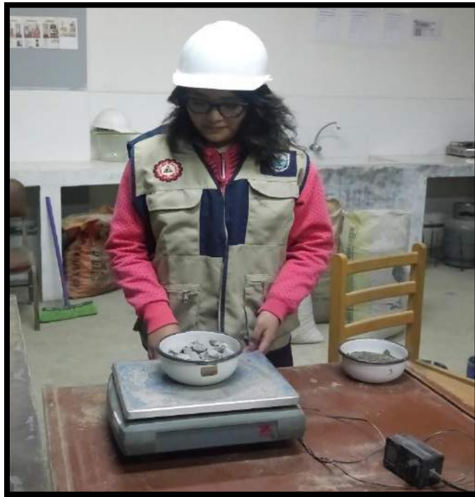
Foto 6: Pesado del agregado grueso para hallar el contenido de humedad.
