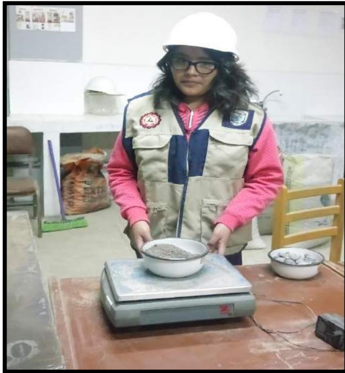
Foto 7: Pesado del agregado fino para hallar el contenido de humedad.
