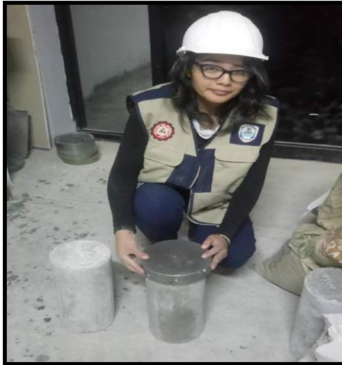
Foto 19: Alistando una de las probetas para ponerlo en la máquina de compresión.
