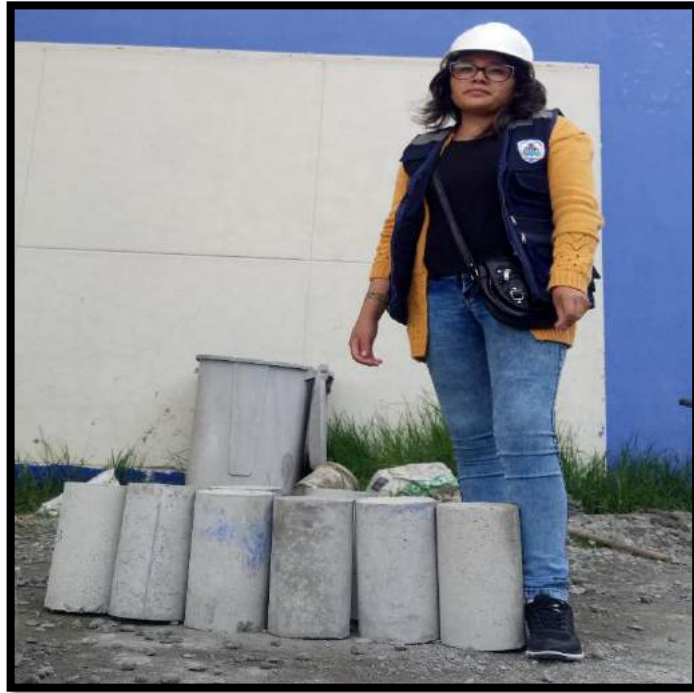
Foto 17: Desencofrado de probetas
