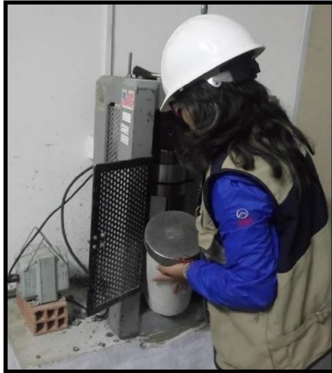
Foto 23: Rotura de las probetas a los 28 días.
