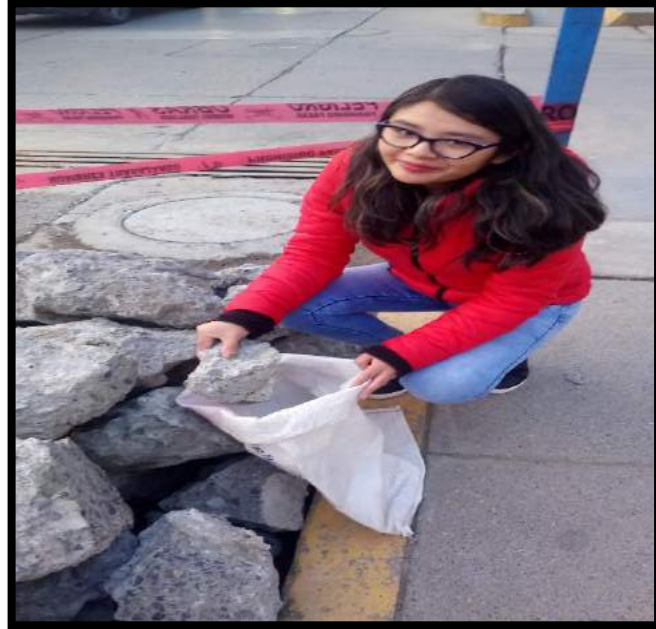
Foto 1: Recolección del agregado reciclado de una pista.
