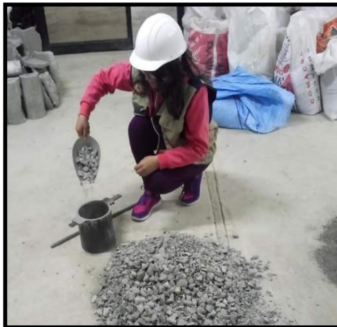
Foto 14: llenado del molde con agregado grueso para hallar el peso suelto
