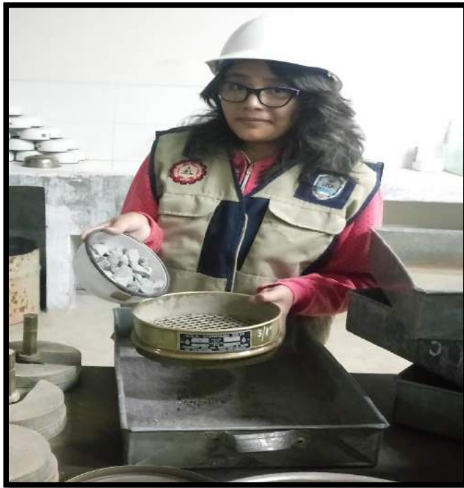
Foto 9: Tamizado del agregado grueso.
