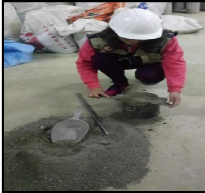
Foto 13: Nivelado de la arena con el molde para ser pesado
