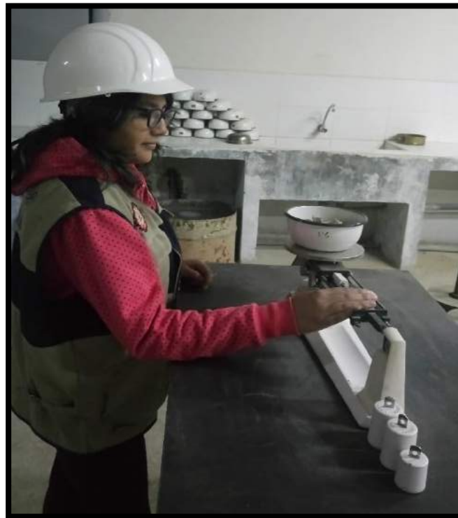
Foto 12: Pesado del agregado grueso para hallar la gravedad específica
