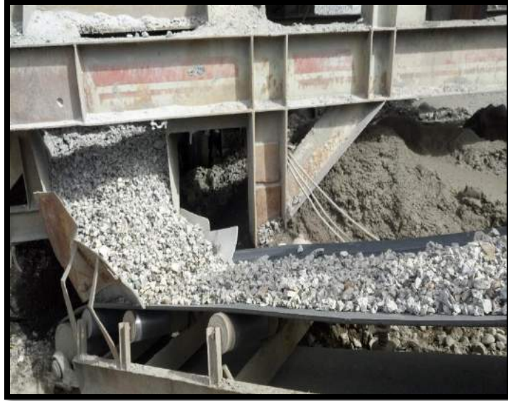
Foto 3: Agregado reciclado ya convertido en piedra chancada.
