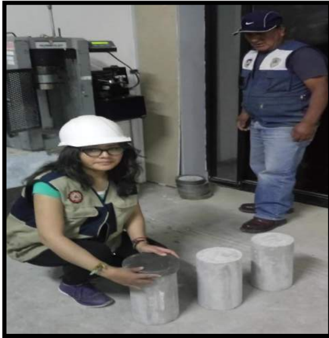
Foto 21: Rotura de las probetas a los 14 días.
