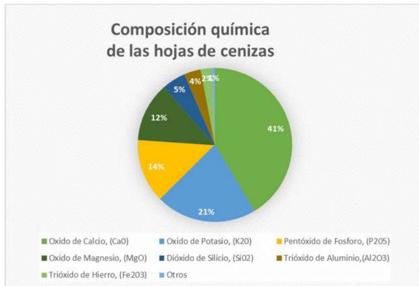
Figura 10: Espectrometría de Fluorescencia de Rayos X. Fuente: Resultados de composición química de las cenizas hoja de pino realizados en la Universidad Nacional de Ingeniería.
