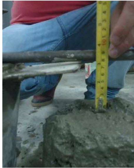
Fotografía N° 54: Slump de la combinación
