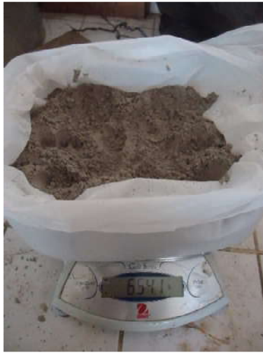
Fotografía N° 52: Peso de la cenizas
